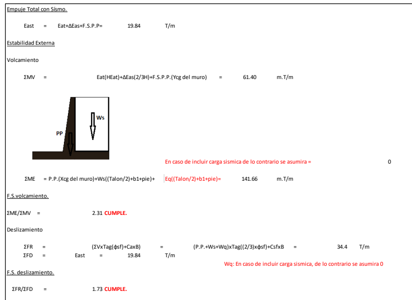
Gráfico 25. Verificación por volteo y deslizamiento
