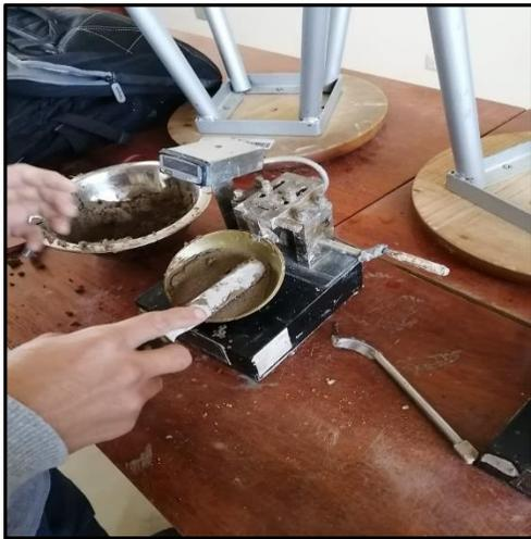
**Figura 24.** Colocación de la muestra en la copa de Casagrande
