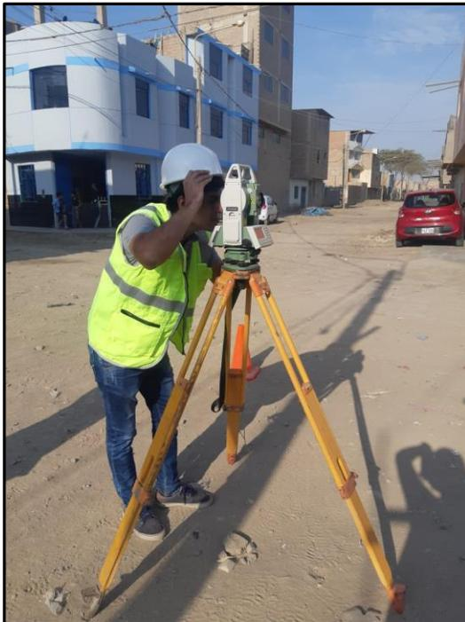
**Figura 19.** Levantamiento topográfico con estación total
