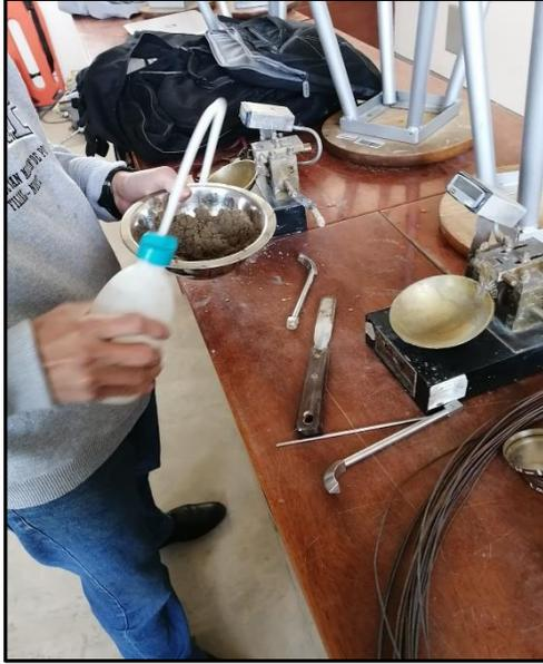
**Figura 23.** Colocación de agua destilada a la muestra
