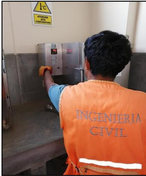
**Figura 27.** Colocación de la muestra al horno
