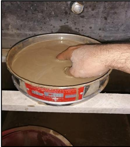
**Figura 28.** Lavado de la muestra por el tamiz N° 200
