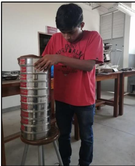
**Figura 29.** Tamizado de la muestra
