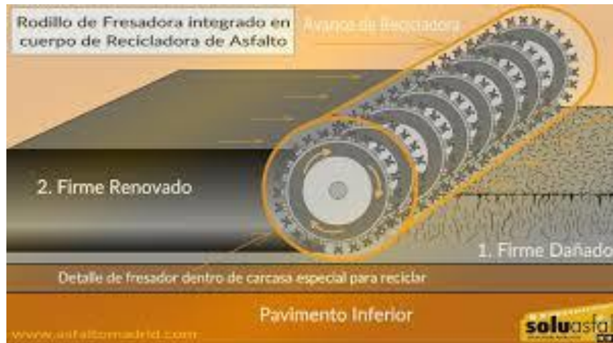
Figura 5. Proceso de reciclado del pavimento Fuente: Amaya y Rojas (2017)
