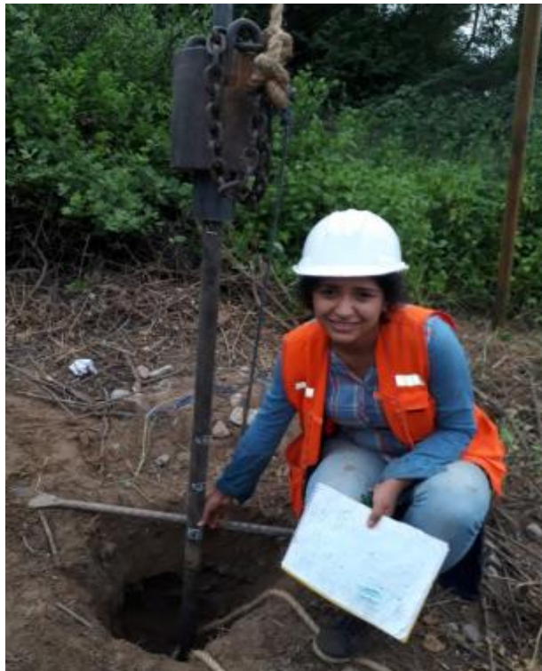
Figura 65: Rebote a 5.05m SPT 2 Fuente: Propia
