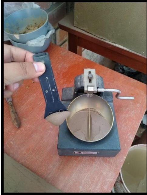
Figura 52: Ranurado de la muestra a ensayar
