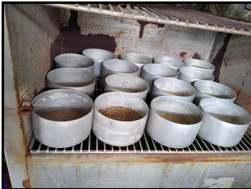
Figura 38: Secado de muestra en horno
