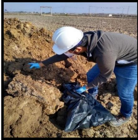
Figura 31: Muestreando los estratos
