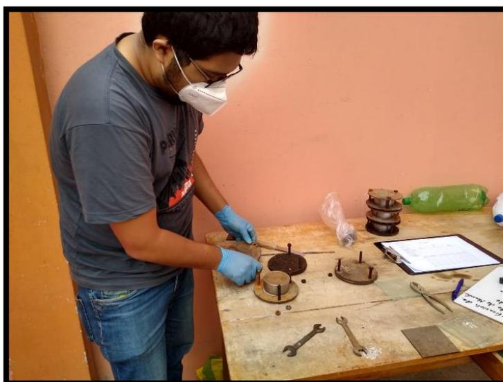
Figura 72: Preparación de muestra a sumergir
