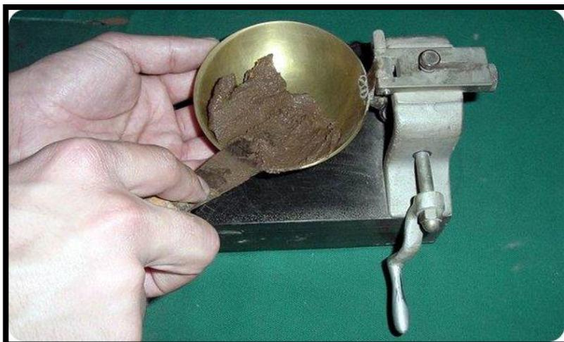
Figura 15: Ensayo de Límite Líquido
