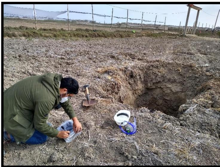
Figura 68: Embalado y etiquetado de la muestra
