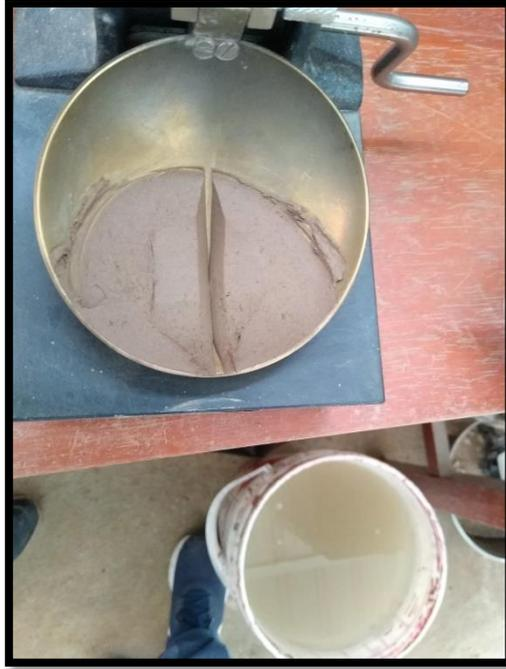
Figura 54: Unión de la muestra luego de los golpes
