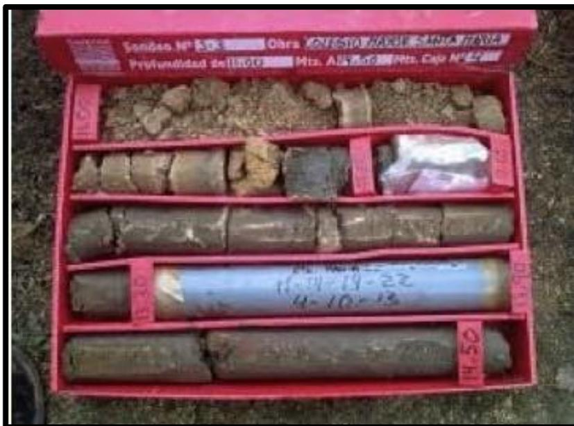
Figura 10: Muestras recolectadas del sondeo
