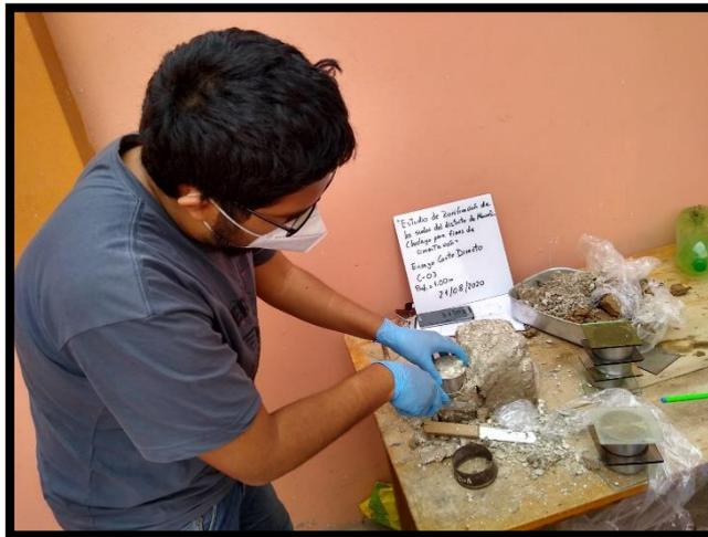
Figura 70: Tallado de muestra para ensayo del Corte Directo
