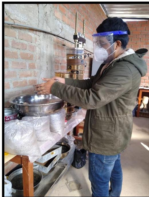
Figura 40: Separación de tamices
