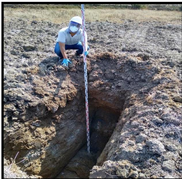
Figura 29: Verificación de la profundidad de las calicatas
