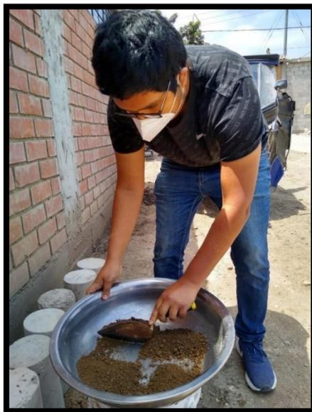
Figura 36: Cuarteo de muestra para granulometría
