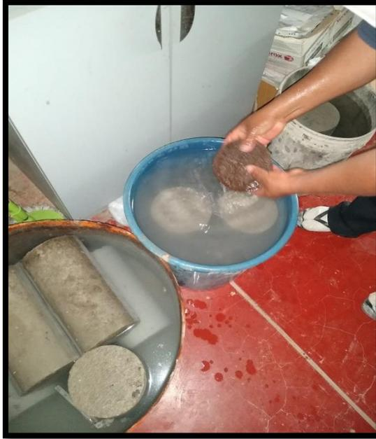
Figura 73: Muestras sumergidas
