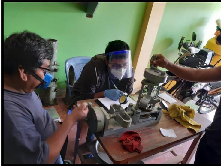
Figura 77: Elaboración del Ensayo de Corte Directo
