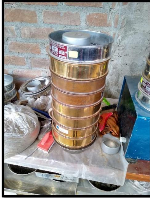
Figura 14: Ensayo de Granulometría
