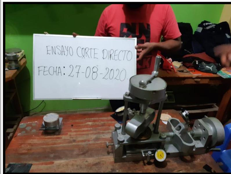
Figura 75: Armado de Equipo de Corte Directo
