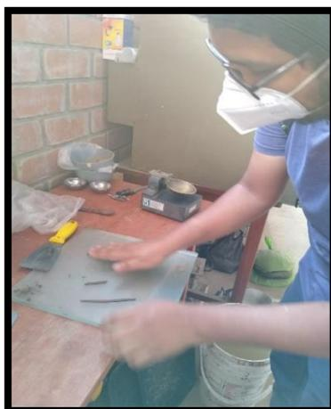
Figura 60: Enrollado de la muestra
