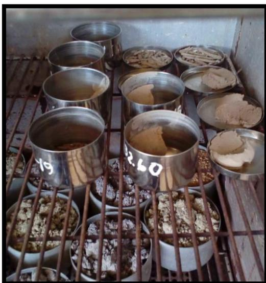
Figura 62: Colocación de muestra al horno
