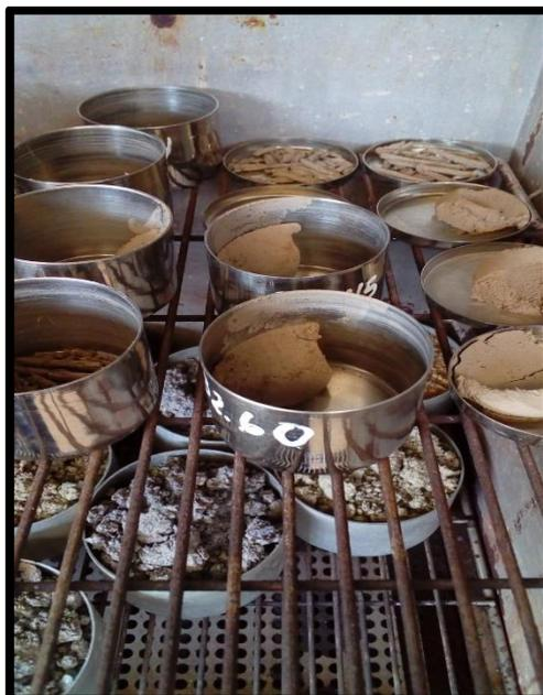
Figura 57: Secado de la muestra
