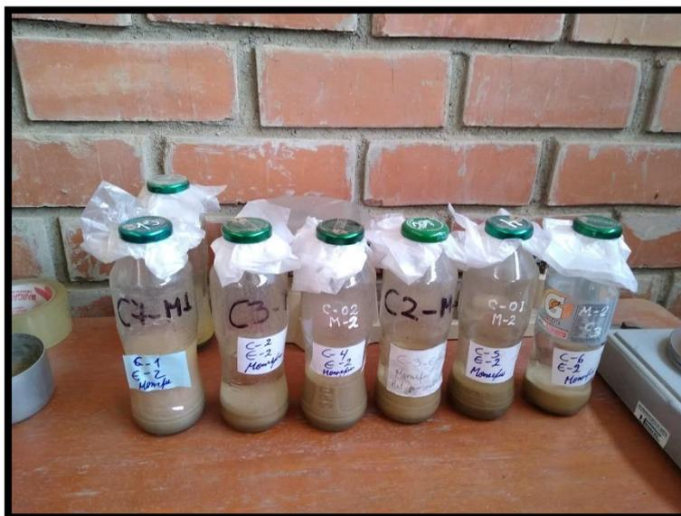
Figura 87: Muestras mezcladas con agua destilada
