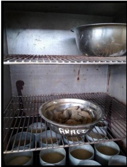
Figura 34: Secado de la muestra
