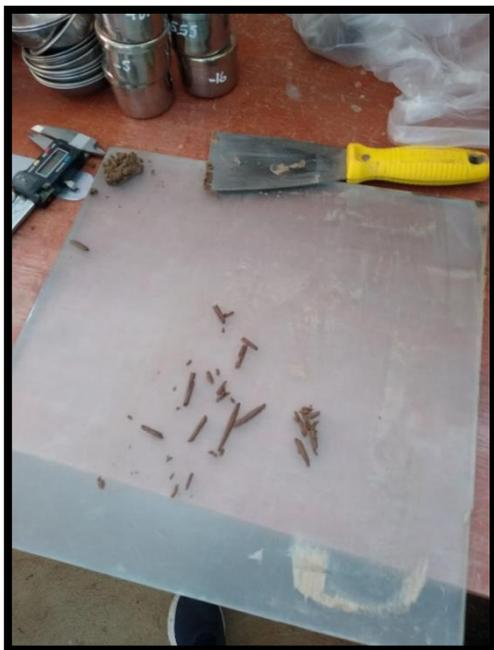
Figura 61: Culminación del procedimiento de enrollado
