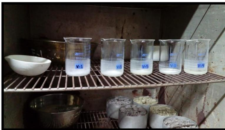
Figura 90: Secado de la solución filtrada
