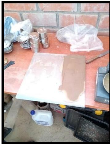
Figura 59: Capa de muestra para ensayo de Límite Plástico
