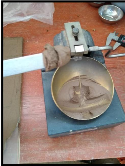
Figura 56: Toma de muestra del ensayo de Casagrande
