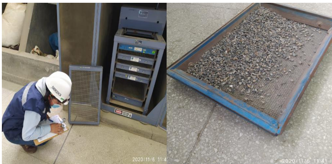
Figura 49. Tamizado del agregado grueso en la zaranda vibratoria Fuente: Elaboración propia
