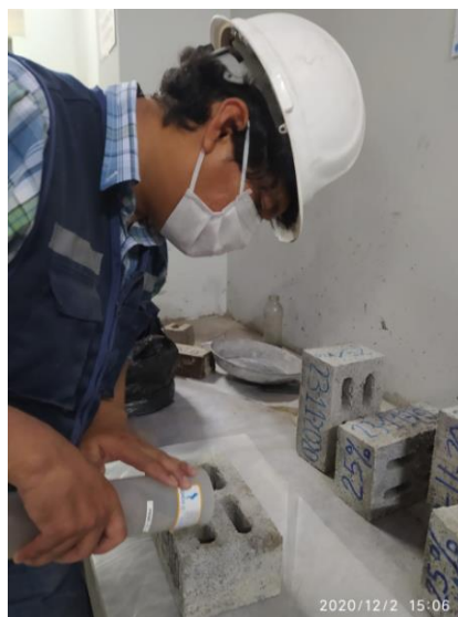
Figura 24. Llenar los alvéolos de arena Fuente: Elaboración propia
