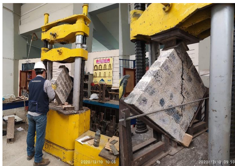
Figura 125. Ensayo de murete de ladrillo de concreto Fuente: Elaboración propia
