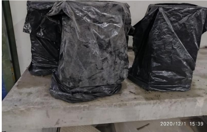
Figura 116. Cubierta de prismas de ladrillo de concreto con 25 % de vidrio crudo molido Fuente: Elaboración propia
