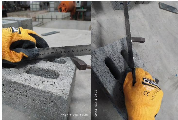
Figura 166. Medición de convexidad del ladrillo de concreto Fuente: Elaboración propia
