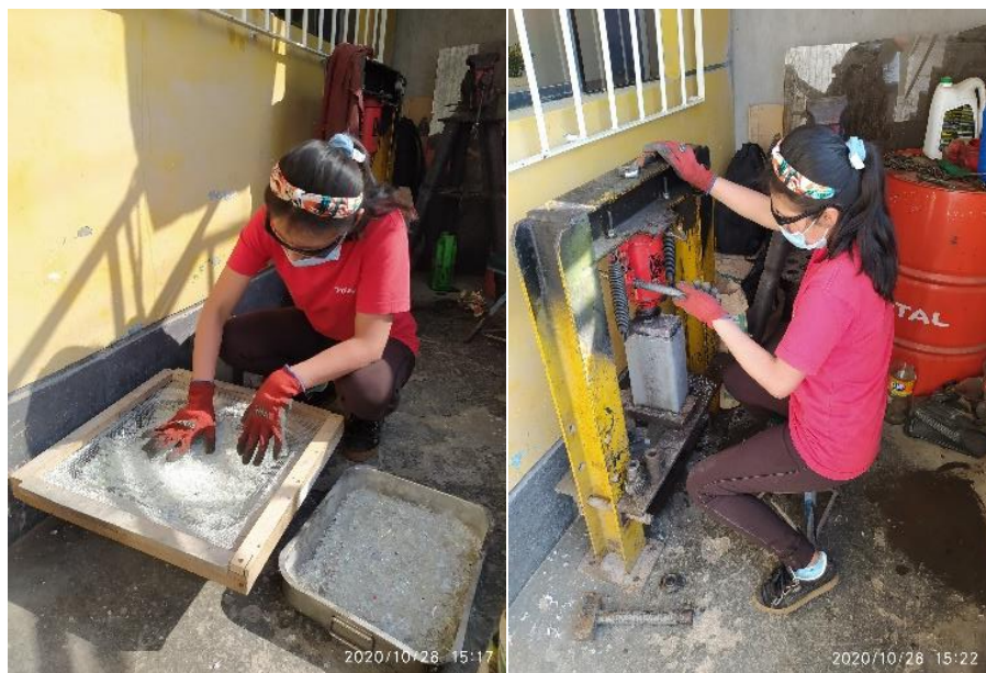
Figura 46. Trituración del vidrio con prensa Fuente: Elaboración propia
