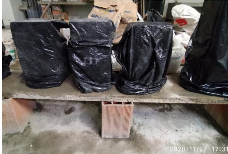
Figura 111. Cubierta de prismas de ladrillo de concreto con 10 % de vidrio crudo molido Fuente: Elaboración propia
