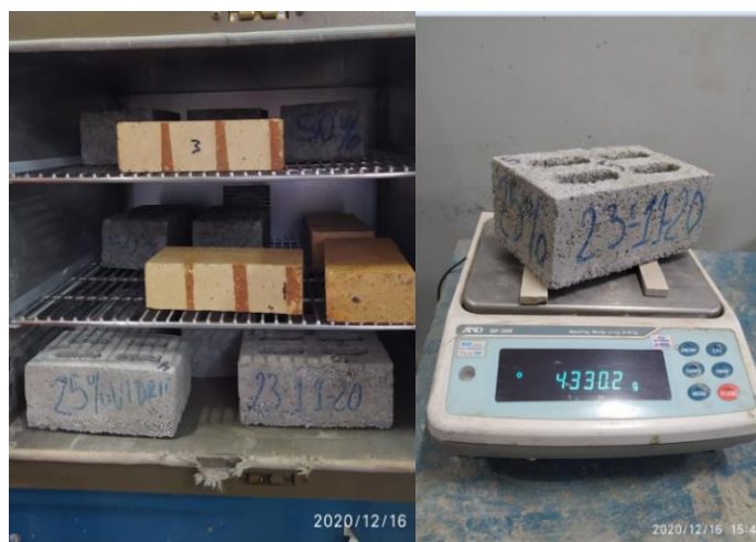
Figura 159. Secado al horno y registro de peso de ladrillo de concreto con 25 % vidrio crudo molido Fuente: Elaboración propia
