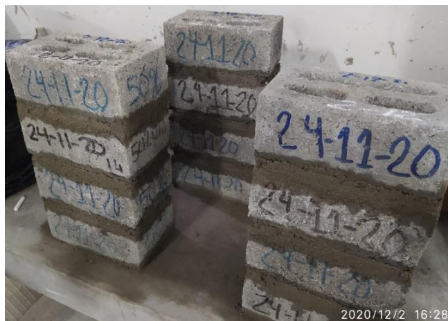
Figura 43. Elaboración de tres unidades de prisma con ladrillos 50 % vidrio Fuente: Elaboración propia
