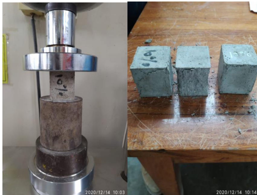
Figura 98. Ensayo a compresión de mortero en la elaboración de prisma y mortero con ladrillo de concreto con 10 % vidrio Fuente: Elaboración propia
