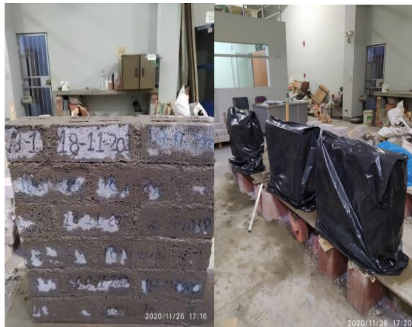
Figura 127. Elaboración y cubierta de muretes con ladrillo de concreto patrón Fuente: Elaboración propia
