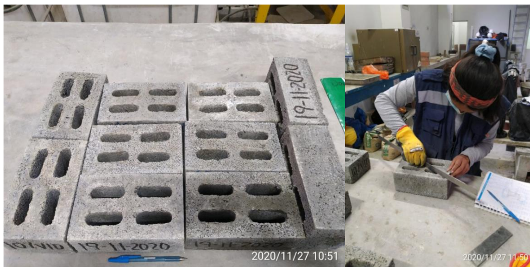
Figura 168. Muestra y medición de concavidad y convexidad de ladrillo de concreto con 10 % vidrio crudo molido Fuente: Elaboración propia
