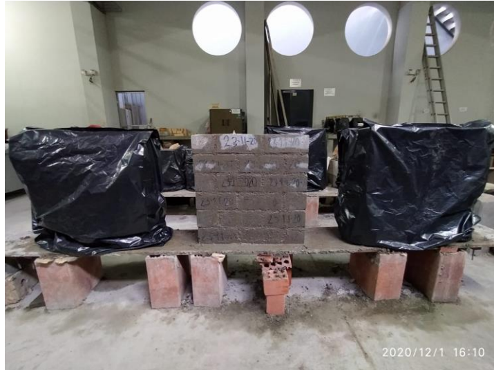
Figura 136. Elaboración y cubierta de muretes con ladrillo de concreto con 25 % vidrio crudo molido Fuente: Elaboración propia
