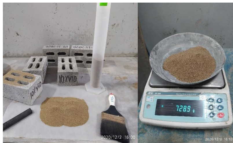
Figura 180. Pesado de la arena contenida en los alvéolos del ladrillo de concreto con 10 % vidrio crudo molido Fuente: Elaboración propia
