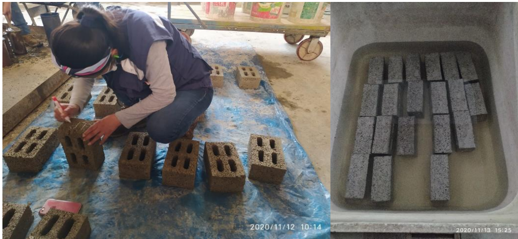
Figura 68. Rotulado y curado de los tres diferentes diseños de mezcla f'c=180\text{kg/cm}^3 Fuente: Elaboración propia
