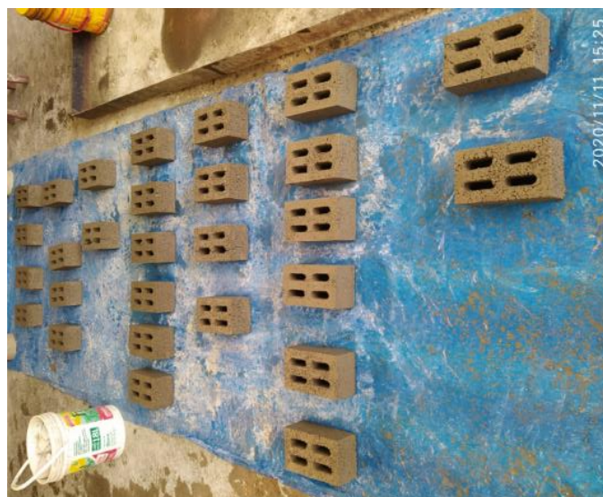
Figura 67. Tres diferentes diseños de mezcla f'c = 180 \text{ kg/cm}^3 Fuente: Elaboración propia
