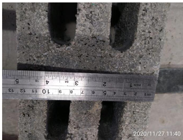
Figura 20. El orificio está a más 19,1 mm del borde de ladrillo Fuente: Elaboración propia
