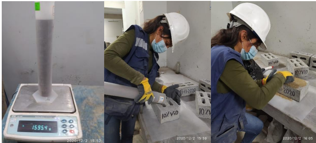
Figura 179. Peso de la probeta con arena, llenado de los alveolos y enrasado del ladrillo de concreto con 10 % vidrio crudo molido Fuente: Elaboración propia
