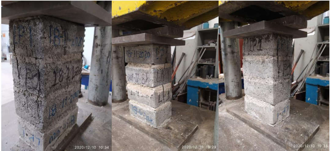
Figura 109. Fallas de prismas del ladrillo de concreto patrón Fuente: Elaboración propia
