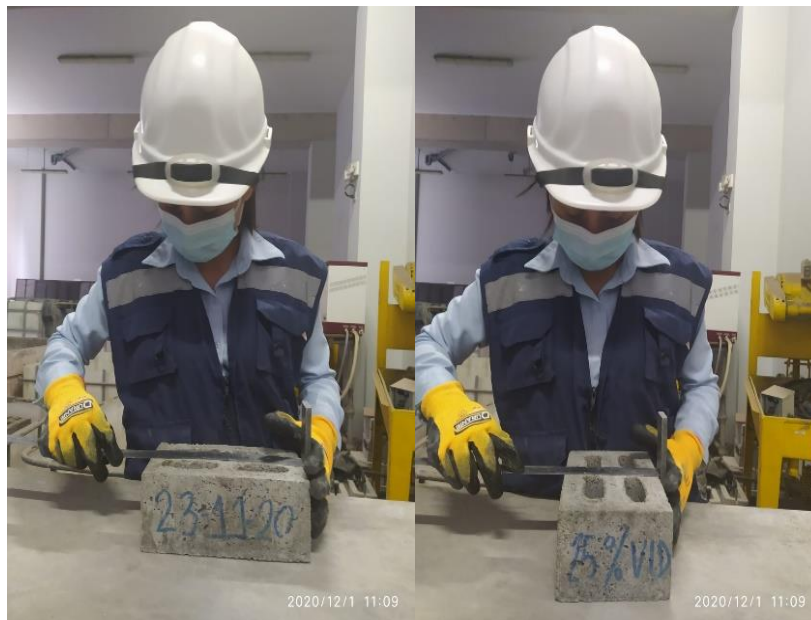
Figura 175. Medición de las dimensiones del ladrillo de concreto con 25 % de adición de vidrio crudo Fuente: Elaboración propia
