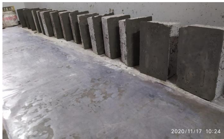
Figura 30. Refrentado en unidad de albañilería Fuente: Elaboración propia
