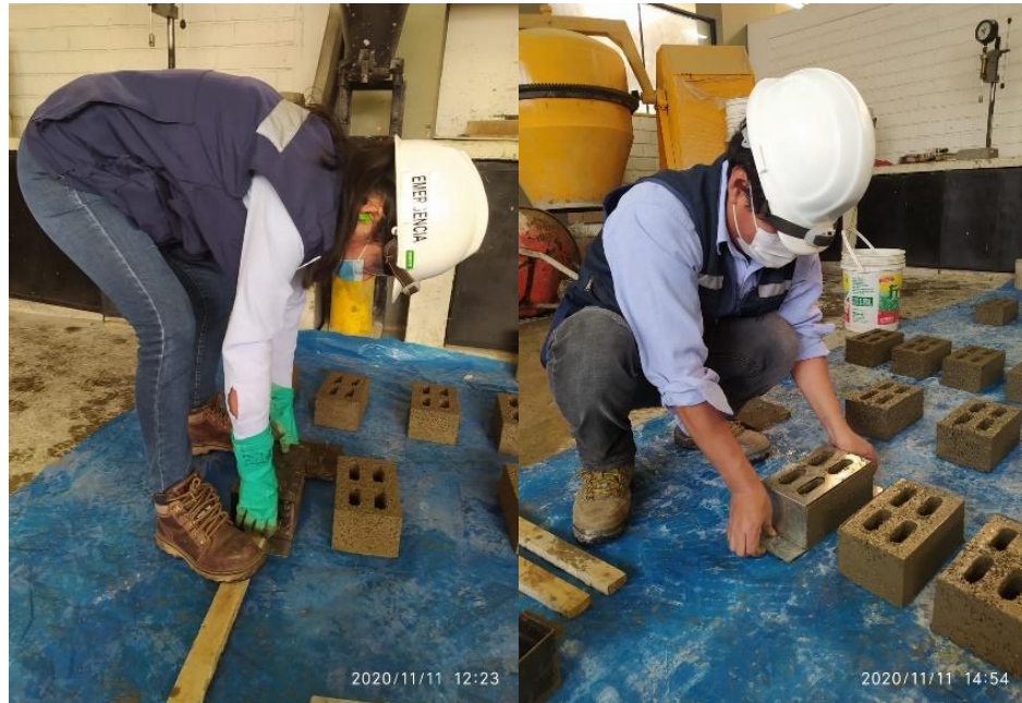
Figura 66. Desmolde de los ladrillos de concreto Fuente: Elaboración propia
