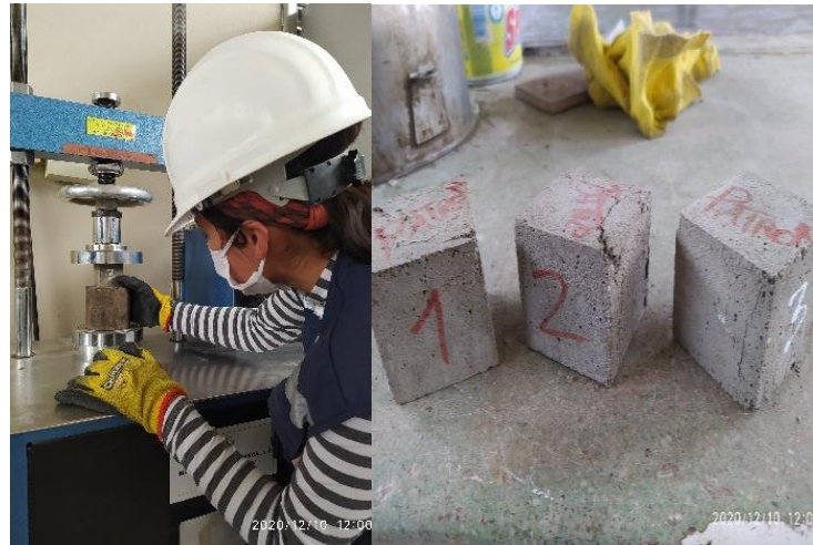
Figura 97. Ensayo a compresión de mortero en la elaboración de prisma y mortero con ladrillo de concreto patrón Fuente: Elaboración propia
