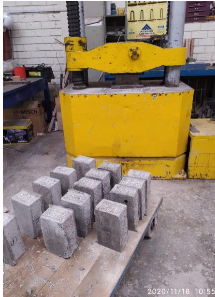
Figura 25. Ensayo de compresión del ladrillo Fuente: Elaboración propia
