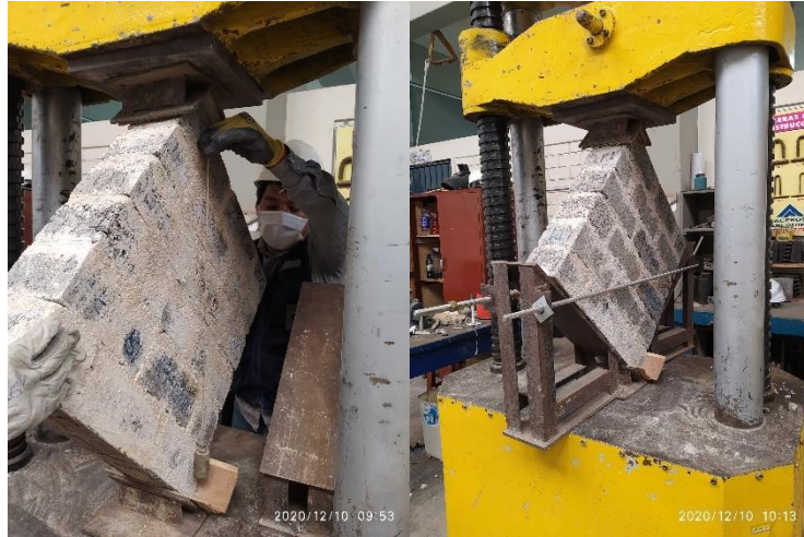
Figura 128. Plomeado del vértice al eje del soporte base del ladrillo de concreto patrón Fuente: Elaboración propia
