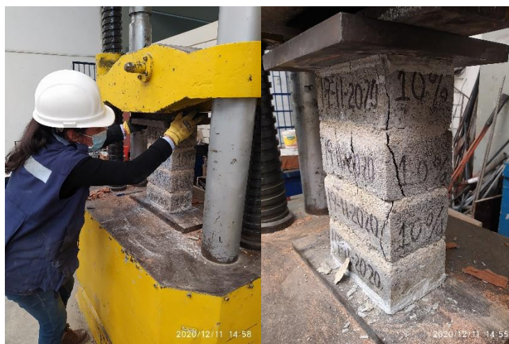
Figura 113. Ensayo de compresión del prisma de ladrillo de concreto con 10 % de vidrio crudo molido Fuente: Elaboración propia
