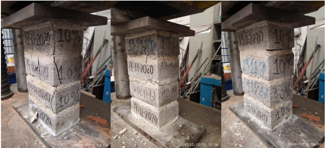
Figura 114. Fallas de prismas de ladrillo de concreto con 10 % de vidrio crudo molido Fuente: Elaboración propia
