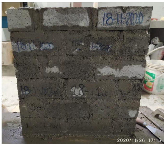
Figura 29. Murete culminado Fuente: Elaboración propia
