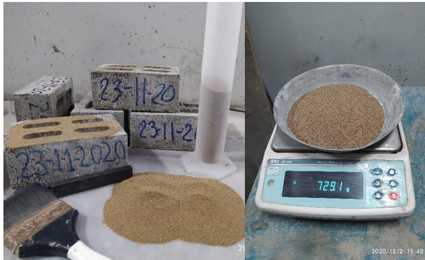
Figura 182. Pesado de la arena contenida en los alvéolos del ladrillo de concreto con 25 % vidrio crudo molido Fuente: Elaboración propia
