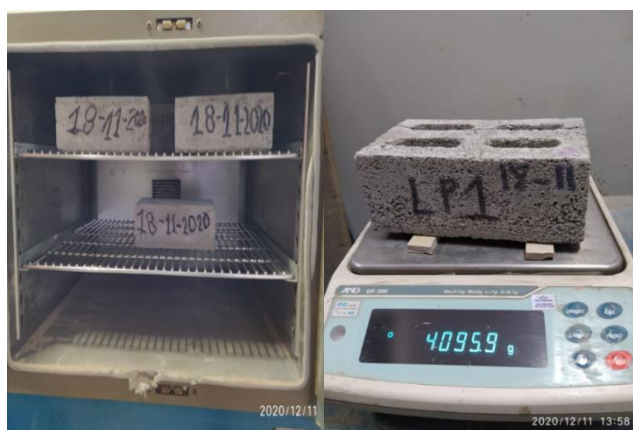
Figura 153. Secado al horno y registro de peso de ladrillo de concreto patrón Fuente: Elaboración propia
