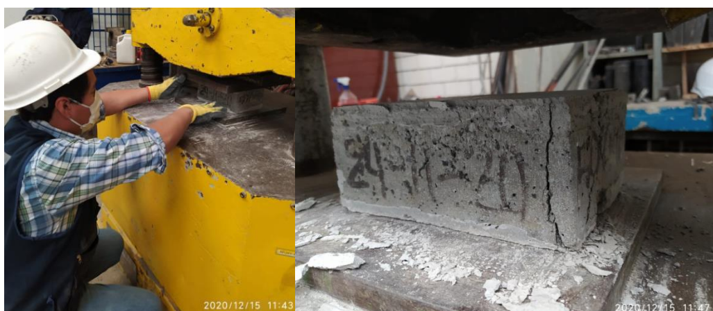
Figura 90. Ensayo de compresión en ladrillos con 50 % vidrio crudo molido Fuente: Elaboración propia
