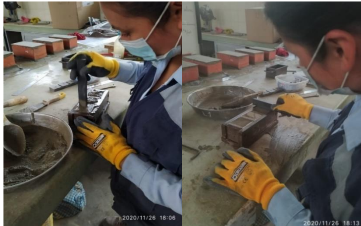
Figura 93. Elaboración de cubos de mortero de prisma y murete con ladrillo de concreto patrón Fuente: Elaboración propia
