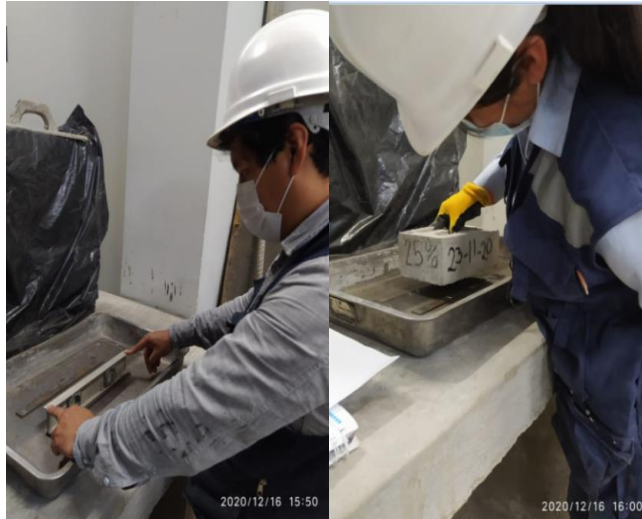
Figura 160. Verificación de barras de acero y sumergir en agua el ladrillo de concreto con 25 % vidrio crudo molido Fuente: Elaboración propia
