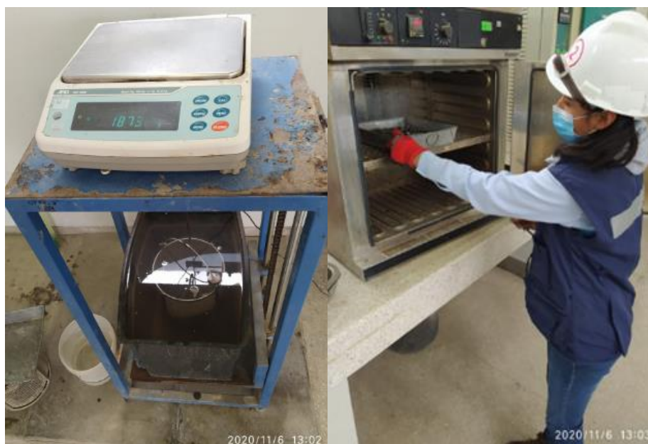
Figura 63. Pesado del agregado grueso y colocado al horno Fuente: Elaboración propia
