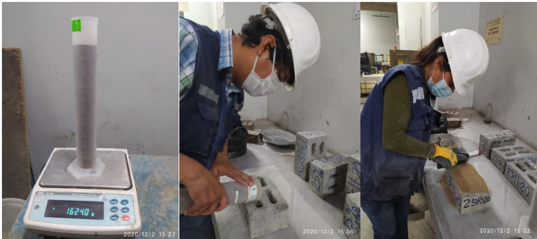
Figura 181. Peso de la probeta con arena, llenado de los alveolos y enrasado del ladrillo de concreto con 25 % vidrio crudo molido
