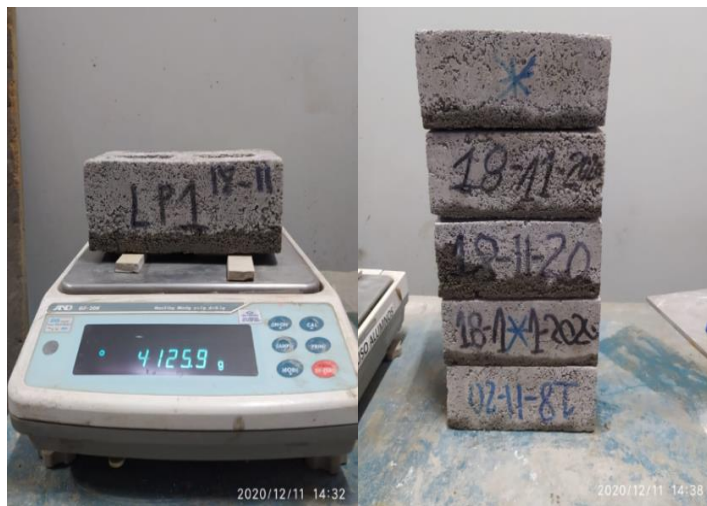
Figura 155. Pesado y muestra de ladrillo de concreto patrón Fuente: Elaboración propia
