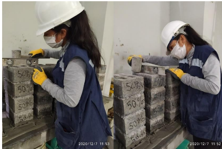
Figura 103. Verificación de nivel del refrentado del prisma de ladrillo de concreto Fuente: Elaboración propia
