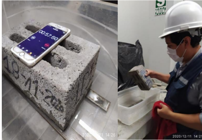
Figura 154. Inmersión en agua, retiro y secado superficial de ladrillo de concreto patrón Fuente: Elaboración propia
