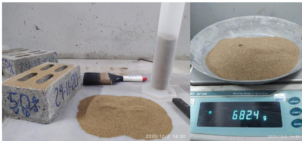
Figura 184. Pesado de la arena contenida en los alvéolos del ladrillo de concreto con 50 % vidrio crudo molido Fuente: Elaboración propia
