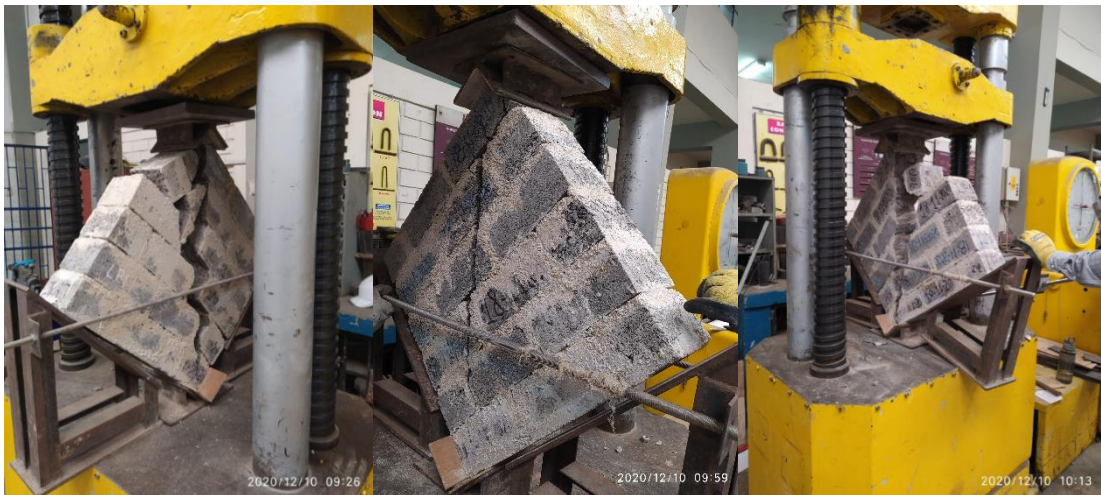
Figura 129. Ensayo de murete de ladrillo de concreto patrón Fuente: Elaboración propia
