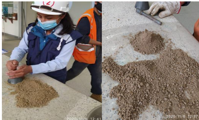
Figura 59. Colocación del agregado fino en el cono y estado S.S.S de la muestra Fuente: Elaboración propia
