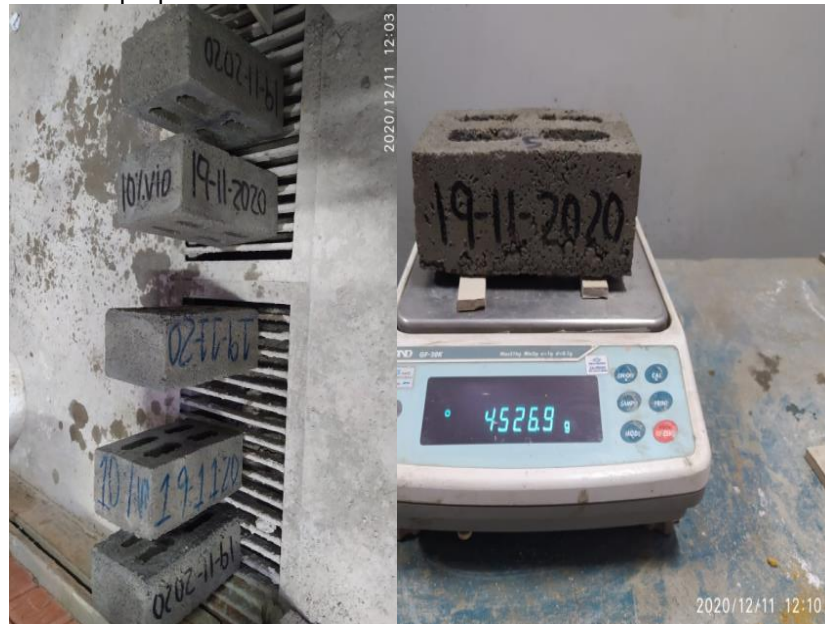
Figura 145. Drenado y registro de peso de ladrillo de concreto con 10 % vidrio crudo molido Fuente: Elaboración propia
