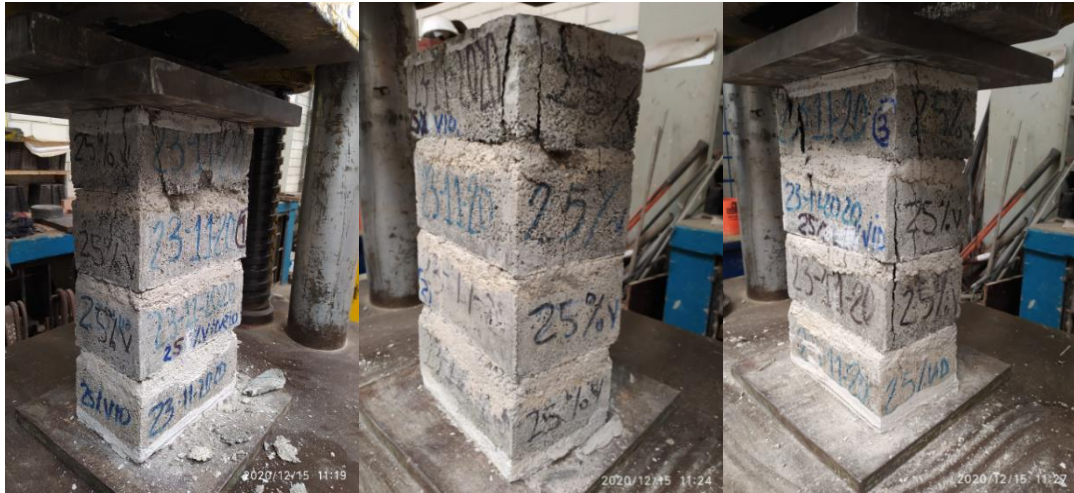
Figura 118. Fallas de prismas de ladrillo de concreto con 25 % de vidrio crudo molido Fuente: Elaboración propia
