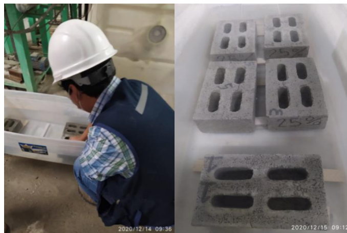
Figura 147. Ladrillo de concreto con 25 % vidrio crudo molido sumergido en agua Fuente: Elaboración propia
