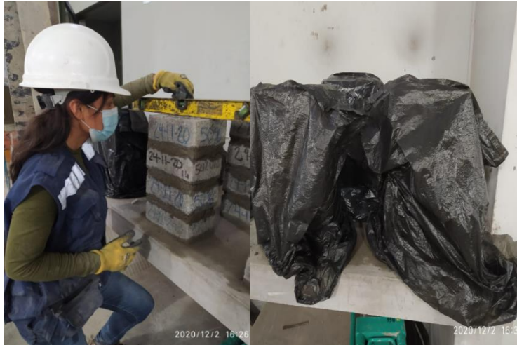
Figura 120. Verificación de nivel y cubierta de prismas de ladrillo de concreto con 50 % de vidrio crudo molido Fuente: Elaboración propia
