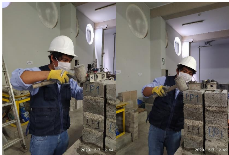
Figura 107. Capping de prisma de ladrillo concreto patrón Fuente: Elaboración propia
