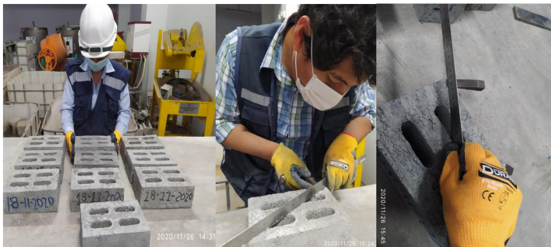
Figura 167. Muestra y medición de convexidad y concavidad de ladrillo de concreto patrón Fuente: Elaboración propia
