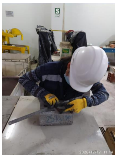
Figura 165. Concavidad de ladrillo de concreto Fuente: Elaboración propia
