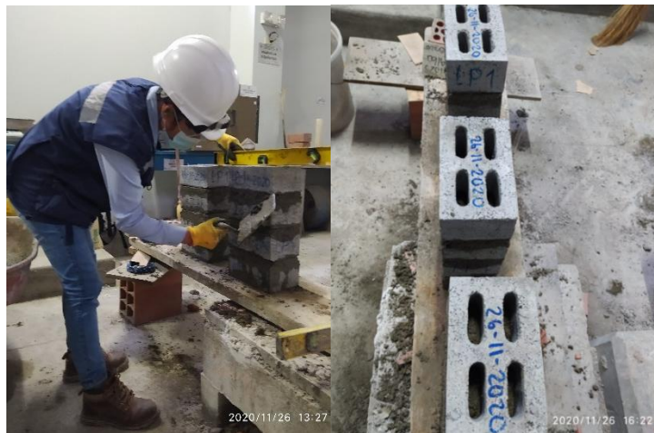
Figura 105. Verificación de nivel y elaboración del prisma de ladrillo de concreto patrón Fuente: Elaboración propia
