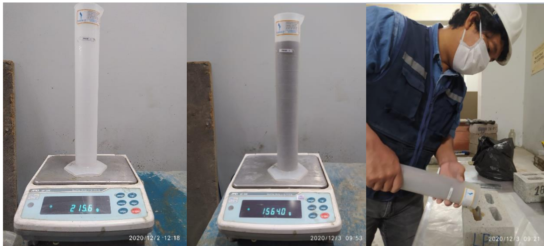
Figura 177. Peso de la probeta con arena y llenado de los alveolos del ladrillo de concreto patrón
