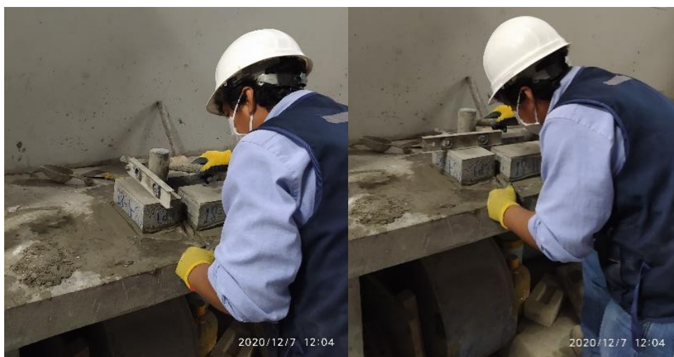
Figura 74. Refrentado de ladrillos de concreto patrón Fuente: Elaboración propia
