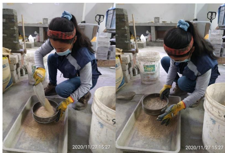
Figura 91. Tamizando el agregado fino de manera manual Fuente: Elaboración propia
