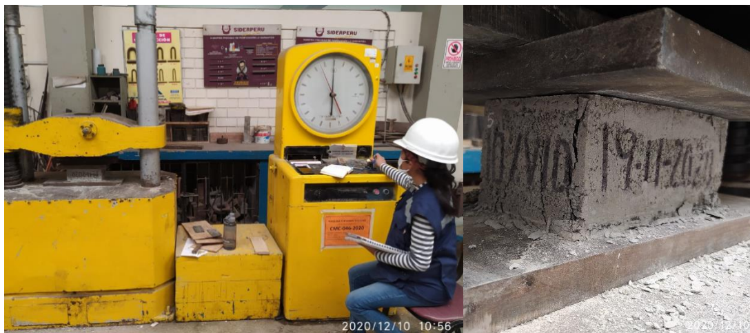
Figura 80. Ensayo de compresión en ladrillos con 10 % vidrio crudo molido Fuente: Elaboración propia
