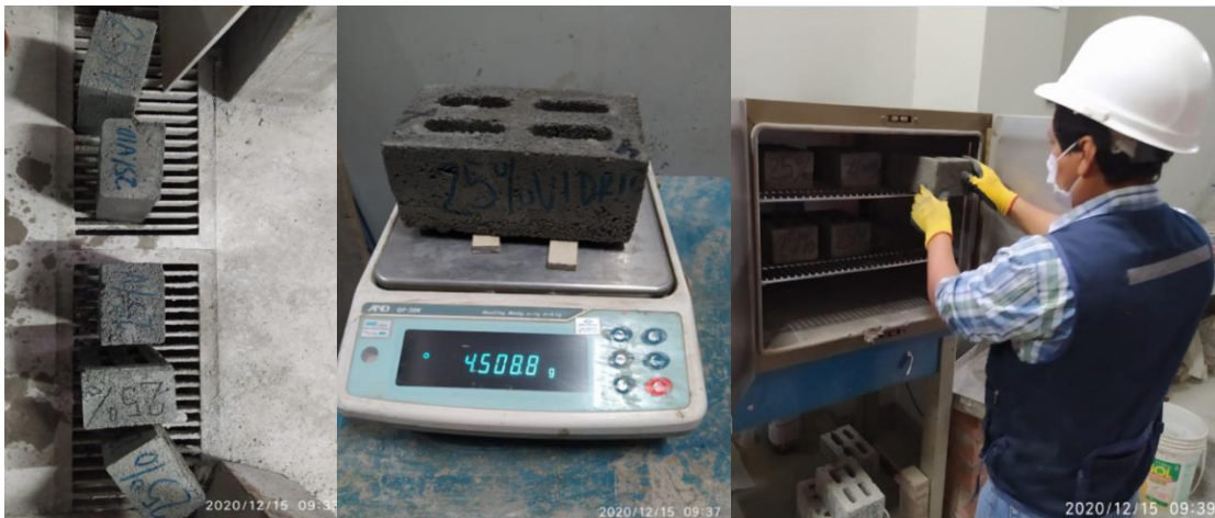
Figura 148. Drenado, registro de peso y secado de ladrillo de concreto con 25 % vidrio crudo molido Fuente: Elaboración propia
