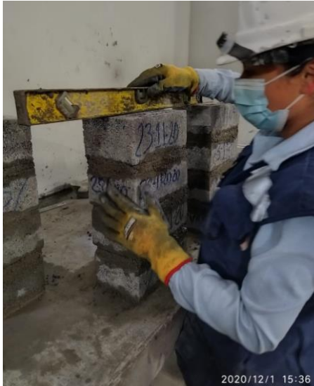
Figura 40. Elaboración de tres unidades prisma con 25 % vidrio Fuente: Elaboración propia
