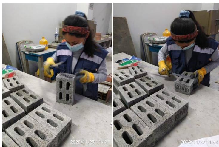
Figura 173. Muestra y mediciones de ladrillo de concreto con 10 % vidrio crudo molido Fuente: Elaboración propia
