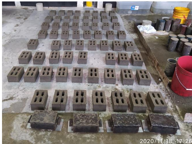
Figura 72. Fabricación de ladrillos de concreto patrón Fuente: Elaboración propia
