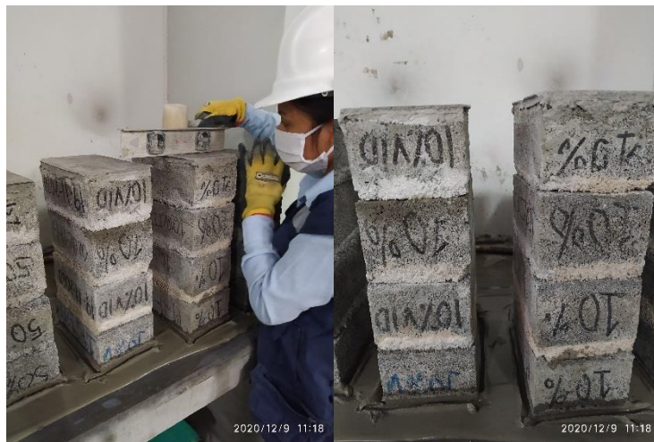
Figura 112. Refrentado del prisma de ladrillo de concreto con 10 % de vidrio crudo molido Fuente: Elaboración propia
