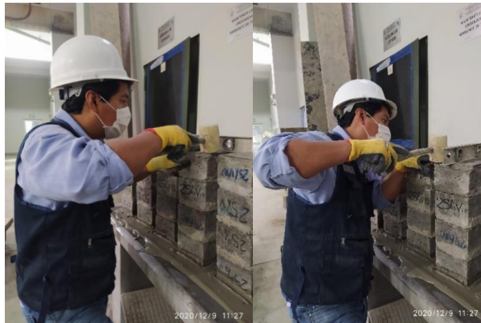
Figura 117. Refrentado del prisma de ladrillo de concreto con 25 % de vidrio crudo molido Fuente: Elaboración propia
