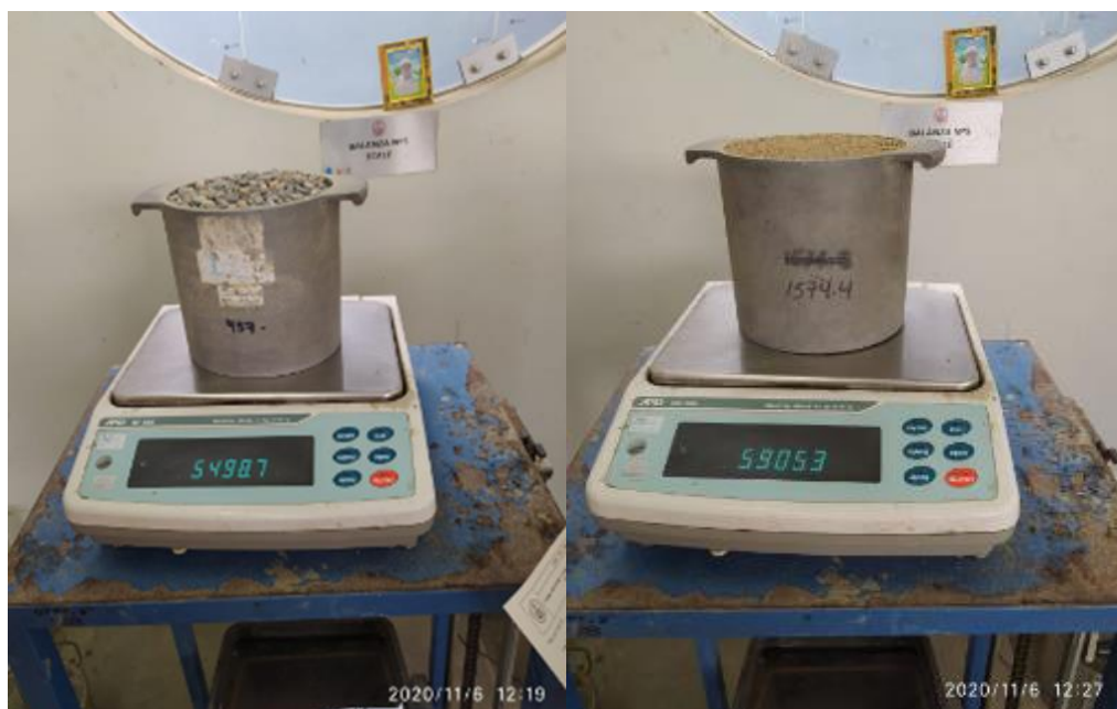
Figura 55. Peso unitario de los agregados Fuente: Elaboración propia
