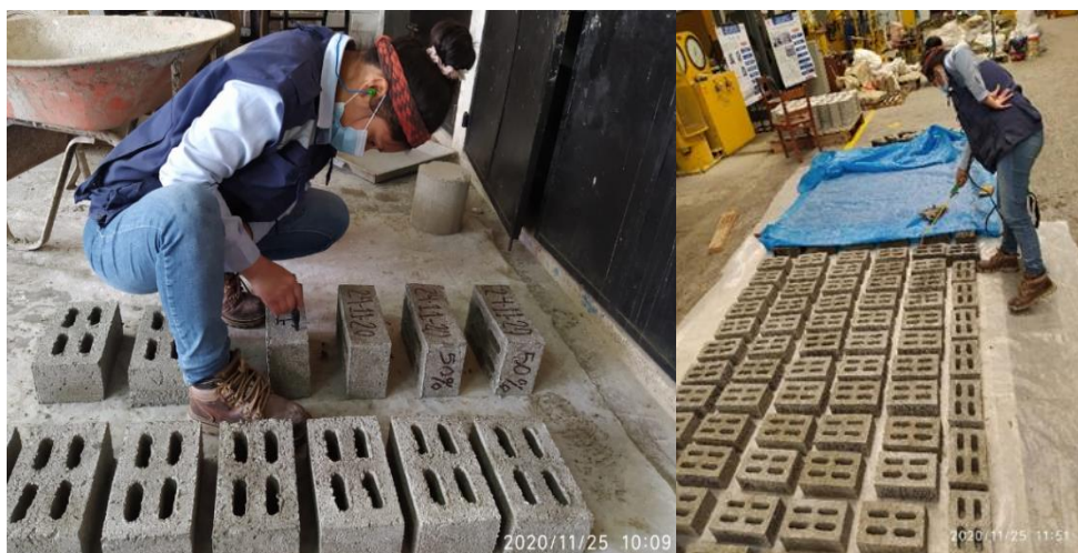
Figura 88. Rotulado y curado de ladrillos con 50 % vidrio crudo molido Fuente: Elaboración propia
