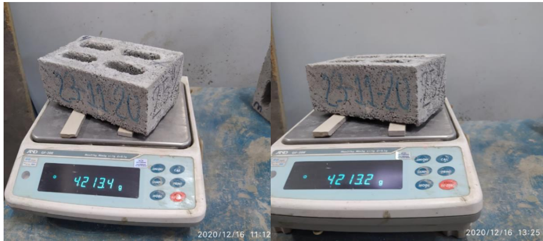
Figura 149. Registro de peso seco y constante de ladrillo de concreto con 25 % vidrio crudo molido Fuente: Elaboración propia
