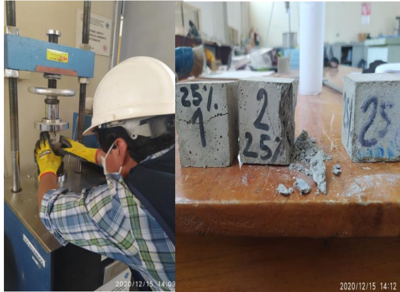
Figura 99. Ensayo a compresión de mortero en la elaboración de prisma y mortero con ladrillo de concreto con 25 % vidrio Fuente: Elaboración propia
