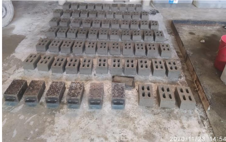
Figura 82. Fabricación de ladrillos con 25 % vidrio crudo molido Fuente: Elaboración propia
