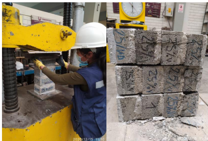
Figura 118. Ensayo de compresión del prisma de ladrillo de concreto con 25 % de vidrio crudo molido Fuente: Elaboración propia
