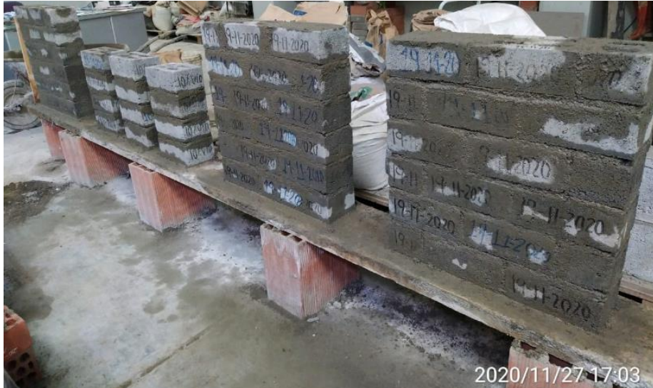
Figura 37. Elaboración de tres unidades de prisma y murete con ladrillo 10 % vidrio Fuente: Elaboración propia
