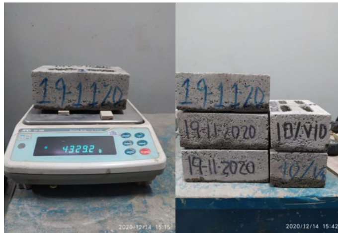
Figura 158. Registro de peso y muestra de ladrillo de concreto con 10 % vidrio crudo molido Fuente: Elaboración propia
