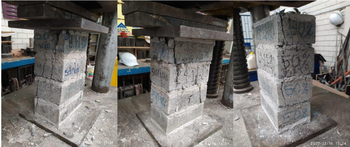
Figura 122. Fallas de prismas de ladrillo de concreto con 50 % de vidrio crudo molido Fuente: Elaboración propia
