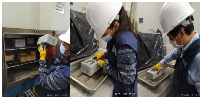
Figura 162. Secado al horno e inmersión en agua el ladrillo de concreto con 50 % vidrio crudo molido Fuente: Elaboración propia
