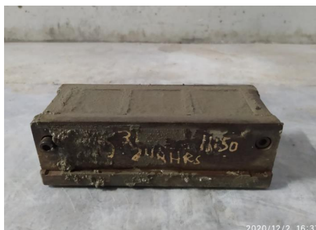
Figura 96. Elaboración de cubos de mortero de prisma y murete con ladrillo de concreto con 50 % vidrio Fuente: Elaboración propia
