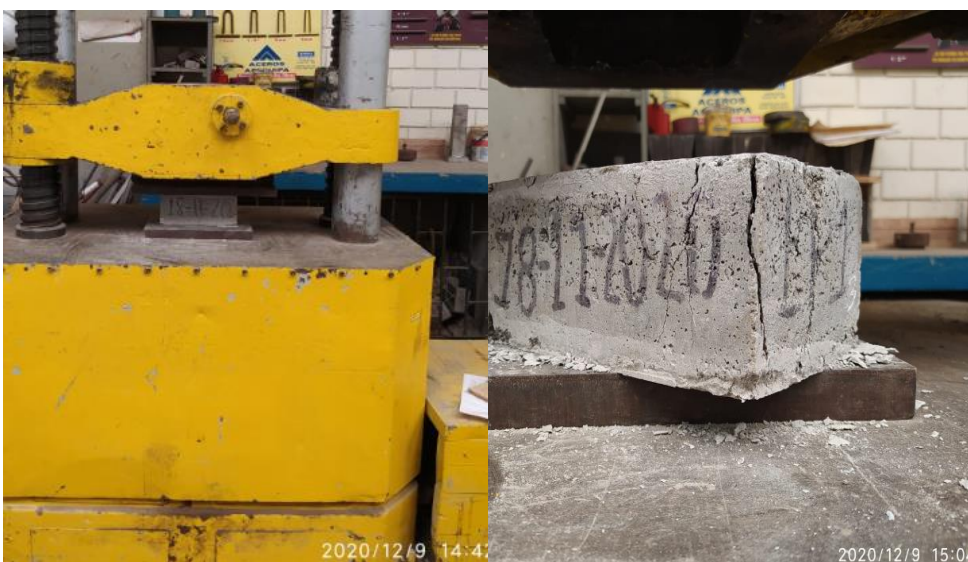
Figura 75. Ensayo de compresión en ladrillos de concreto patrón Fuente: Elaboración propia
