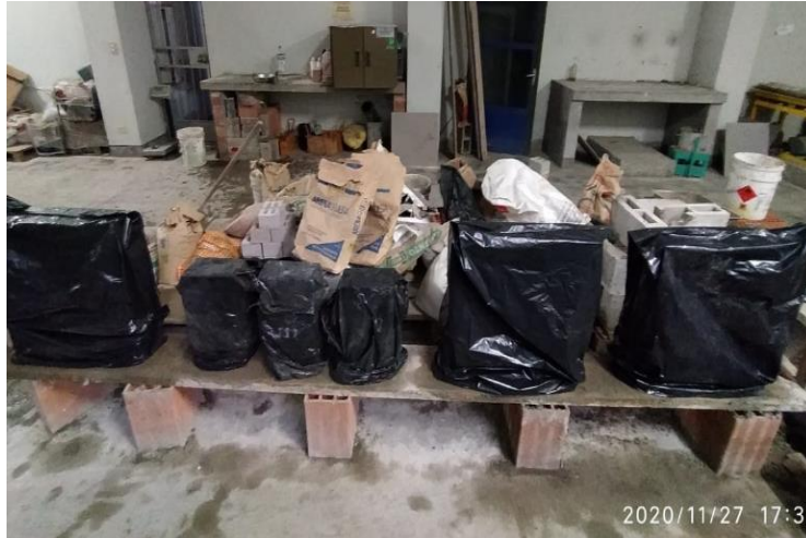
Figura 132. Cubierta de muretes con ladrillo de concreto con 10 % vidrio crudo molido Fuente: Elaboración propia
