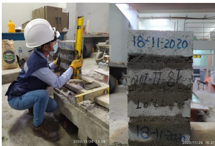
Figura 101. Verificación de nivel del prisma de ladrillo de concreto Fuente: Elaboración propia
