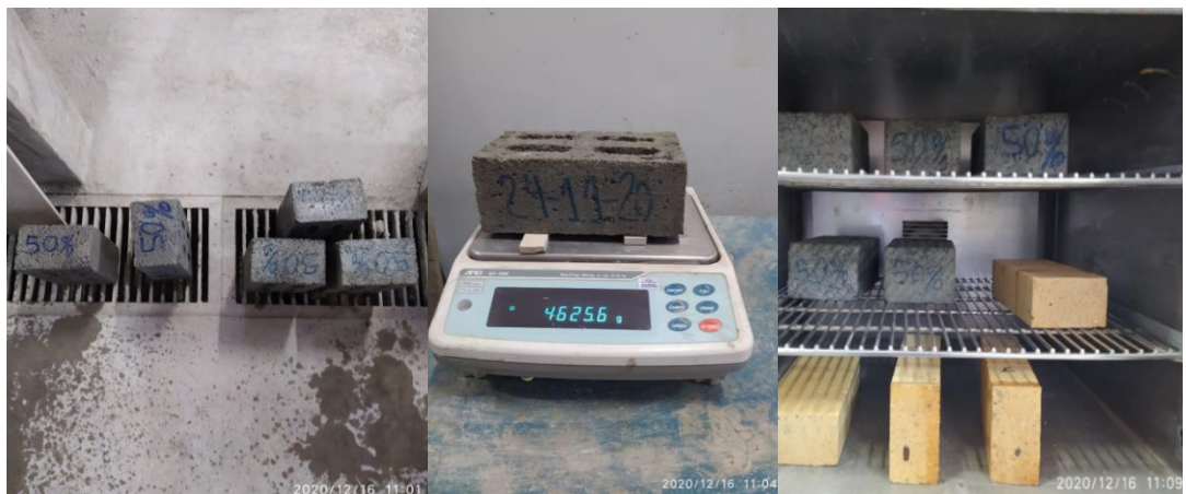
Figura 151. Drenado, registro de peso y secado de ladrillo de concreto con 50 % vidrio crudo molido Fuente: Elaboración propia
