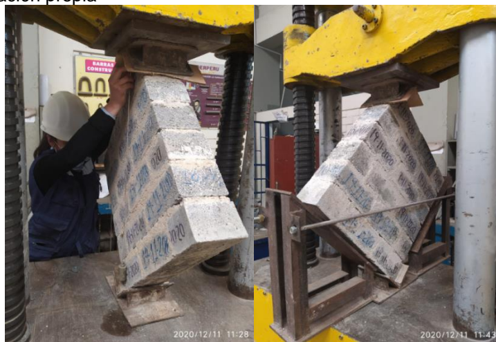
Figura 133. Plomeado del vértice al eje del soporte base del ladrillo de concreto con 10 % vidrio crudo molido Fuente: Elaboración propia
