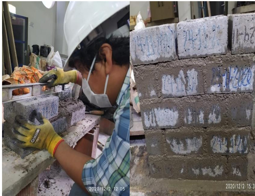
Figura 138. Nivelación de muretes con ladrillo de concreto con 50 % vidrio crudo molido Fuente: Elaboración propia
