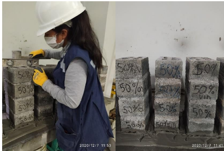
Figura 121. Refrentado del prisma de ladrillo de concreto con 50 % de vidrio crudo molido Fuente: Elaboración propia
