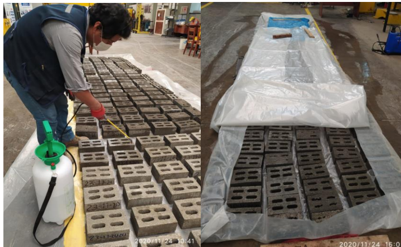
Figura 83. Rotulado y curado de ladrillos con 25 % vidrio crudo molido Fuente: Elaboración propia
