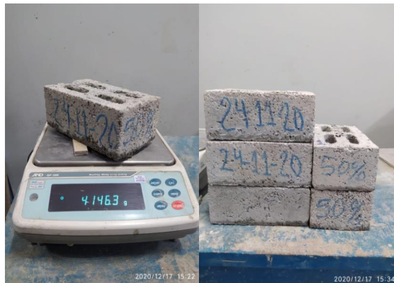
Figura 164. Registro de peso y muestra de ladrillo de concreto con 50 % vidrio crudo molido
