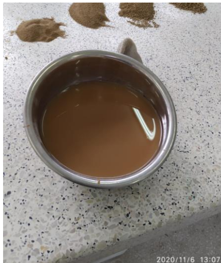
Figura 61. Reposo del agregado fino en el recipiente Fuente: Elaboración propia
