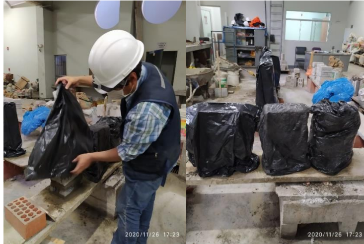
Figura 102. Cubriendo los prismas de ladrillo de concreto Fuente: Elaboración propia
