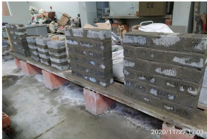
Figura 131. Elaboración de muretes culminado con ladrillo de concreto con 10 % vidrio crudo molido Fuente: Elaboración propia
