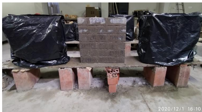
Figura 39. Elaboración de tres unidades muretes con ladrillo 25 % vidrio Fuente: Elaboración propia
