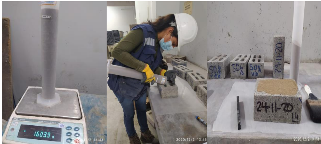
Figura 183. Peso de la probeta con arena, llenado de los alveolos y enrasado del ladrillo de concreto con 50 % vidrio crudo molido Fuente: Elaboración propia
