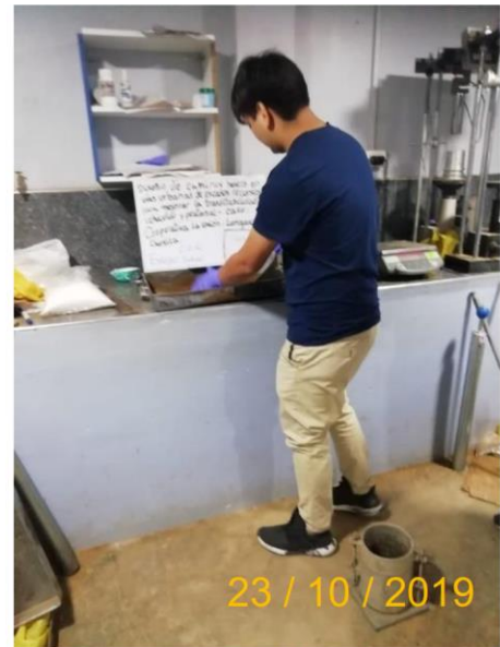
Imagen N° 8: Mezclando muestra para realizar el Proctor modificado
