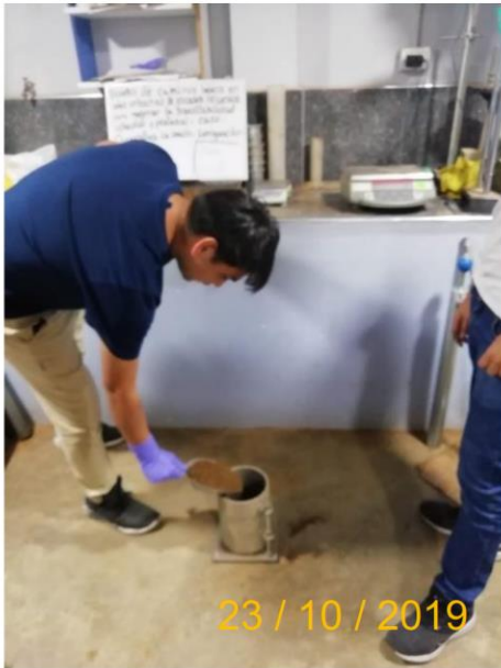
Imagen N° 12: Colocación de muestra (primera capa) en el molde del CBR
