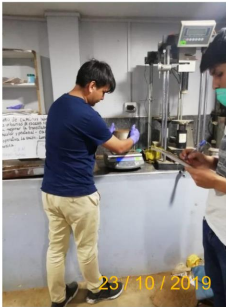
23 / 10 / 2019 Imagen N° 14: Pesado del molde -CBR
