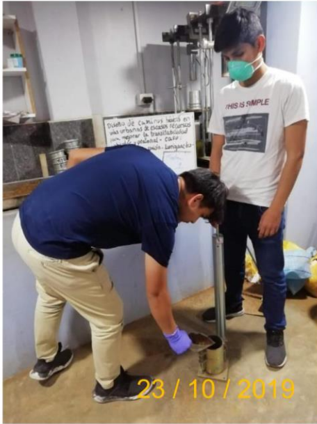
Imagen N° 10: Colocación de muestra (tercera capa) en el molde de Proctor modificado
