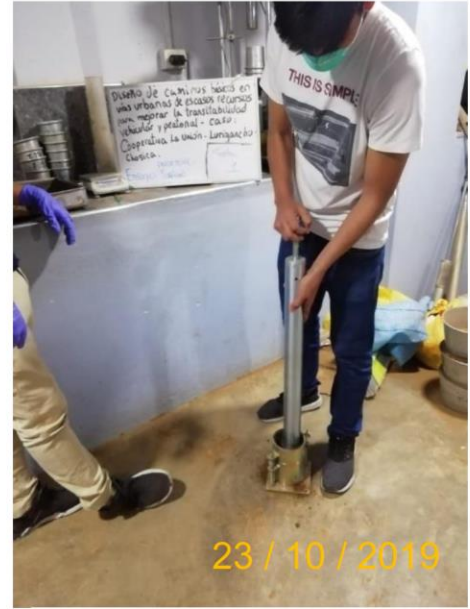
Imagen N° 9: Momento de compactación del suelo – Proctor Modificado
