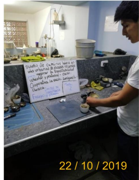
Imagen N° 6: Ensayo de Límite plástico
