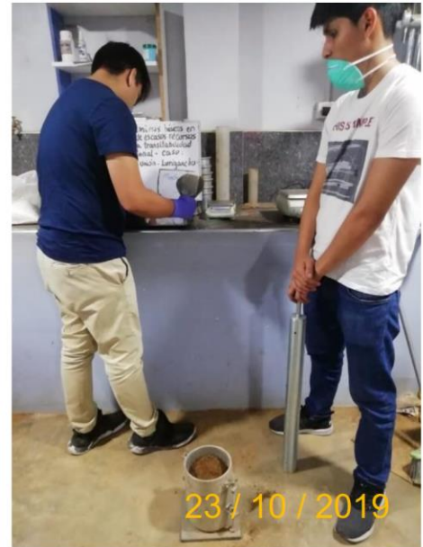
Imagen N° 11: Momento antes de realizar la compactación de CBR
