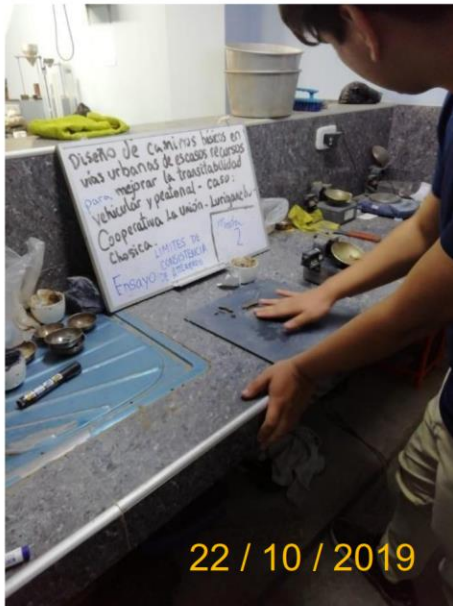
Imagen N° 7: Ensayo Límite Líquido
