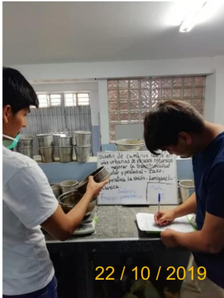
Imagen N° 5: Ensayo de Granulometría
