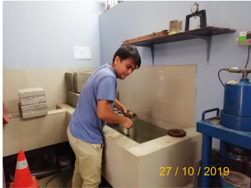
Imagen N°20: Retirando el molde del pozo, para que luego sea colocado en la máquina de penetración
