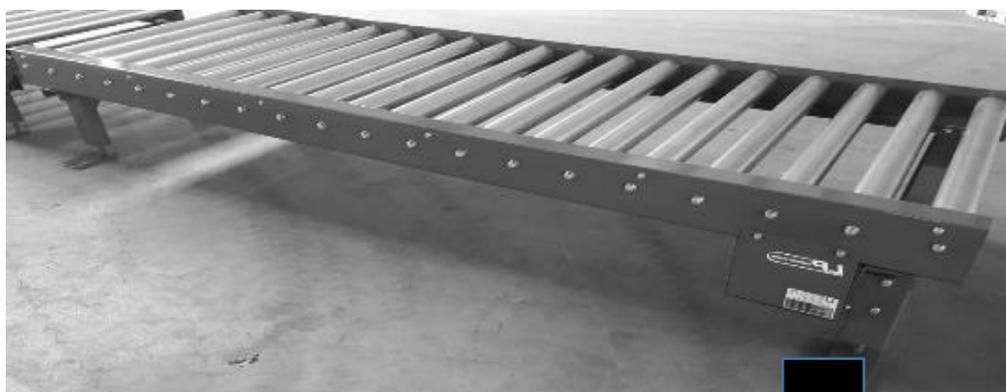
*Figura 312.* Mesas de rodillo motorizado para transporte de vigas.
