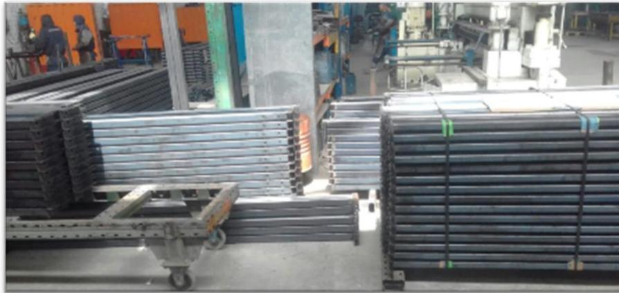
*Figura 16.* Vigas Onduladas esperando ser atendidas por el proceso de Despepado. Fuente: Empresa E&S de Almacenamiento Parck. Elaboración: Los autores.
