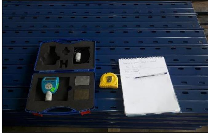
*Figura 160.* Instrumentos para la medición de espesor de pintura.
