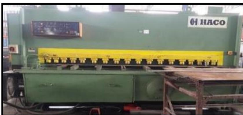
*Figura A15.* Guillotina Electro Hidráulica.
