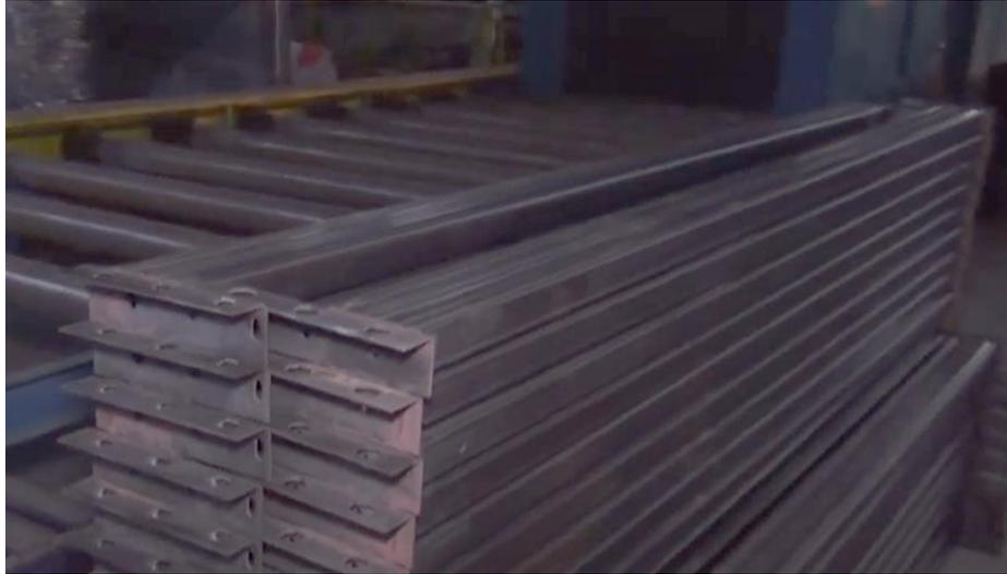
*Figura 399.* Vigas onduladas a salida de conformado y acoplado.
