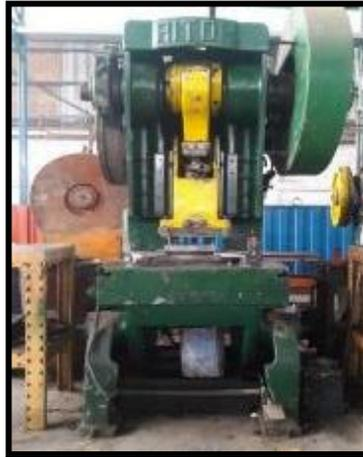
*Figura A16.* Prensa excéntrica mecánica.
