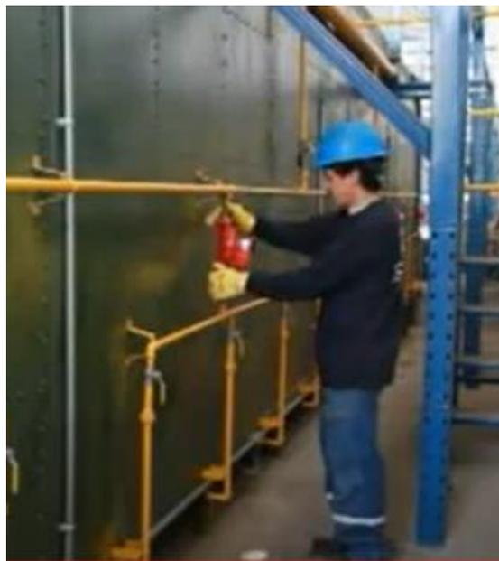
*Figura 355.* Realización de la limpieza general del horno continuo y mantenimiento a quemadores
