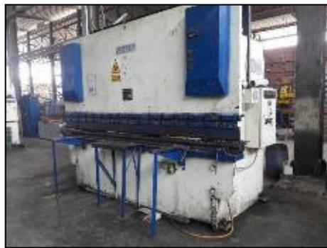
*Figura A17.* Plegadora Electro Hidráulica.
