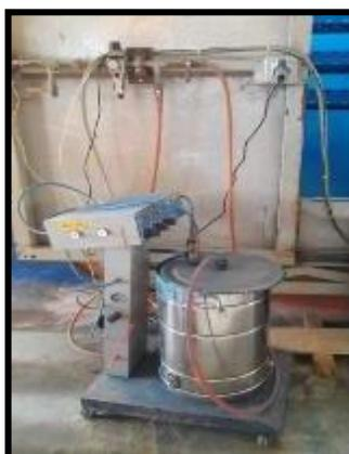
*Figura A9.* Máquina Electrostática.
