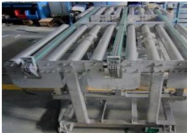
Figura 346. Mesa de rodillos instalada.
