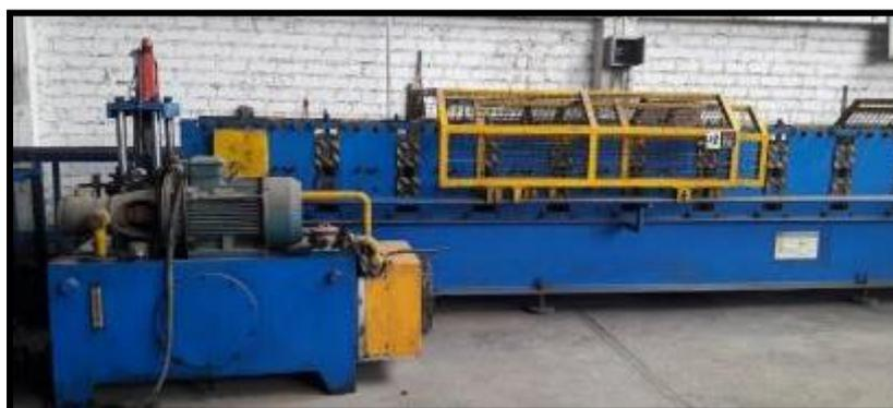
*Figura A12.* Conformadora de vigas.
