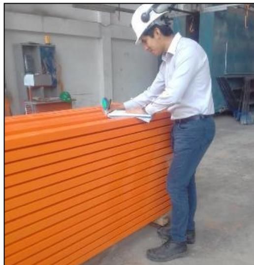
*Figura 161.* Muestreo de espesor de pintura en vigas.
