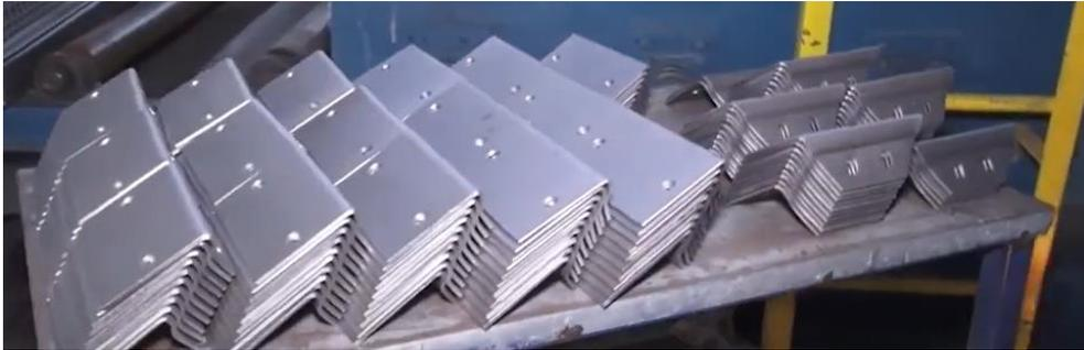
*Figura 396.* Mesa de transporte de uñas para vigas onduladas, con capacidad establecida.
