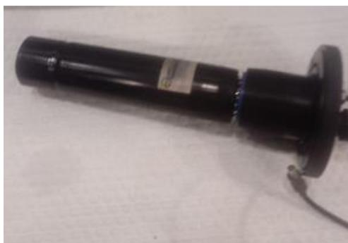
*Figura 357.* Termocupla principal con cable suelto y roto, enviando falsa señal al quemador principal.
