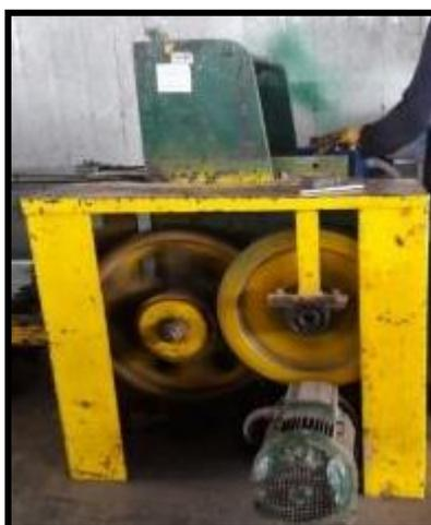
*Figura A14.* Guillotina Mecánica.
