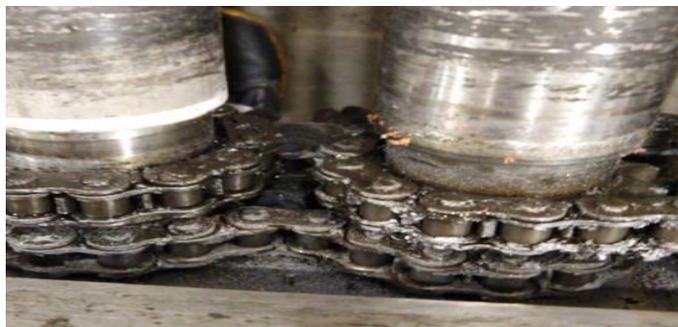
Figura 376. Piñón de ataque de motor principal con engranaje de cadena de arrastre.
