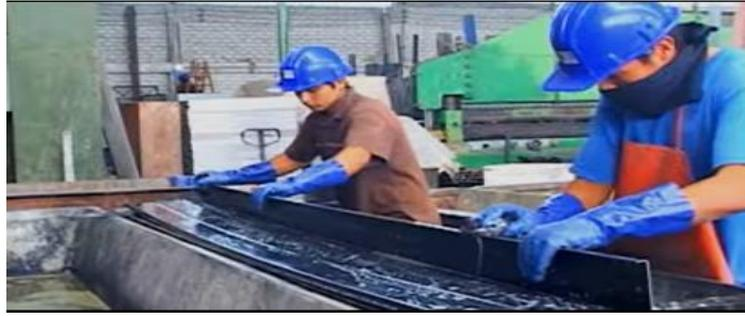
*Figura J7.* Proceso Limpieza Mecánica.
