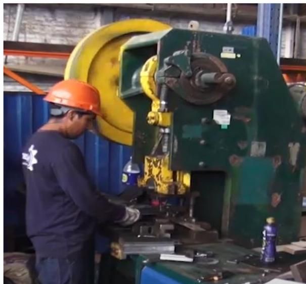
*Figura 395.* Operario en trabajo de corte de fleje luego de la instalación de célula de corte.
