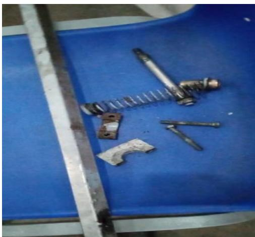
*Figura 363.* Mordazas de agarre de cadena secundaria con desgaste mecánico.
