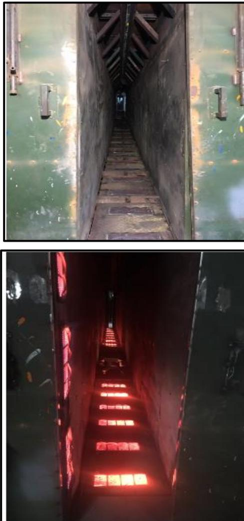
*Figura 338.* Horno continuo con ladrillos refractarios incorporados.
