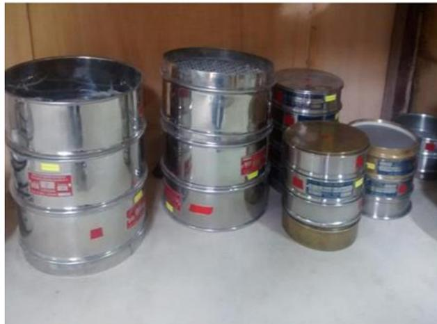
Figura 95: Set de tamices utilizados para el ensayo de granulometría.
