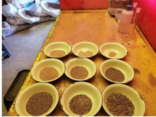
Figura 102: Análisis granulométrico de la fracción fina.
