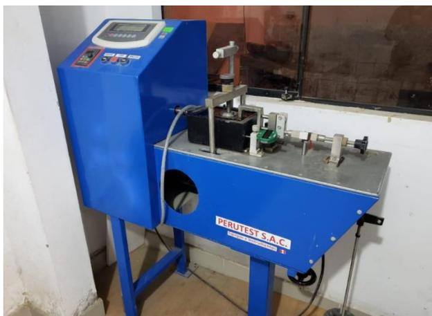
Figura 93: Equipo de Corte Directo marca Perú Test modelo PT-CD-500.
