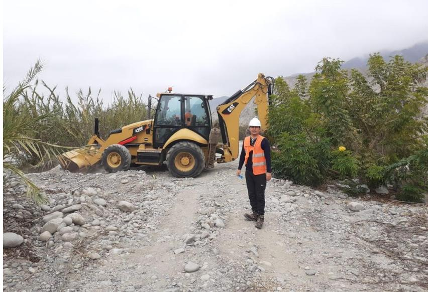
Figura 34: Retroexcavadora marca CAT 416F2.
