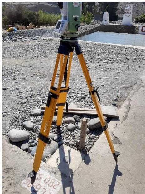
Figura 22: Estación Total, Leica, Modelo TS 07 R500 de 5”.
