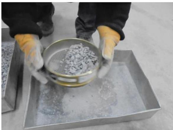
Figura 100: Proceso de tamizado de fracción gruesa.
