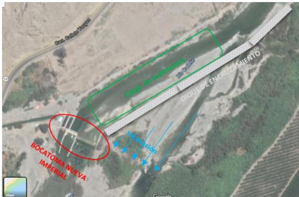
Figura 2: Propuesta de encauzamiento con diques aguas arriba de bocatoma Nueva Imperial.
