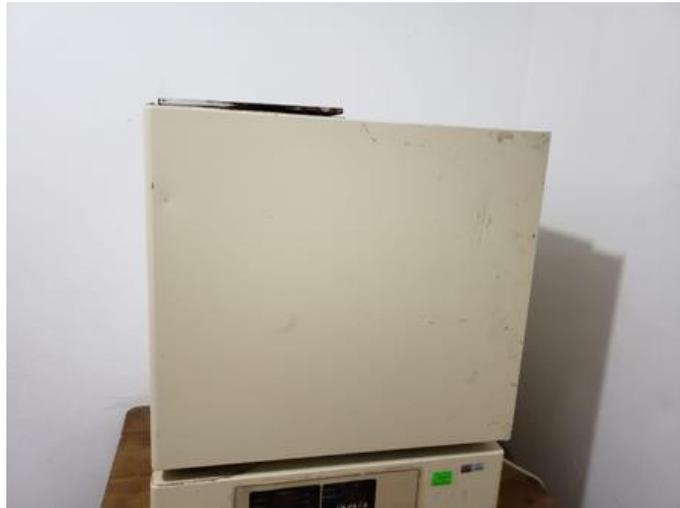
Figura 97: Horno utilizado para el ensayo de granulometría.
