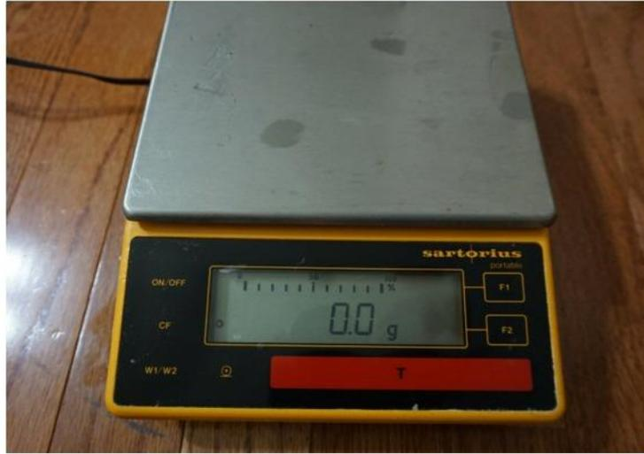
Figura 96: Balanza utilizado para el ensayo de granulometría.
