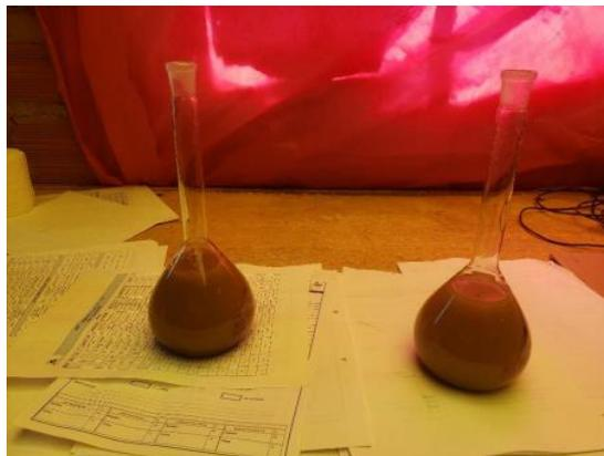
Figura 107: Determinación de la Gravedad Especifica del Suelo.
