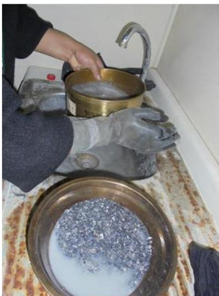
Figura 99: Lavado de la muestra en el tamiz N°200.
