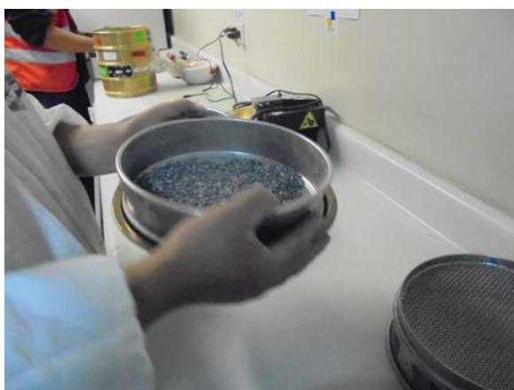
Figura 101: Proceso de tamizado de fracción fina.
