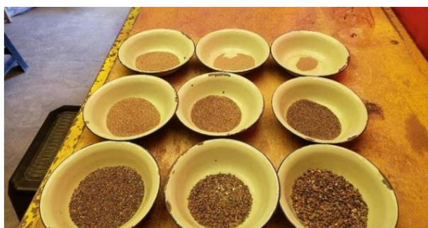
Figura 145: Distribución del material según el material retenido C-3.
