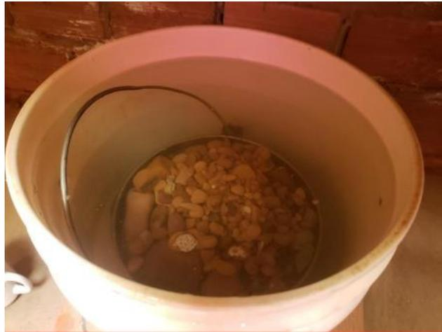
Figura 106: Ensayo de Peso específico del material Retenido en el tamiz N°04.
