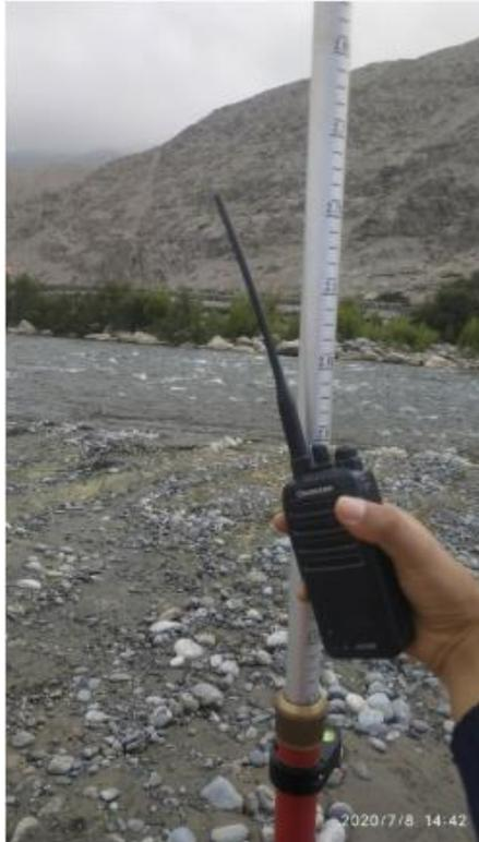
Figura 23: Prisma Leica y el radio de comunicaciones
