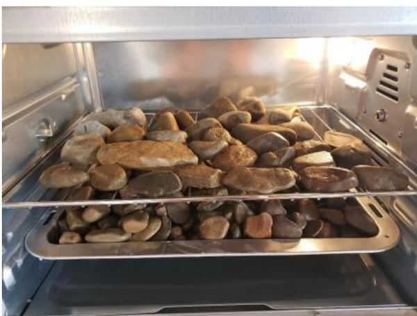
Figura 105: Secado de muestra en Horno ensayo de peso específico.
