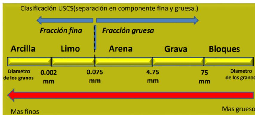
Figura 37: Separación de componentes finos y gruesos.
