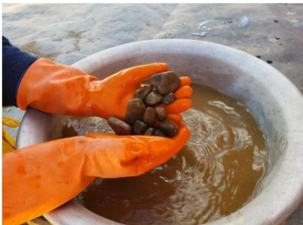
Figura 104: Preparación de la muestra para determinar su peso específico.
