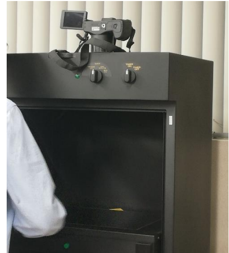
Figura 9. Determinación de características cromáticas CIELAB
