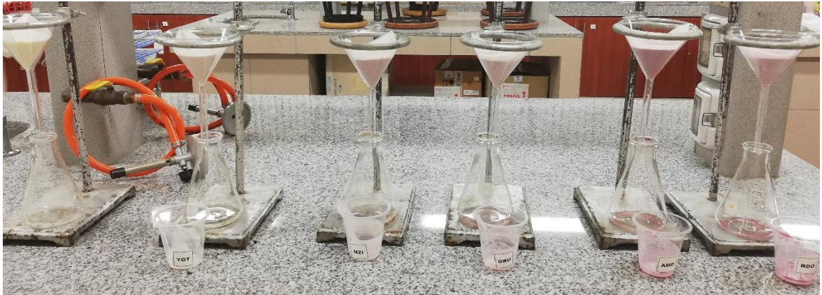
Figura 10. Determinación de sinéresis de las muestras de yogur por el método de decantación
