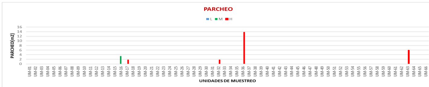
Figura N°49: Distribución de fallas en la vía de acceso al Centro Poblado Montegrande – PARCHEO
