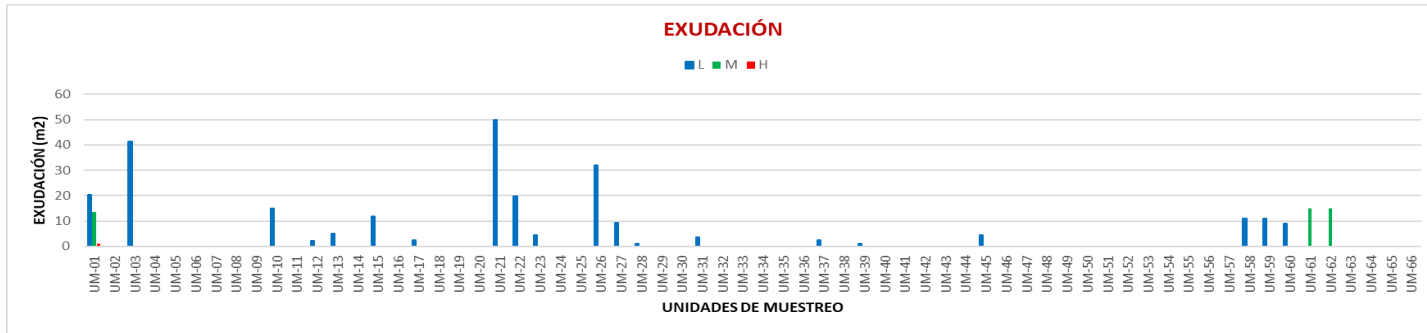
Figura N° 40: Distribución de fallas en la vía de acceso al Centro Poblado Montegrande- EXUDACIÓN
