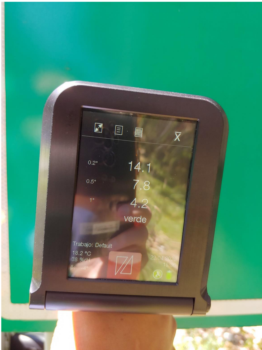
Ilustración 115: Vista de retroreflectividad en señalización vertical verde I – 18 ( \mu.0.2^\circ=14.1 ) del Puente Huambutio II
