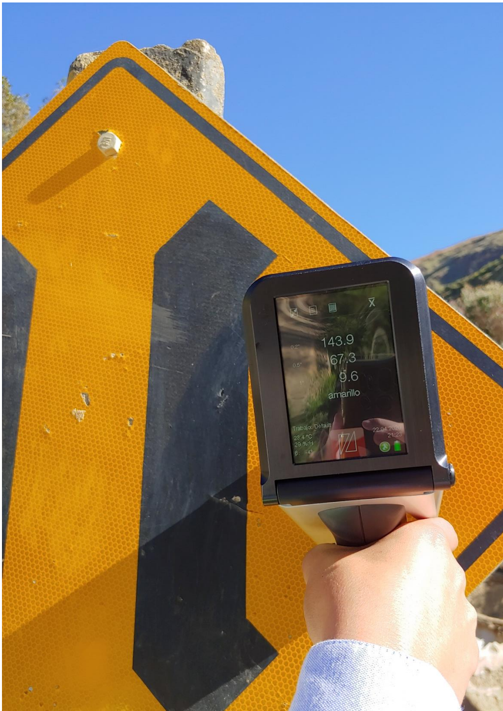
Ilustración 114: Vista de retroreflectividad en señalización vertical amarilla P – 40 ( \mu.0.2^\circ=143.9 ) del Puente Huambutio II
