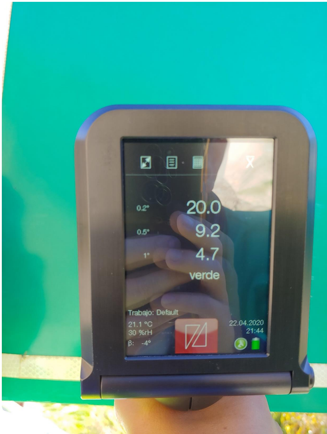
Ilustración 71: Vista de retroreflectividad en señalización vertical verde I – 18 ( \mu.0.2^\circ=20 ) del Puente Huambutio I
