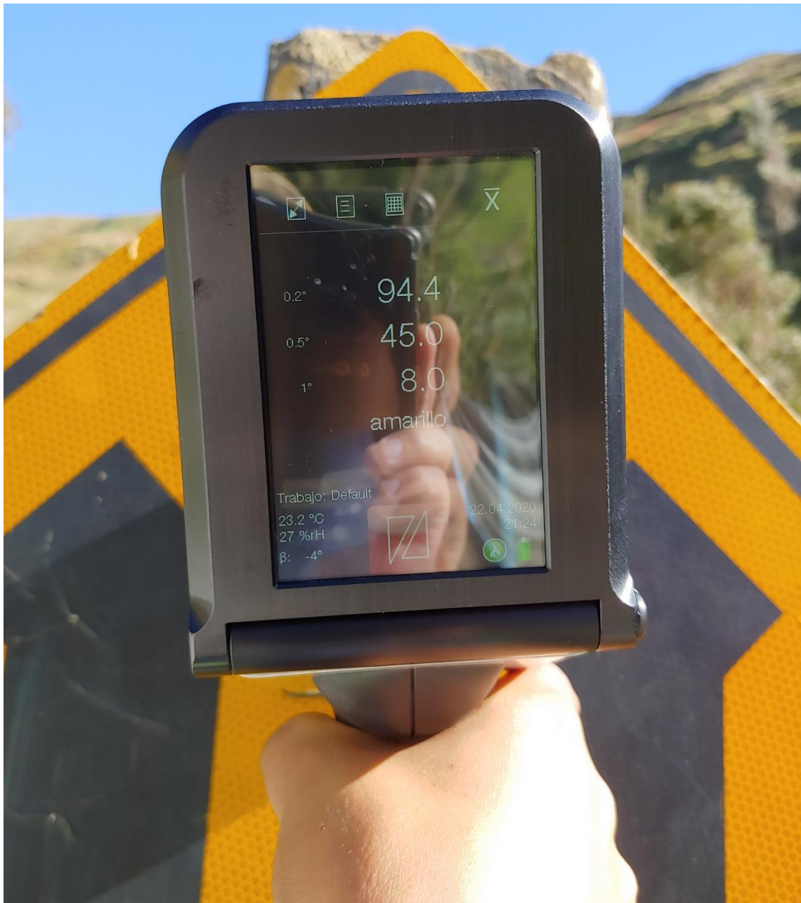
Ilustración 72: Vista de retroreflectividad en señalización vertical verde P – 40 ( \mu.0.2^\circ=94.4 ) del Puente Huambutio I
