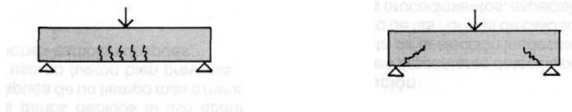
Figura N°10 Grietas en viga flexión pura. Figura N°11 Grietas en viga por esfuerzo de corte
