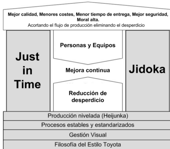
Figura 6. La Casa de Toyota - Lean (reducida). Tomado de “Filosofía Lean aplicada a la Ingeniería del Software” p.34, M.A. Moreno Martín, 2010, Sevilla, España.
