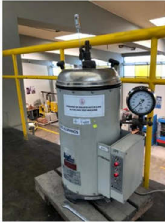
Figura 32 Máquina para ensayo de expansión
