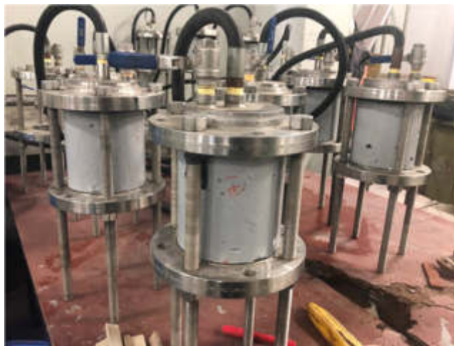
Figura 45 Ensayo de permeabilidad
