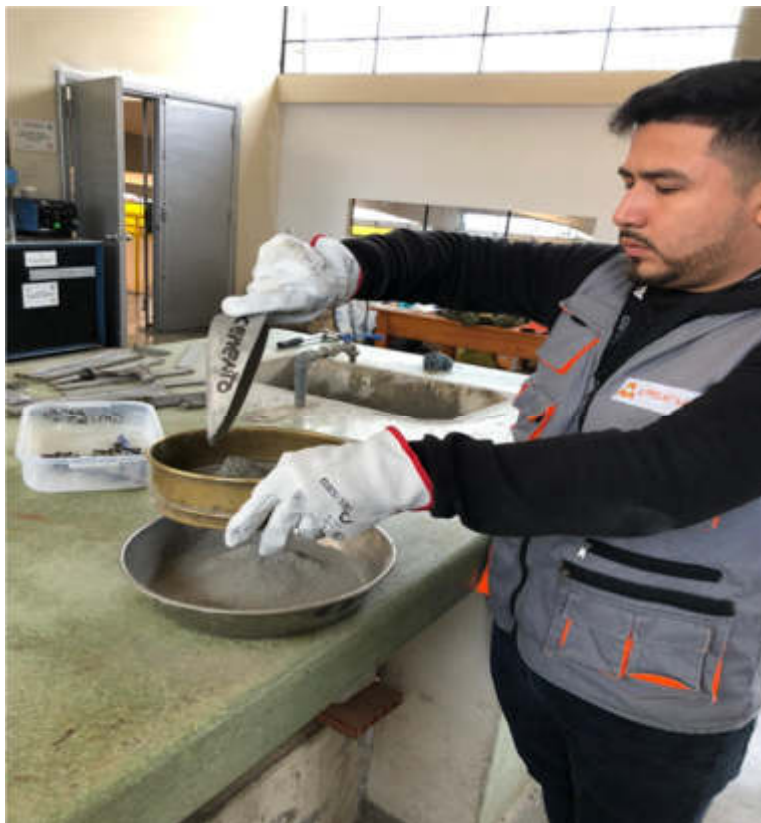
Figura 85 Separamos la parte final del cemento con la malla n° 20. Fuente: elaboración propia
