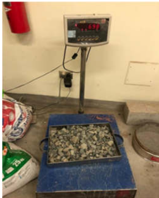
Figura 14. Peso de agregado grueso para peso unitario Fuente: Elaboración propia
