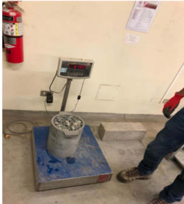
Figura 15. Peso de agregado grueso compactado Fuente: Elaboración propia
