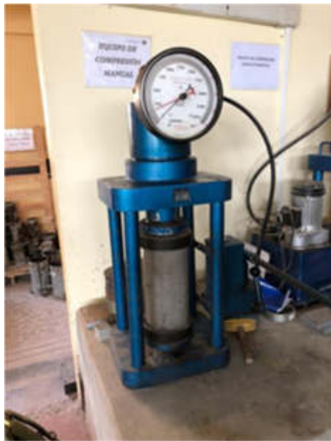
Figura 28. Rotura de probeta a compresión Fuente: Elaboración propia
