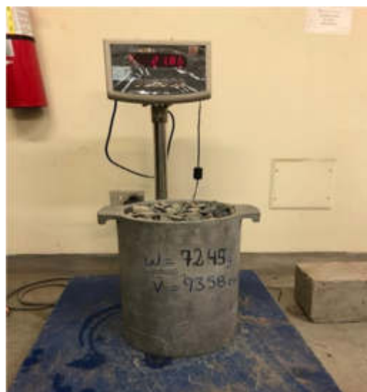
Figura 16. Peso de agregado grueso compactado Fuente: Elaboración propia
