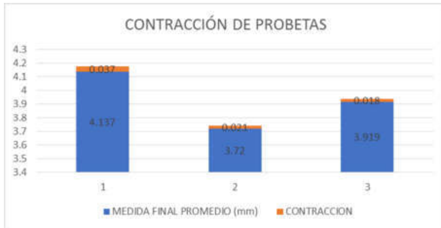
Figura 61 Variación de longitud de las probetas del cemento Portland tipo HS
