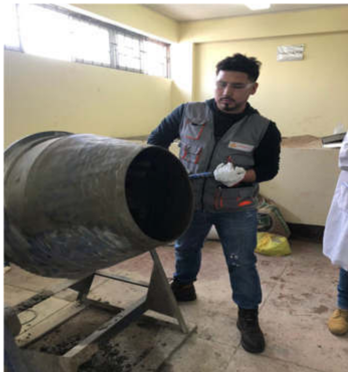
Figura 75 Elaboración del concreto para fabricación de probetas Fuente: elaboración propia
