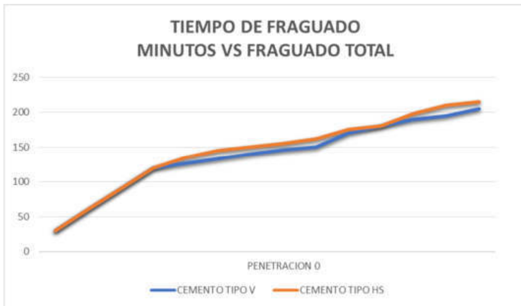
Figura 65 Comparación del tiempo de fraguado Fuente: Elaboración propia
