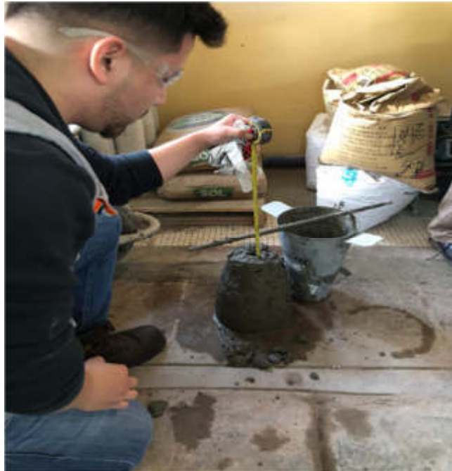
Figura 77 Cálculo de Slump para el diseño de mezcla. Fuente: elaboración propia
