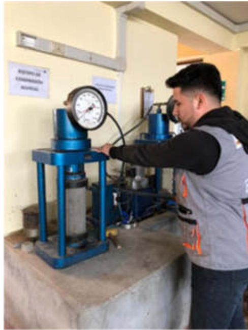
Figura 29. Rotura de probeta a compresión Fuente: Elaboración propia
