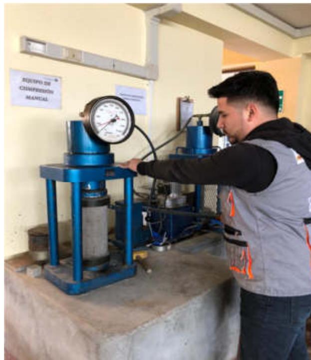
Figura 79 Ejecución de ensayo de resistencia a la compresión.
