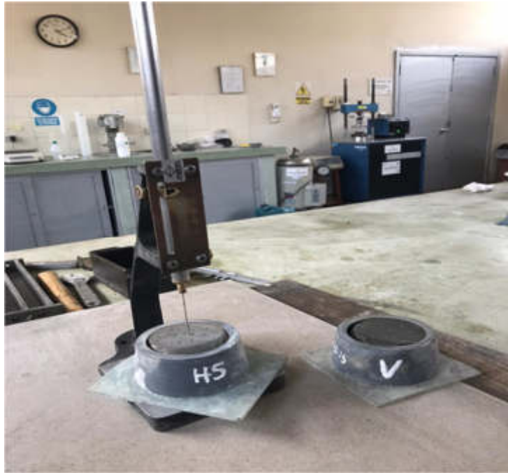
Figura 86 Con el aparato Vicat, calculamos el tiempo de fraguado final del cemento.
