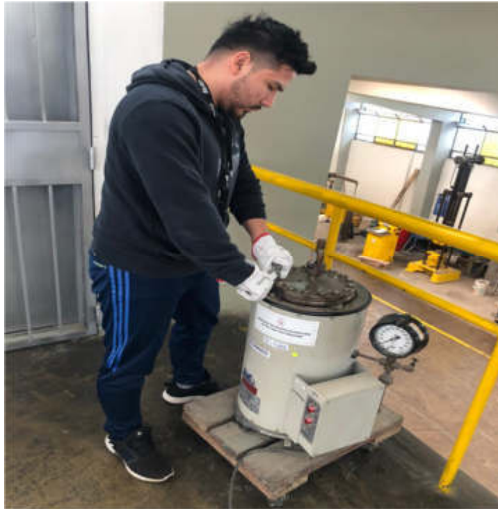
Figura 80 cierre de capsula para ensayo de porcentaje de expansión en autoclave.
