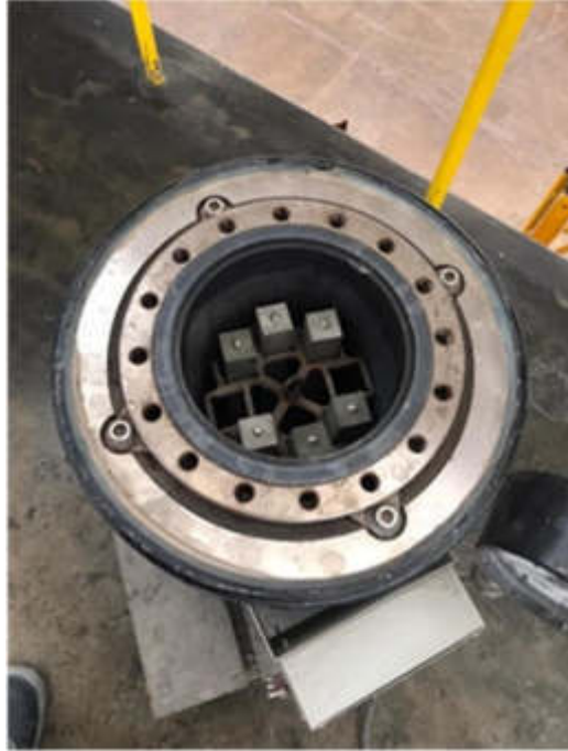
Figura 33. Máquina para ensayo de expansión Fuente: Elaboración propia
