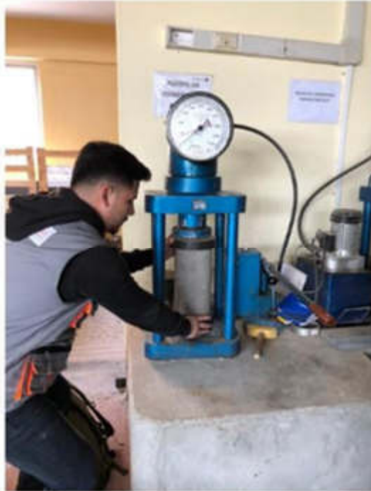
Figura 27. Rotura de probeta a compresión Fuente: Elaboración propia
