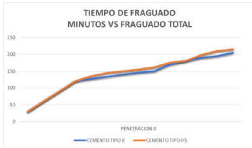
Figura 72. Tiempo de fraguado: minutos vs. fraguado total
