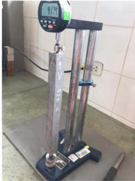
Figura 36. Aparato de medición de longitud Fuente: Elaboración propia
