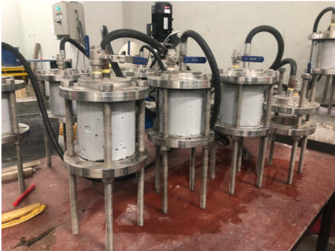
Figura 87 Cálculo de permeabilidad de concreto.
