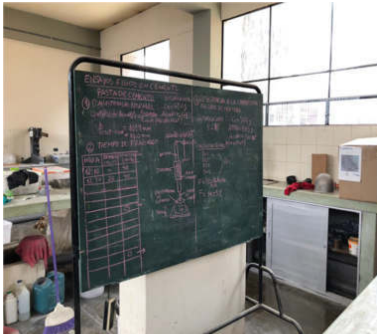
Figura 84 Toma de datos para ensayo de tiempo de fraguado. Fuente: elaboración propia
