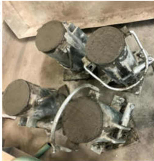
Figura 26. Testigos de concreto tipo HS
