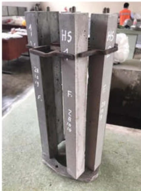
Figura 31. Limpieza de moldes para ensayo de expansión
