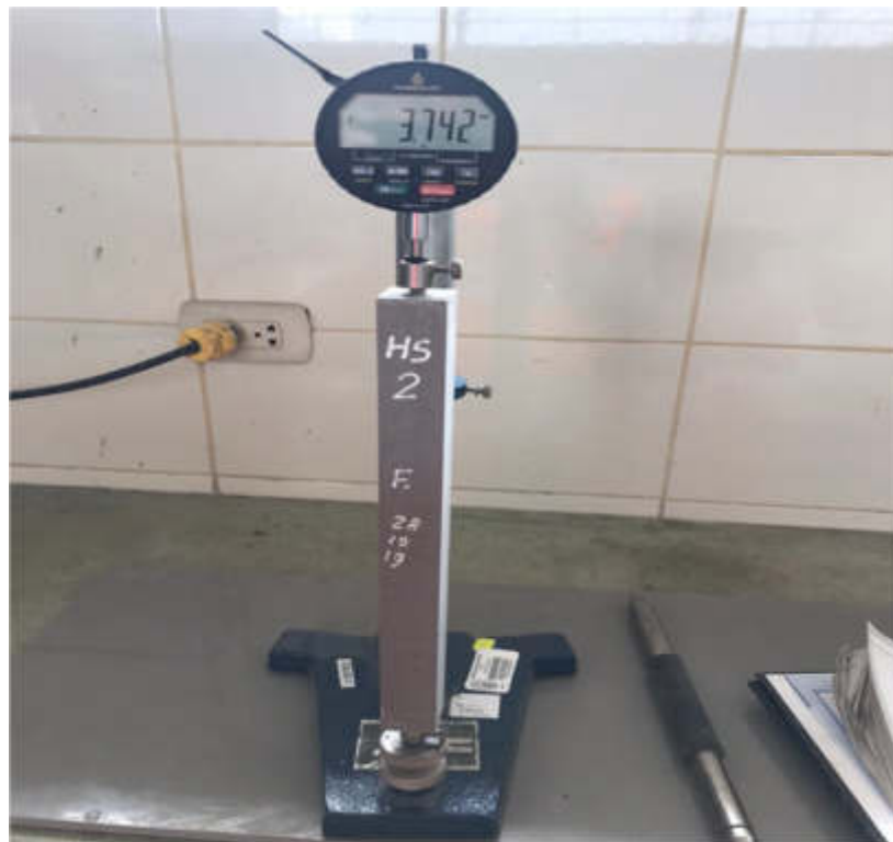
Figura 83 Calculo de porcentaje de expansión de probeta.
