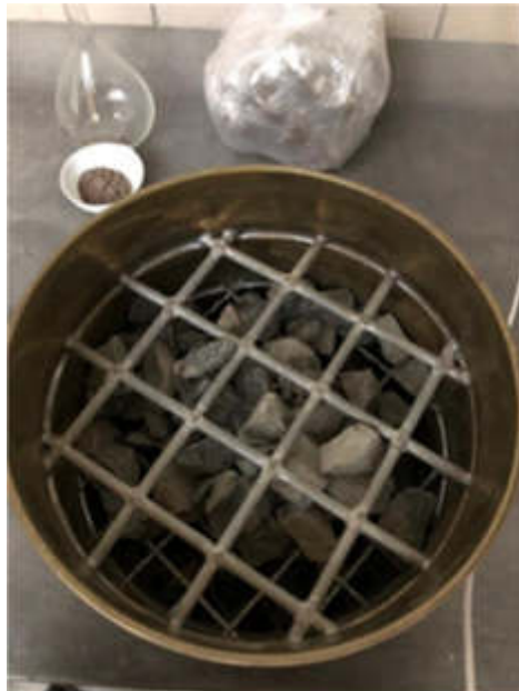
Figura 12. Tamizado de agregado grueso Fuente: Elaboración propia
