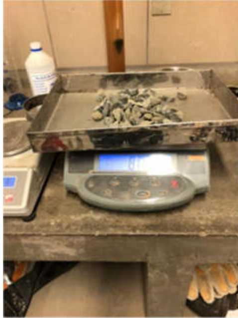
Figura 13. Peso de agregado grueso suelto Fuente: Elaboración propia
