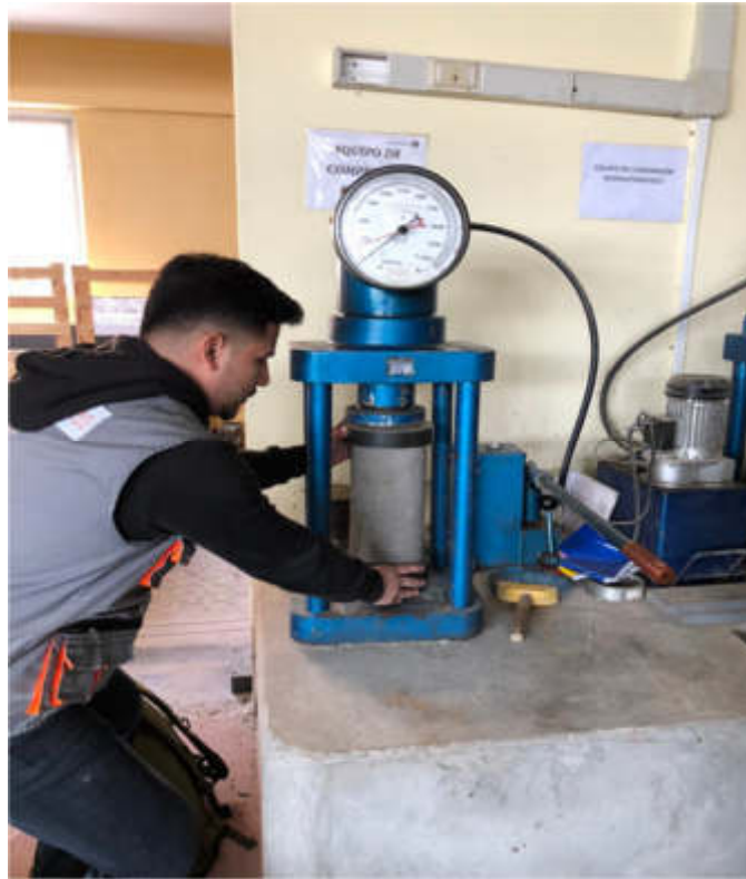
Figura 78 Colocación de probeta en compresora hidráulica.
