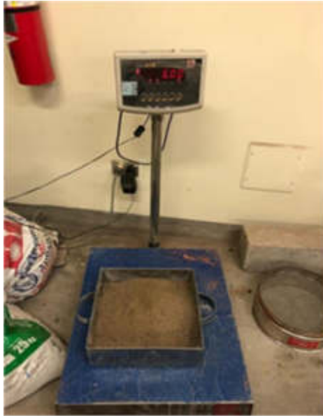
Figura 17. Peso de agregado fino para peso unitario Fuente: Elaboración propia
