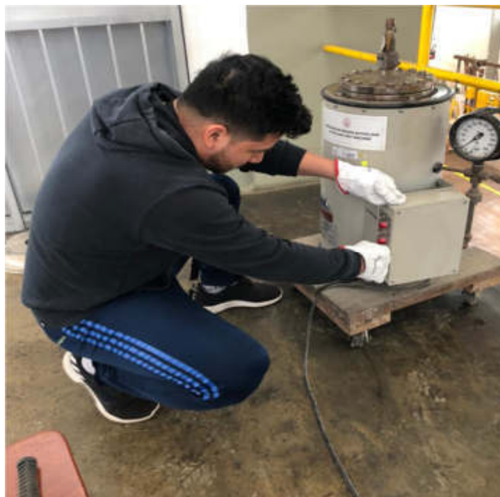
Figura 81 Apagado de primera válvula para conseguir una presión constante dentro de la capsula.
