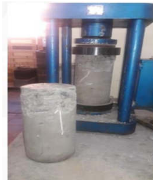
Figura 30. Rotura de probeta a compresión Fuente: Elaboración propia
