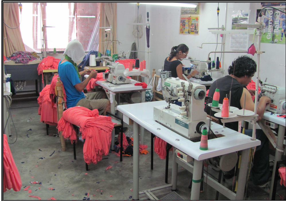
Foto 6: Falta de protectores contra la pelusa para los trabajadores y demarcación de zona de tránsito
