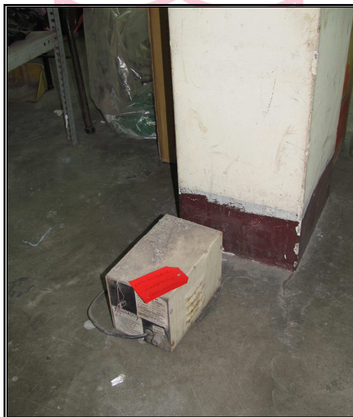
Foto 7: Estabilizador innecesario, se clasifica con tarjeta roja Fuente: Captura propia
