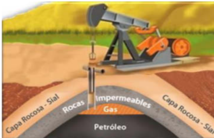
Figura 1: Depósitos de gas natural
