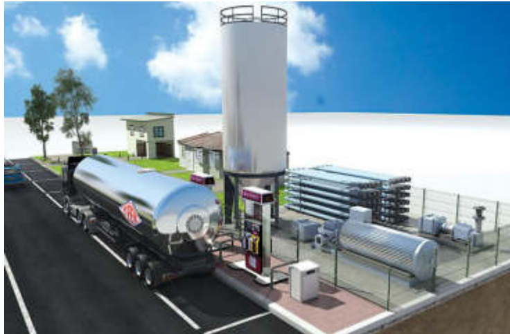
Figura 14: Cisterna criogenizada GNL
