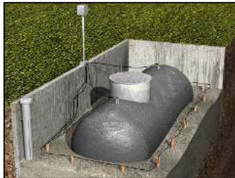
Figura 3. Tanque estacionario de GLP enterrado.
