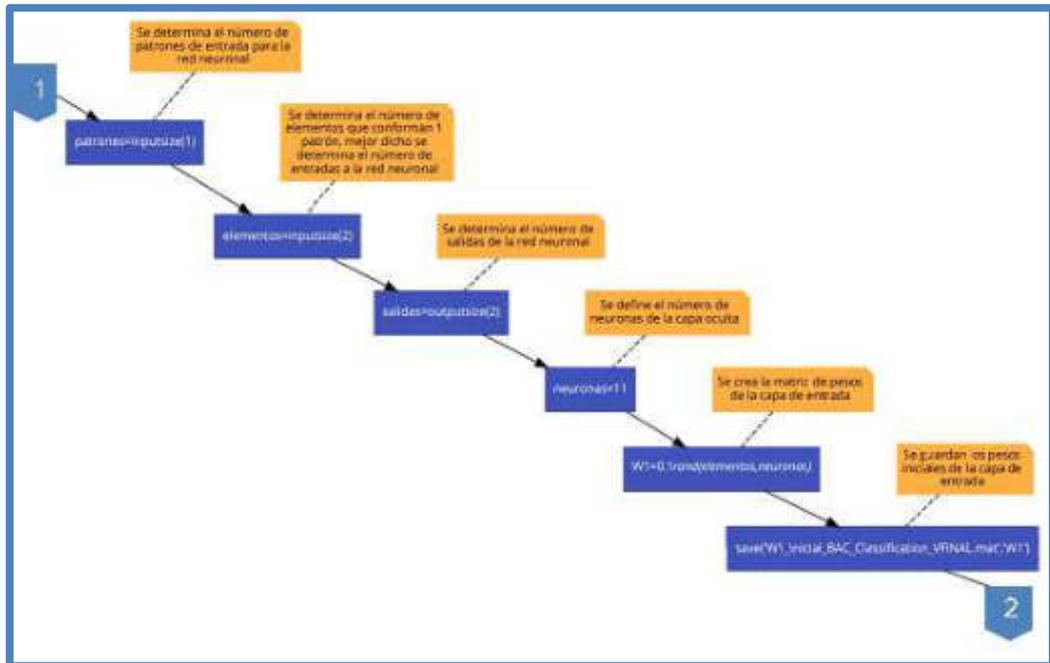
Fig. 139 Diagrama de Flujo del Algoritmo de Retropropagación – Rama Principal – Parte 2
