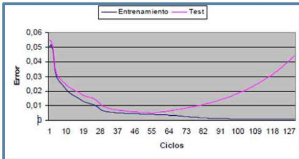
Fig. 51 Mal Nivel de Generalización – Error vs Ciclos
