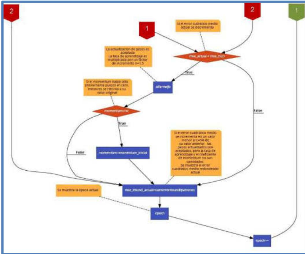
Fig. 152 Diagrama de Flujo del Algoritmo de Retropropagación – Rama Central
