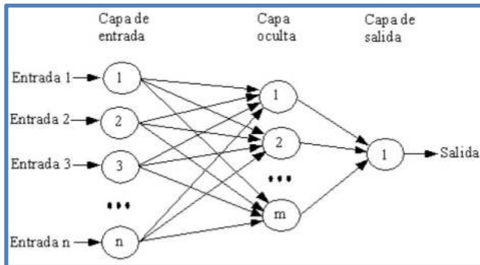
Fig. 8 Estructura Típica de Red Neuronal Artificial
