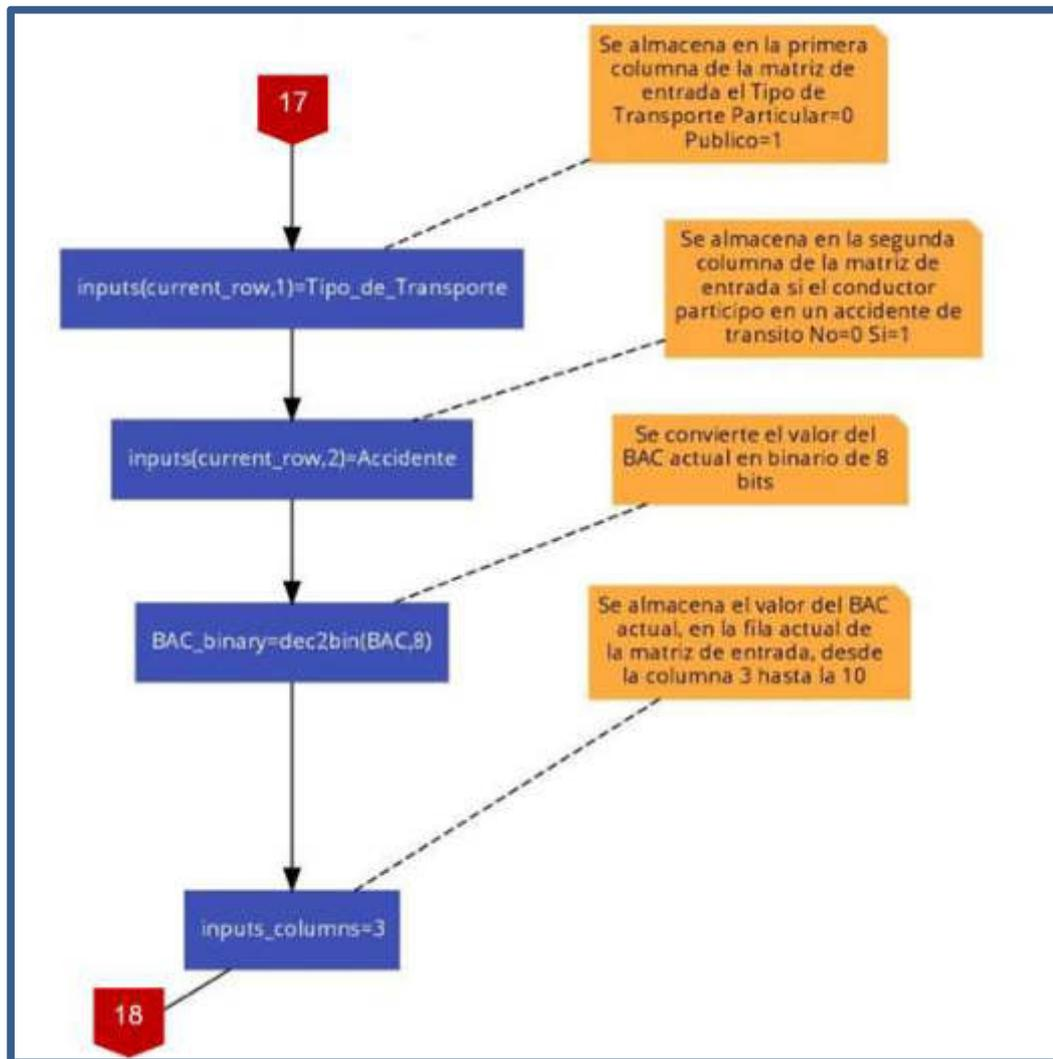
Fig. 130 Diagrama de Flujo del Algoritmo de Generación de entradas y de salidas deseadas de la Red Neuronal– Rama Derecha – Parte 3
