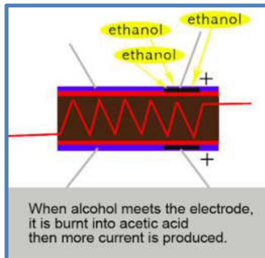
Fig. 24 Partículas de Etanol Haciendo Contacto con el Electrodo
