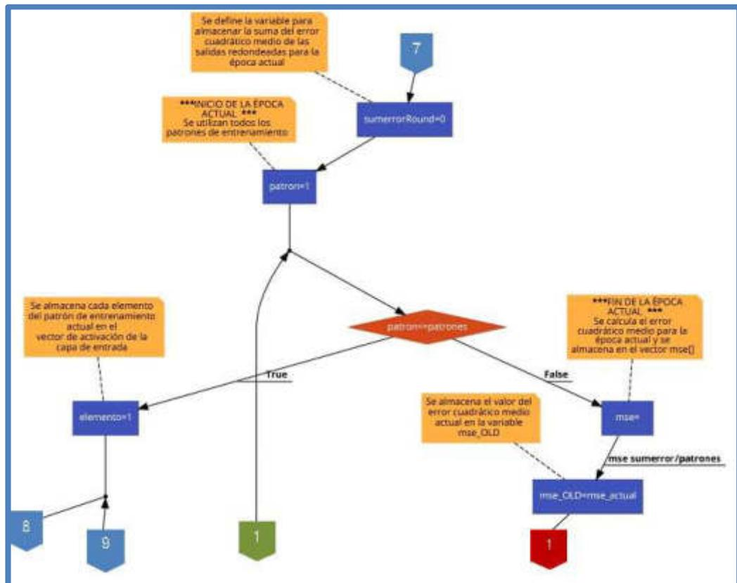
Fig. 145 Diagrama de Flujo del Algoritmo de Retropropagación – Rama Izquierda – Parte 2
