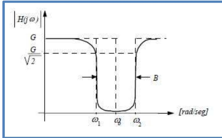
Fig. 16 Respuesta en Frecuencia de un Filtro Rechaza Banda
