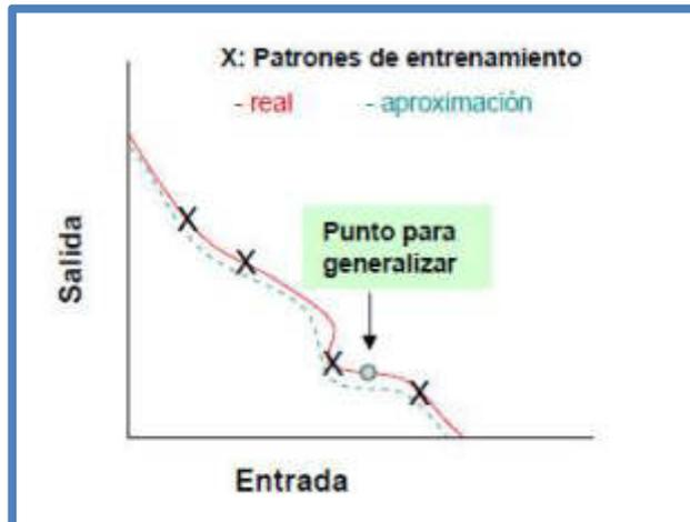
Fig. 48 Buena Capacidad de Generalización
