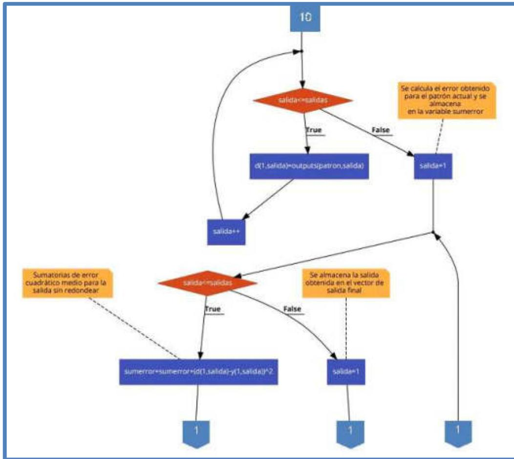
Fig. 147 Diagrama de Flujo del Algoritmo de Retropropagación – Rama Izquierda – Parte 4
