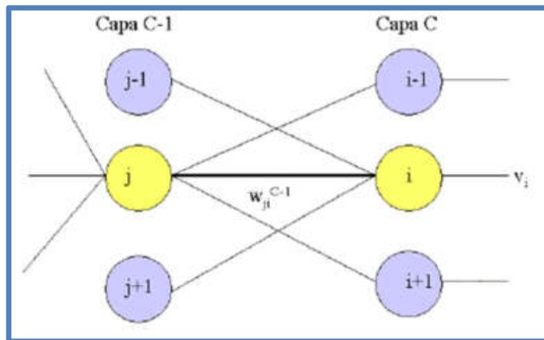
Fig. 45 Gráfico Representativo de la Última Capa de una Red Multicapa
