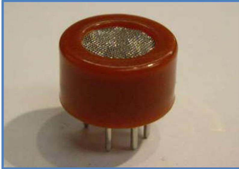
Fig. 19 Sensor de Etanol MQ3
