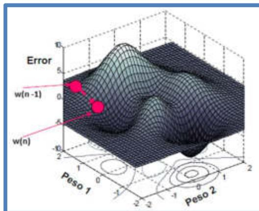
Fig. 44 Gráfico en el Hiperplano de la Adaptación de Pesos y Errores en la Red Neuronal
