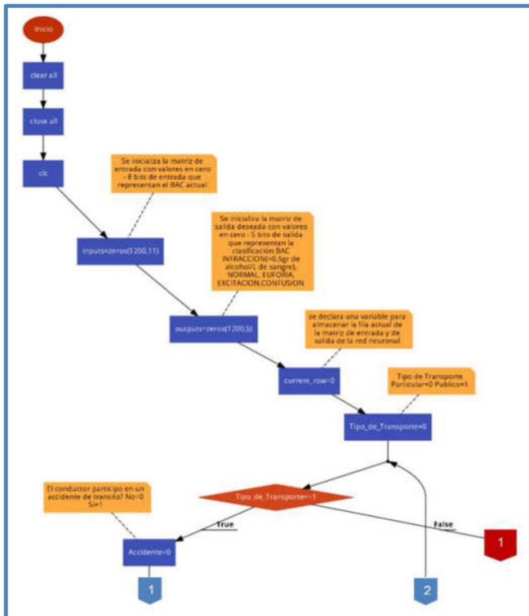
Fig. 121 Diagrama de Flujo del Algoritmo de Generación de entradas y de salidas deseadas de la Red Neuronal– Rama Principal
