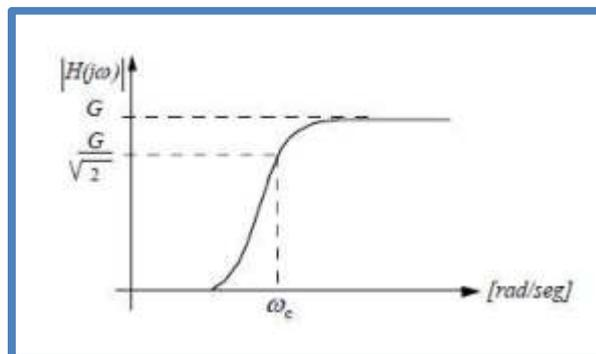
Fig. 14 Respuesta en Frecuencia de un Filtro Pasa Altos
