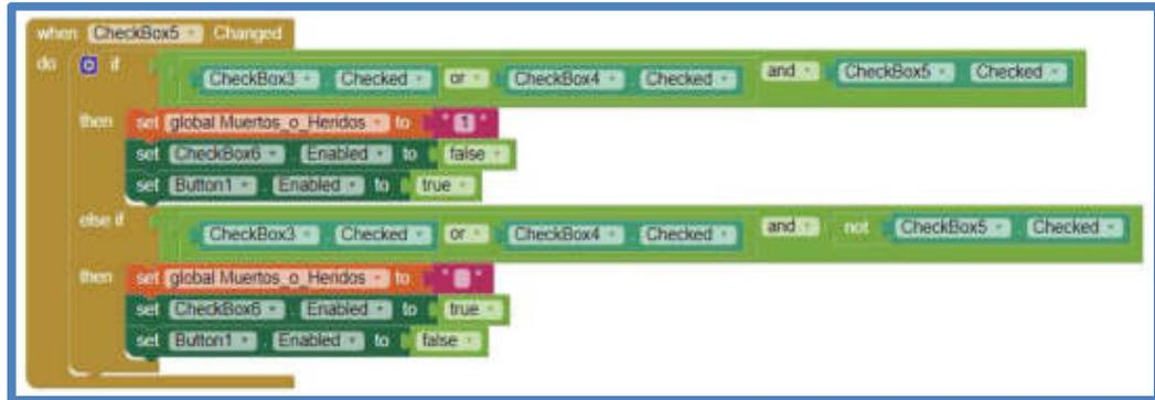
Fig. 107 Aplicación Android - Evento de Cambio de Estado del “CheckBox5” - X11: ¿El Accidente Dejó Muertos o Heridos? - Si=1
