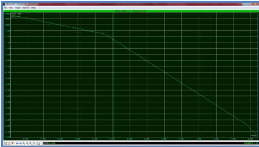
Fig. 36 Respuesta en Frecuencia del Filtro Diseñado a la Frecuencia de Esquina de la Banda de Paso – Aproximadamente  $f_{PB}=6.410\text{KHz}$
