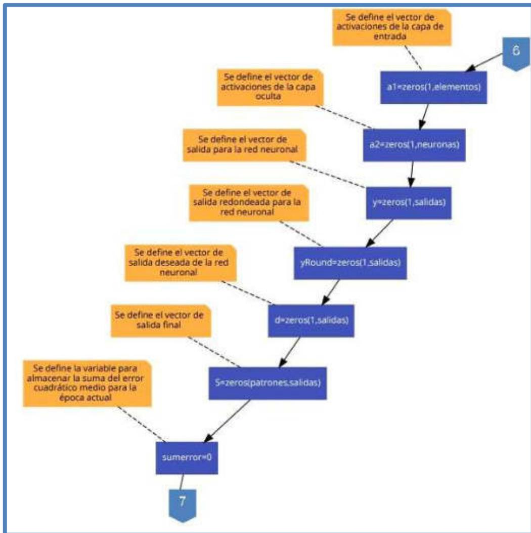
Fig. 144 Diagrama de Flujo del Algoritmo de Retropropagación – Rama Izquierda – Parte 1
