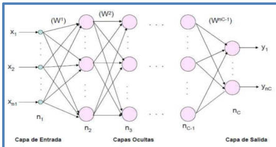
Fig. 39 Arquitectura Perceptron Multicapa
