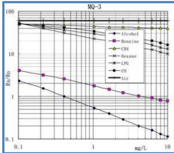
Fig. 26 Características de Sensibilidad del Sensor MQ3
