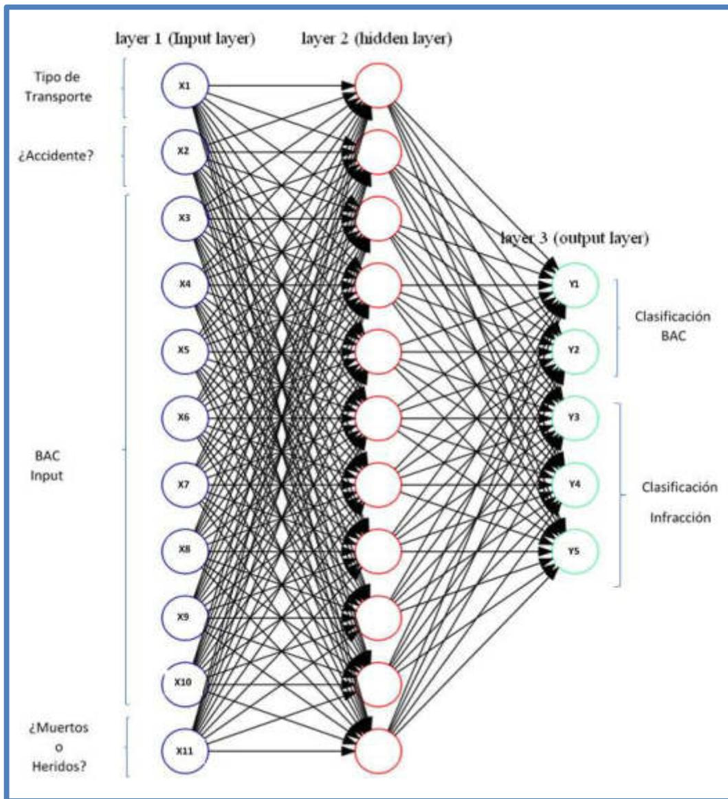
Fig. 52 Topología de La Red Neuronal Diseñada
