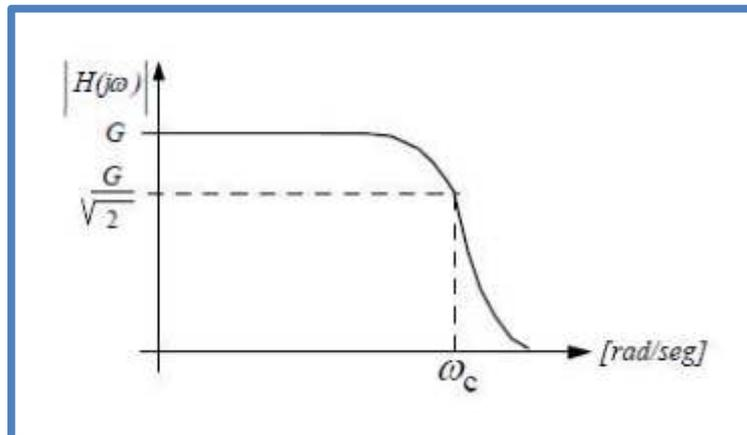
Fig. 13 Respuesta en Frecuencia de un Filtro Pasa Bajos
