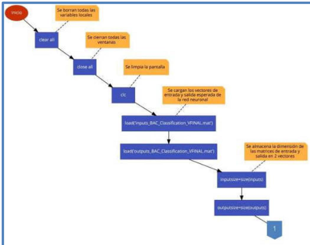
Fig. 138 Diagrama de Flujo del Algoritmo de Retropropagación – Rama Principal – Parte 1
