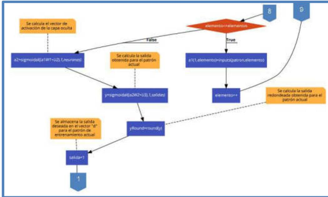
Fig. 146 Diagrama de Flujo del Algoritmo de Retropropagación – Rama Izquierda – Parte 3
