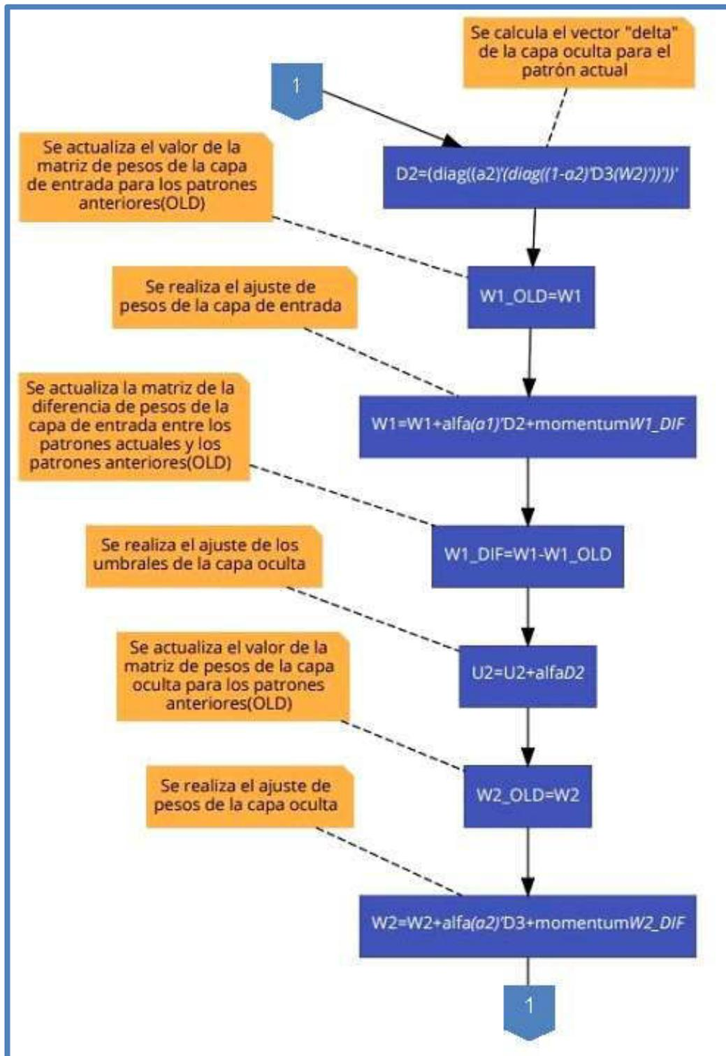
Fig. 149 Diagrama de Flujo del Algoritmo de Retropropagación – Rama Izquierda – Parte 5
