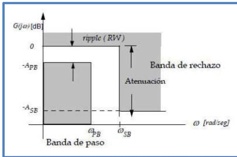
Fig. 32 Ventana de Diseño para un Filtro Pasabajos
