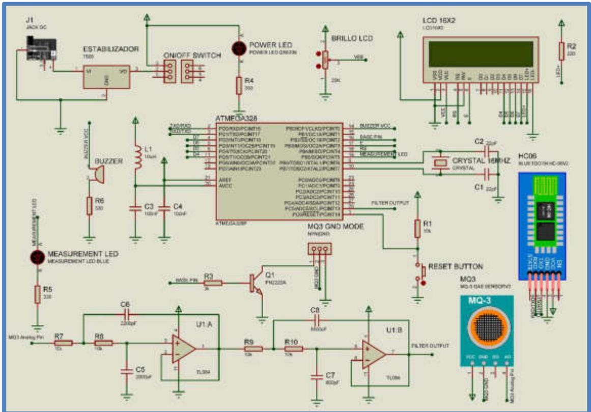
Fig. 163 Diagrama Circuital Completo
