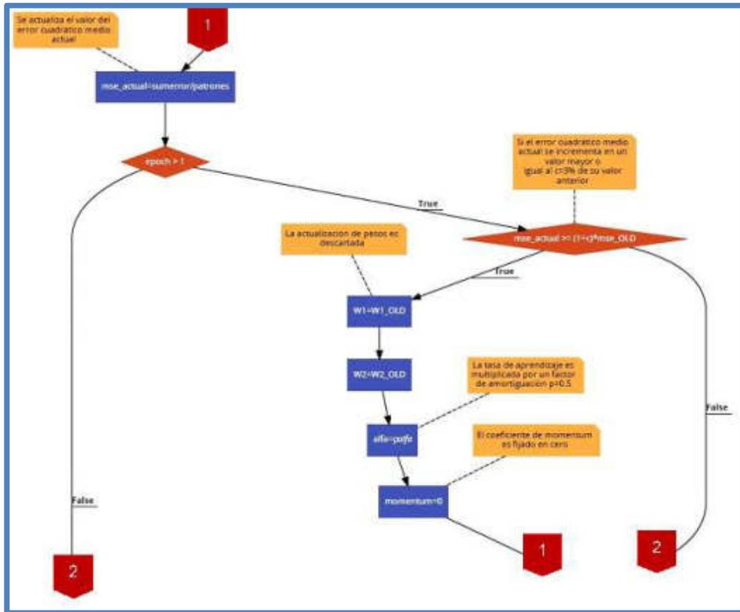
Fig. 151 Diagrama de Flujo del Algoritmo de Retropropagación – Rama Central – Parte 1
