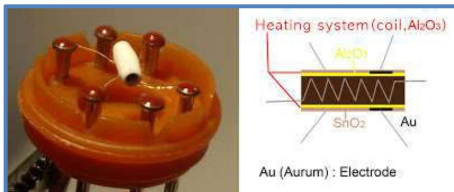
Fig. 21 Imagen Transversal del Sensor MQ3
