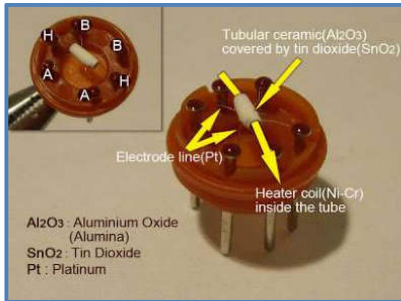
Fig. 20 Sensor de Etanol MQ3 Abierto y Distribución de Pines
