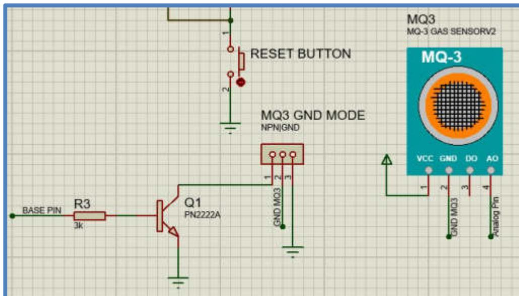
Fig. 67 Conexión entre el Transistor NPN PN2222A y el Sensor MQ3
