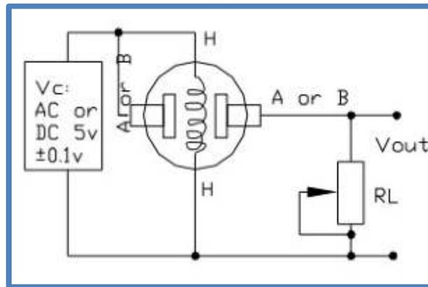
Fig. 25 Circuito de Calibración del Sensor MQ3
