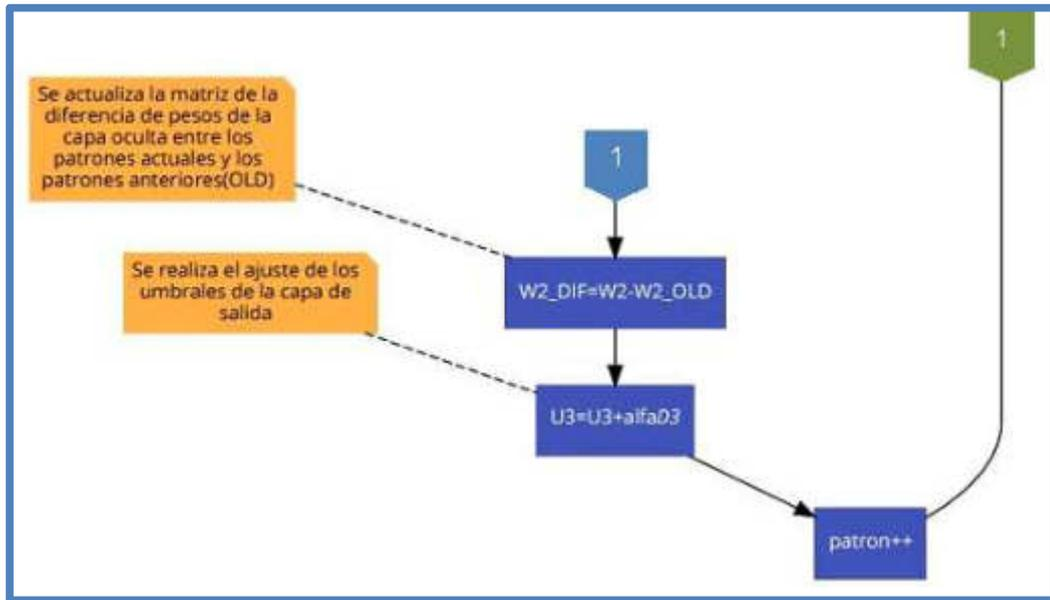
Fig. 150 Diagrama de Flujo del Algoritmo de Retropropagación – Rama Izquierda – Parte 6
