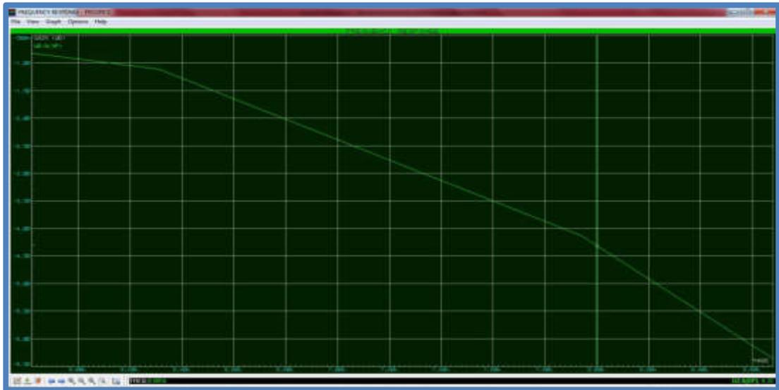
Fig. 37 Respuesta en Frecuencia del Filtro Diseñado a la Frecuencia de Esquina de la Banda de Paso - Aproximadamente  $f_{SB}=8\text{KHz}$
