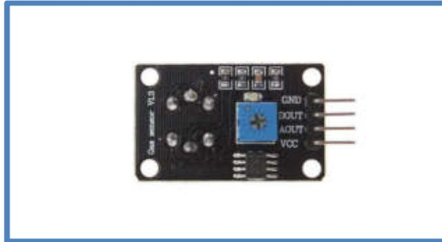
Fig. 28 Módulo del Sensor MQ3 - Vista posterior y Distribución de Pines
