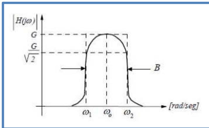
Fig. 15 Respuesta en Frecuencia de un Filtro Pasabanda
