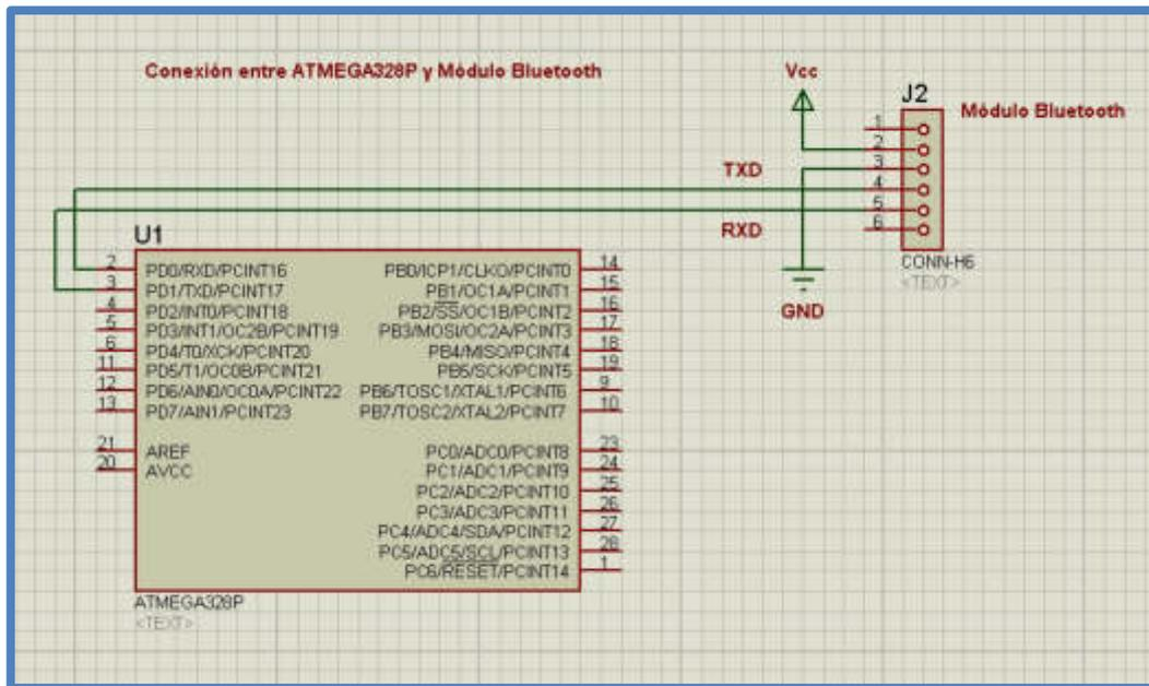
Fig. 58 Conexión entre ATMEGA328P y el Módulo Bluetooth
