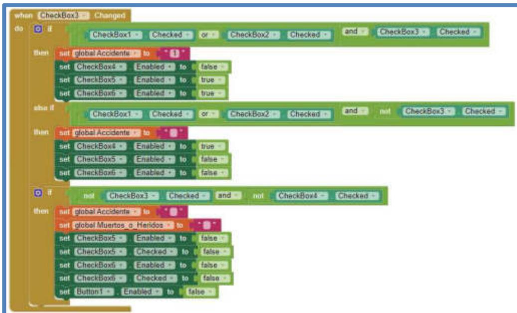
Fig. 105 Aplicación Android - Evento de Cambio de Estado del “CheckBox3” - X2: ¿El Conductor Participó en un Accidente de Tránsito? - Si=1
