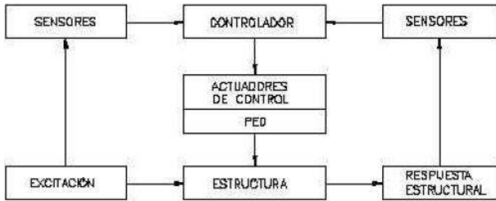
Figura 7: Esquema de cómo funciona un sistema de control semiactivo
