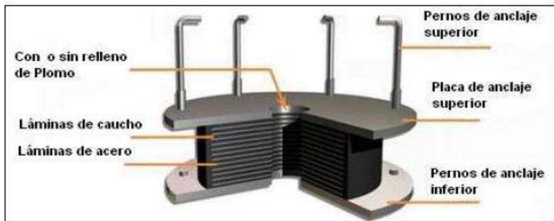
Figura 9: Detalles de un aislador elastomérico.
