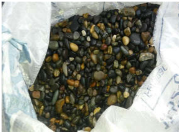
Foto N° 11: Grava de prefiltro usada en el pozo SEV-22
