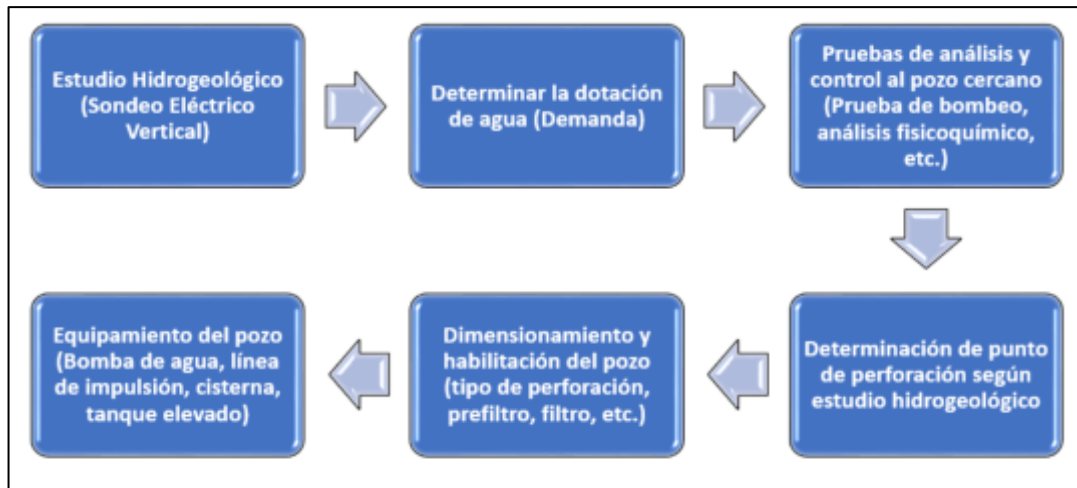
Figura 46. Proceso propuesto para el correcto diseño de un pozo tubular Elaboración: Los autores
