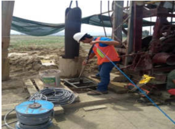
Foto N° 04: Realización de prueba de sondeo vertical al pozo SEV-22
