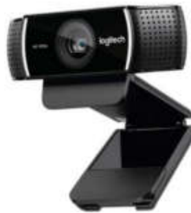
Figura (9). Cámara utilizada para la adquisición de las imágenes de las palmas del personal
