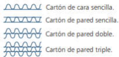
Figura 24 Tipos principales de cartón corrugado
