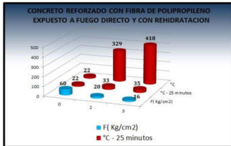
Figura 43: Concreto reforzado con fibra de polipropileno expuesto al fuego directo y con rehidratación.
