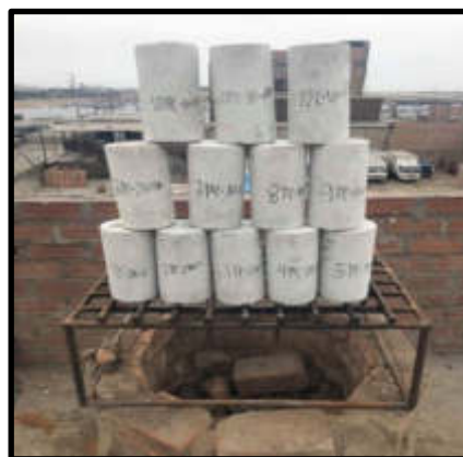
Figura 22: Preparación de los testigos de compresión para el quemado correspondiente
