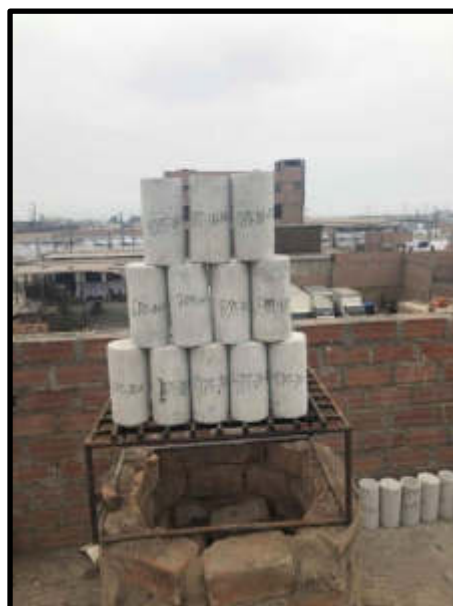
Figura 23: Preparación de los testigos de Tracción para el quemado correspondiente
