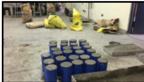
Figura 15: Probetas de Concreto Patrón y Reforzadas
