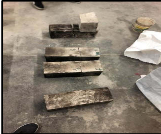
Figura 28: Rotura de vigas para el ensayo de flexión
