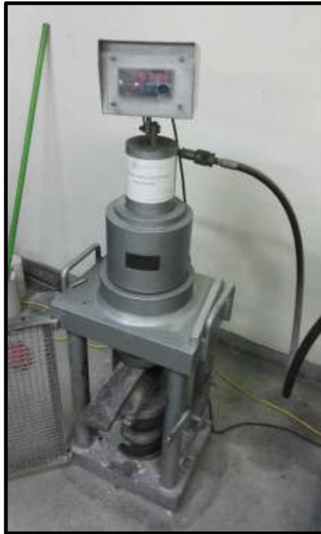
Figura 29 y Figura 30: Rotura de probetas en cada uno de sus ensayos.
