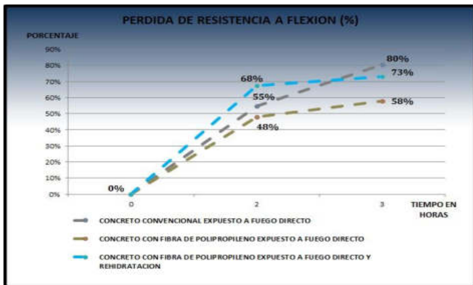
Figura 45: Pérdida de Resistencia F_c (%) Fuente: Propia
