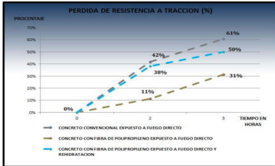
Figura 40: Pérdida de Resistencia F_c (%) Fuente: Propia
