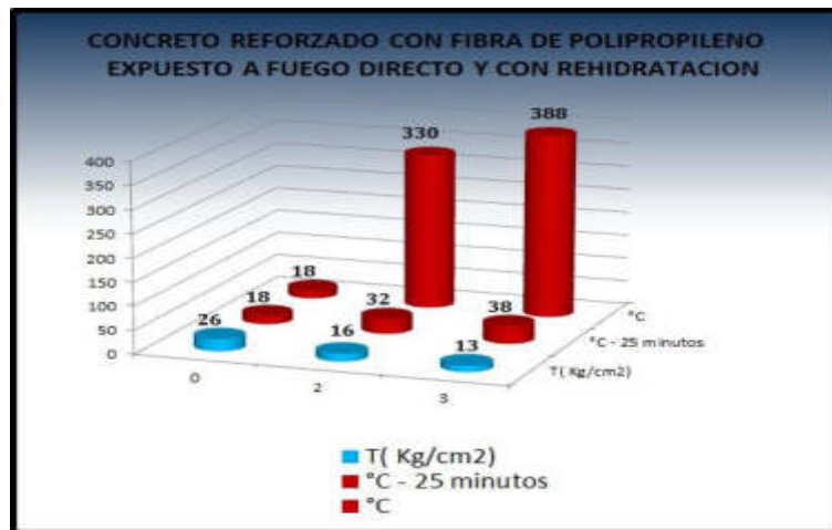
Figura 38: Concreto reforzado con fibra de polipropileno expuesto al fuego directo y con rehidratación. Fuente: Propia
