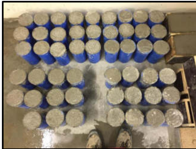
Figura 16: Probetas de Concreto Patrón y Reforzadas
