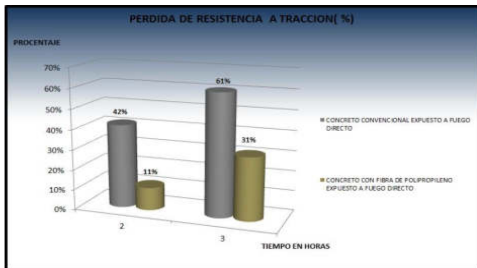
Figura 47: Pérdida de resistencia a tracción del concreto convencional y concreto reforzado con fibra de polipropileno. Fuente: Propia
