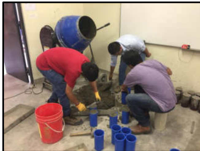
Figura 17: Probetas de Concreto Patrón y Reforzadas
