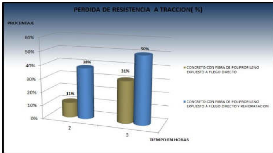
Figura 49: Pérdida de resistencia a tracción del concreto reforzado con fibra de polipropileno expuesto al fuego y al proceso de rehidratación Fuente: Prooia
