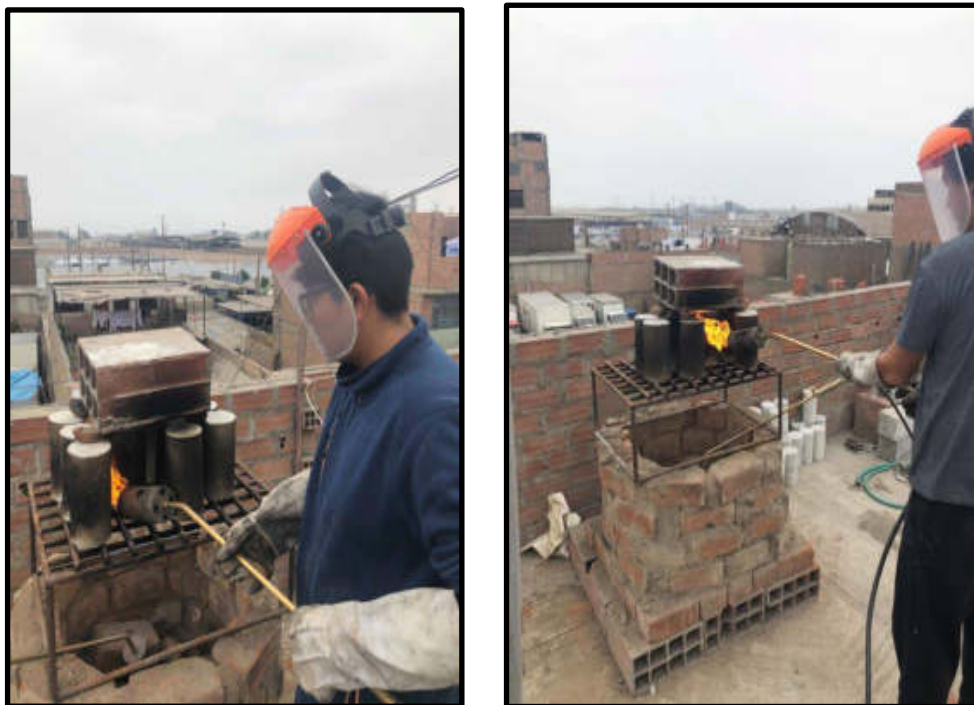
Figura 24 y 25: Quemado de los testigos para sus respectivos ensayos.
