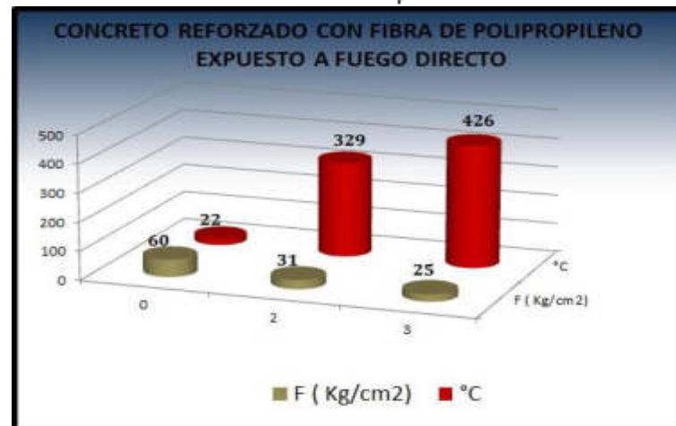
Figura 42: Concreto reforzado con fibra de polipropileno expuesto al fuego directo. Fuente: Propia
