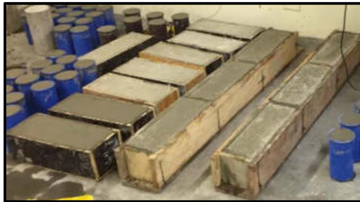
Figura 18: Vigas de Concreto Convencional y Reforzadas
