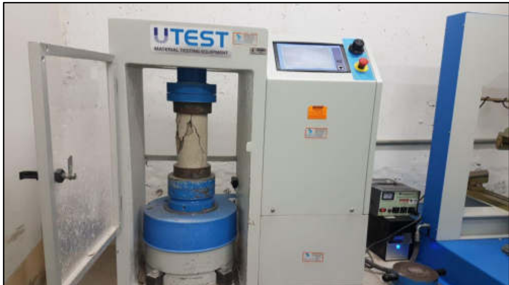
Figura 46. Ensayo de resistencia a la compresión Fuente: Elaborado por los autores
