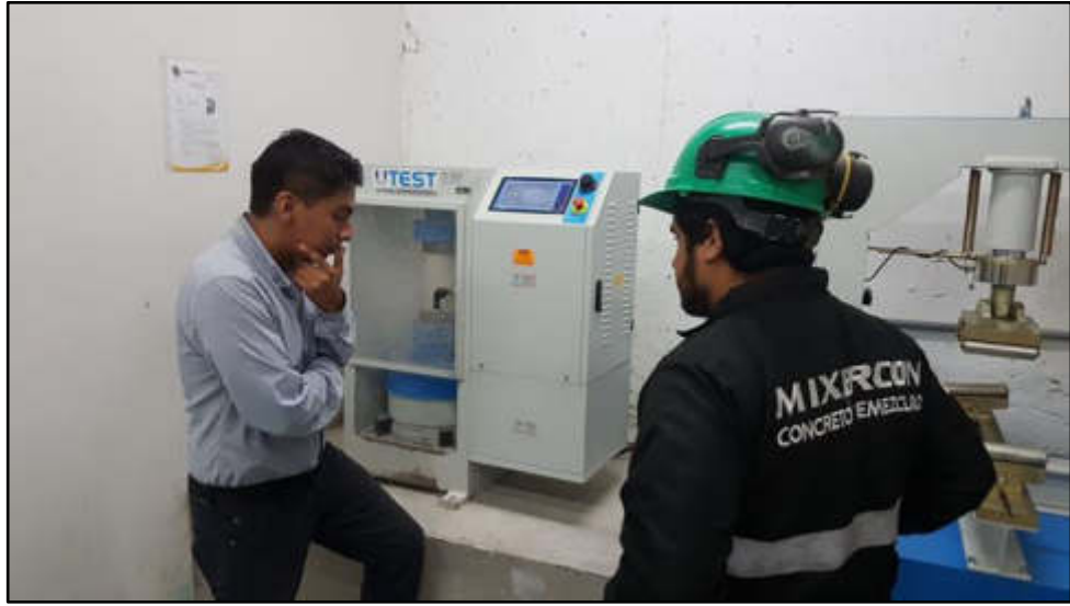
Figura 45. Ensayo de resistencia a la compresión Fuente: Elaborado por los autores
