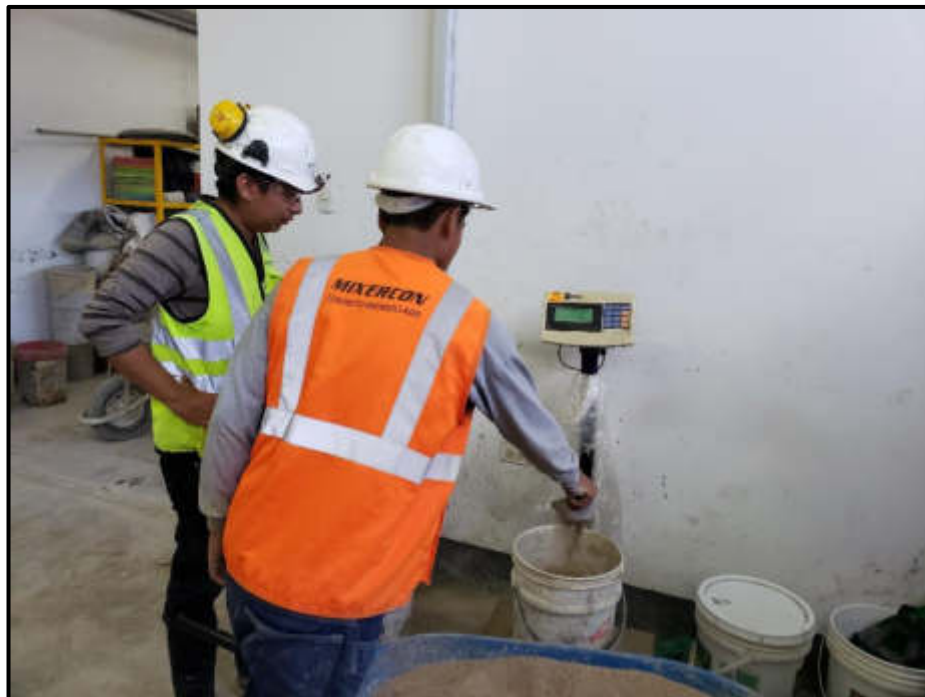
Figura 30. Pesaje de los materiales para diseño de mezcla Fuente: Elaborado por los autores
