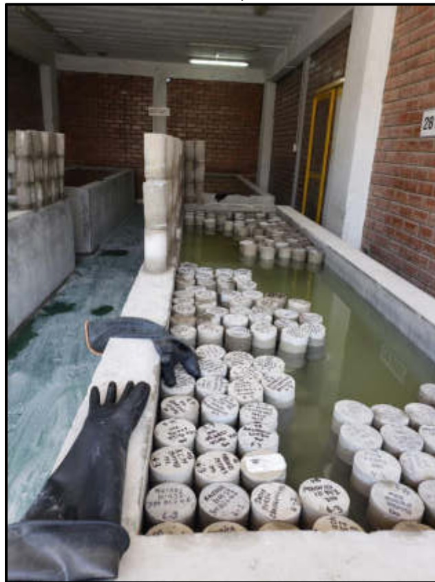
Figura 44. Curado de las probetas para los ensayos Fuente: Elaborado por los autores
