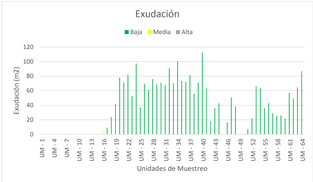
Figura 11. Distribución de “Exudación” en la avenida Los Constructores.
