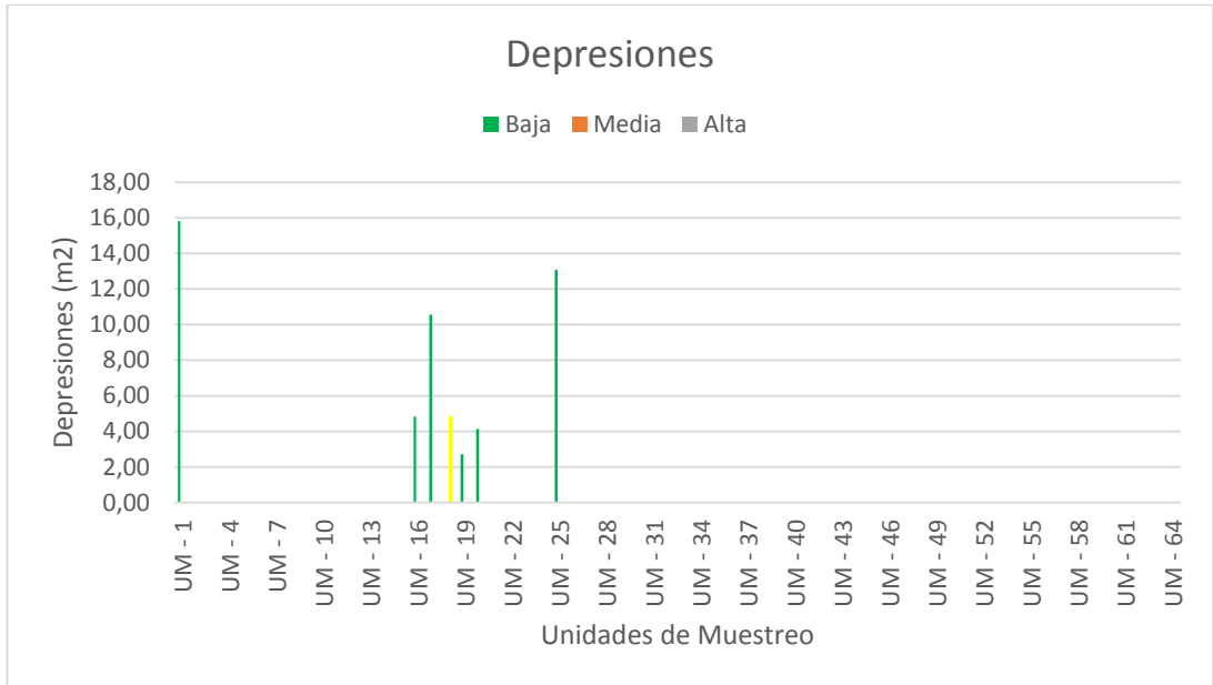
Figura 15. Distribución de “Depresiones” en la avenida Los Constructores.
