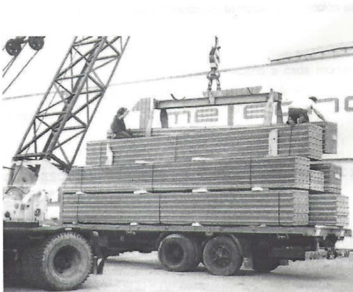
Fotografía 18.- Apilamiento de paneles tipo techo inyectados con Poliuretano sobre plataforma, para traslado al cliente.
