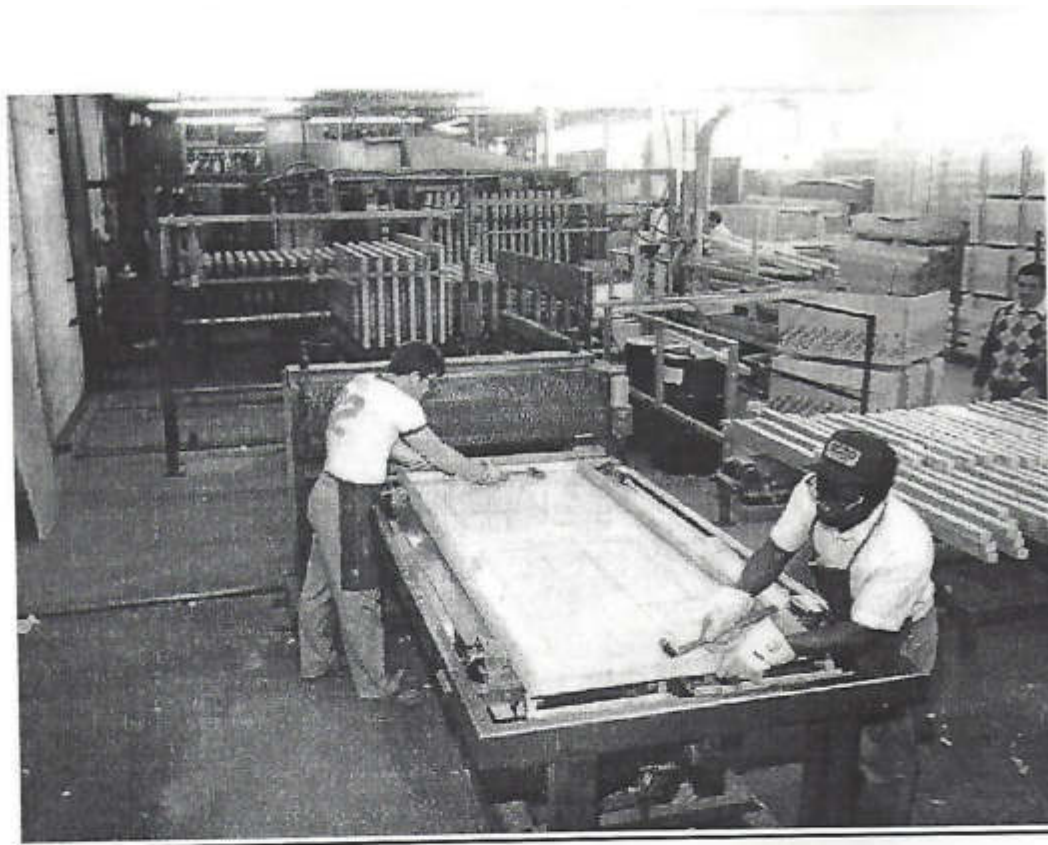
Fotografía 7.- Ejecución del proceso de armado de los paneles para inyectado de Poliuretano.
