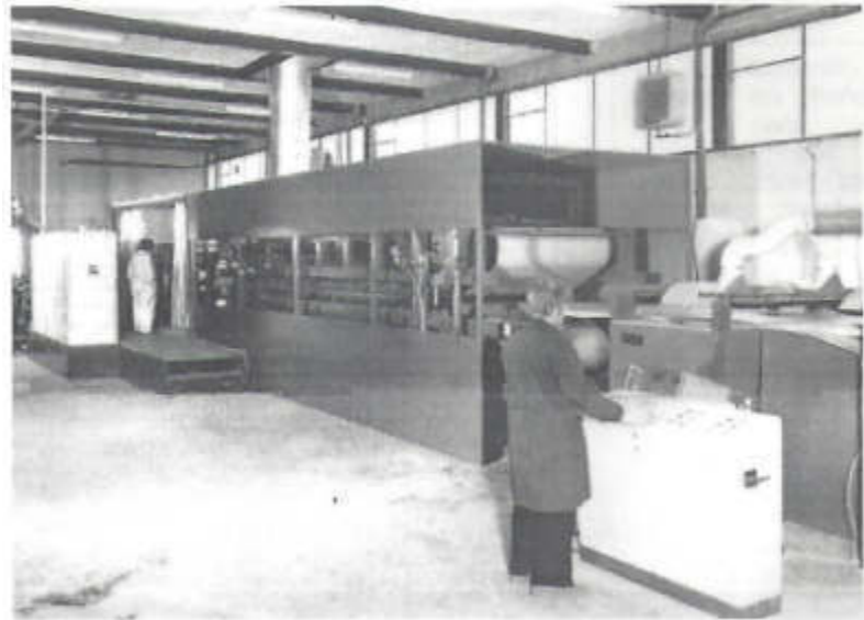
Fotografía N° 9.- Línea de producción de paneles inyectados con Poliuretano.
