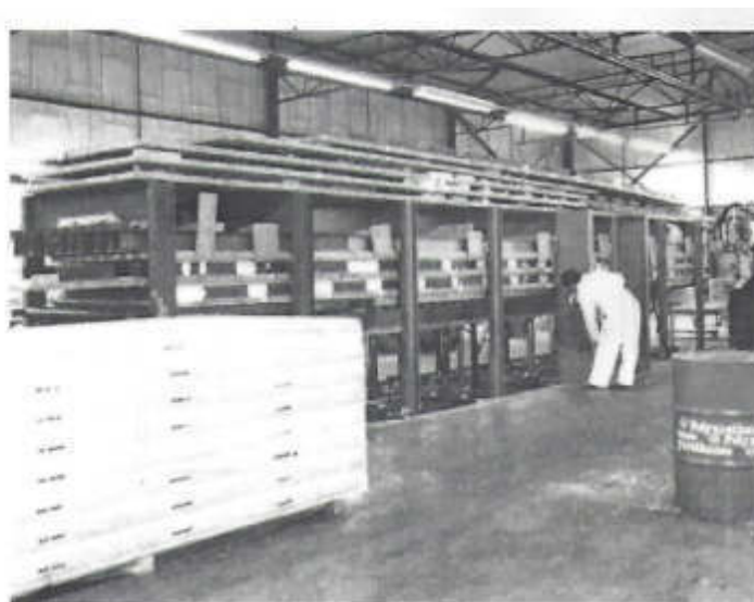
Fotografía N°11.- Línea de producción múltiple de paneles inyectados con Poliuretano y almacenamiento temporal.
