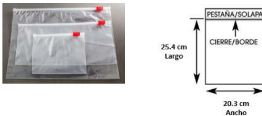
Figura 18 - Modelo del envase de polipropileno para la Quinoa Orgánica Elaboración: Propia
