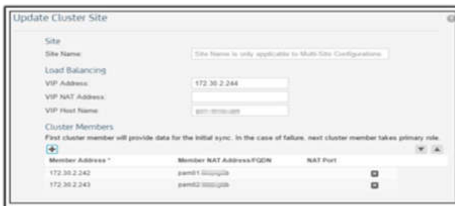
Figura 22: Creación del clúster y el balanceador de carga
