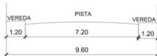
SECCIÓN C - C CALLE CEMENTERIO
