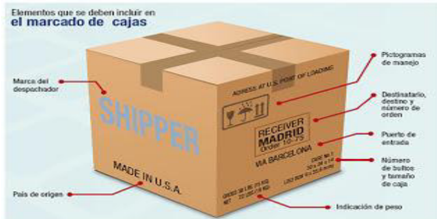
Figura 32: Marcado de caja
