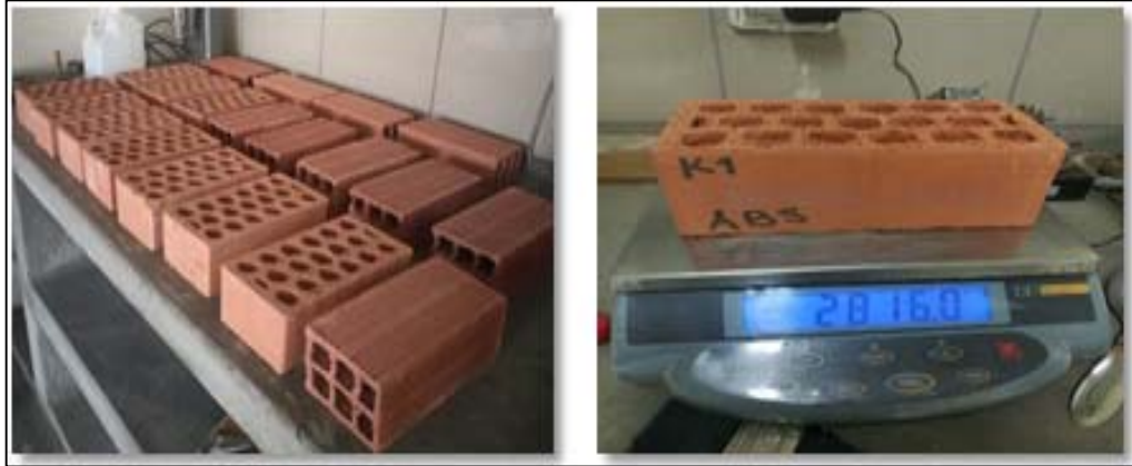
Figura 14. Enfriamiento y pesado de unidades
