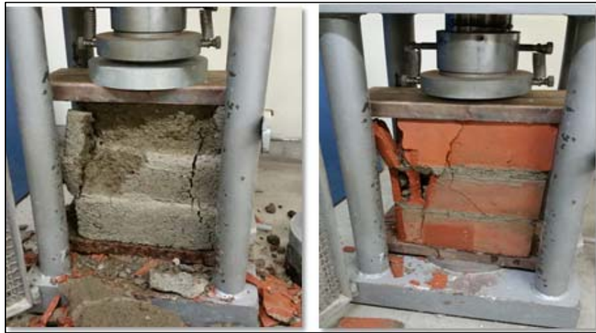
Figura 32. Ensayo de concreción de pilas húmedas
