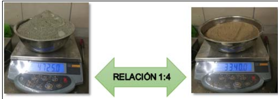
Figura 24. Peso de cemento y arena gruesa
