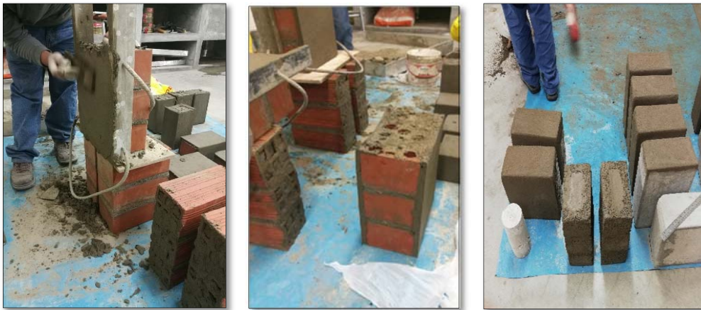
Foto N° 18 Ensayo de compresión muro tarrajeado
