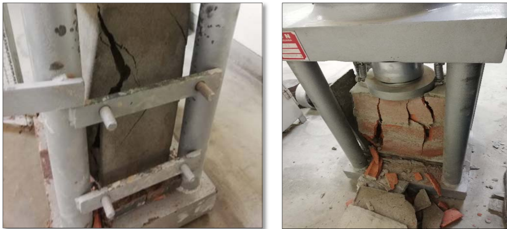
Foto N° 18 Ensayo de compresión muro tarrajeado
