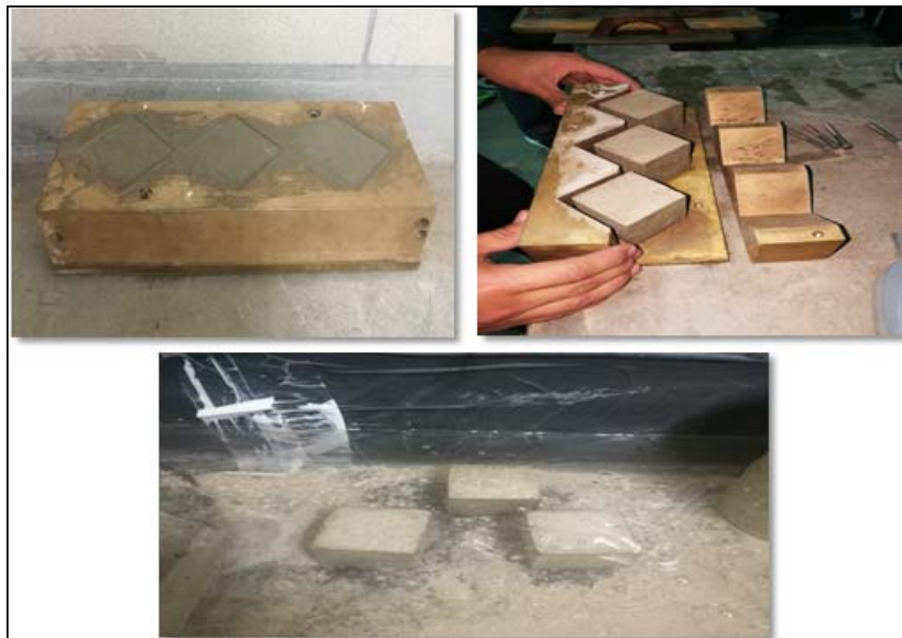
Figura 25. Elaboración de testigos de mortero
