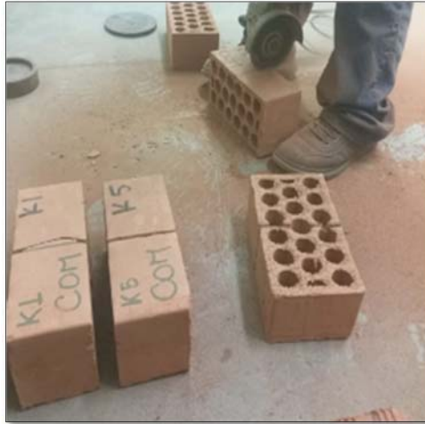
Foto N° 08 inmersión al agua de ½ unidad de albañilería (24 h)
