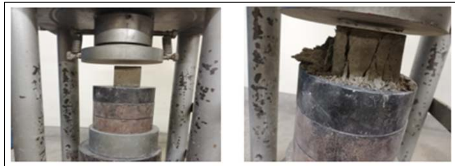
Figura 26. Rotura de muestras de mortero
