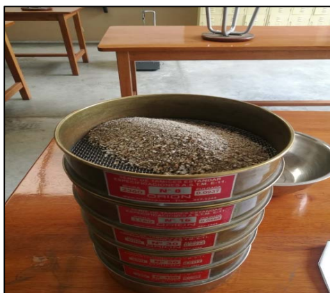
Figura 23. Tamizado de la muestra
