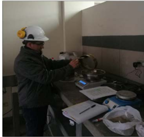
Foto N° 10 Lavado de finos, tamizado y obtención de pesos
