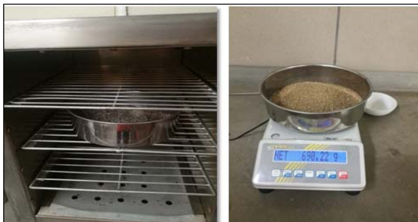
Figura 22. Proceso de secado y pesado de la muestra de arena
