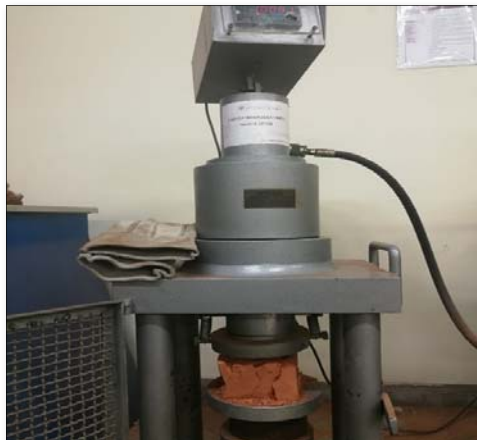
Foto N° 09 Ensayos a la ½ unidad seco y húmedo- Compresión
