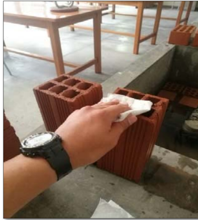
Foto N° 05 Ensayos a la unidad - Succión
