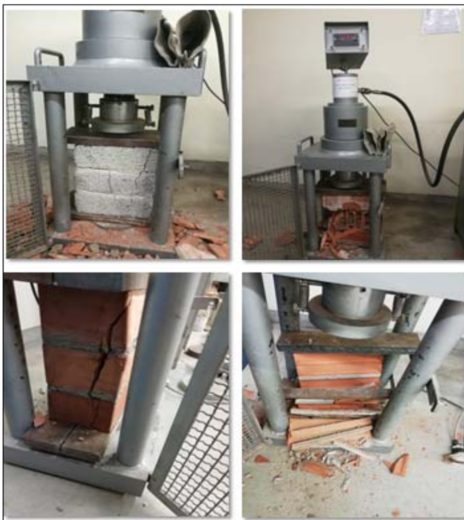
Figura 31. Ensayos de compresión de pilas secas
