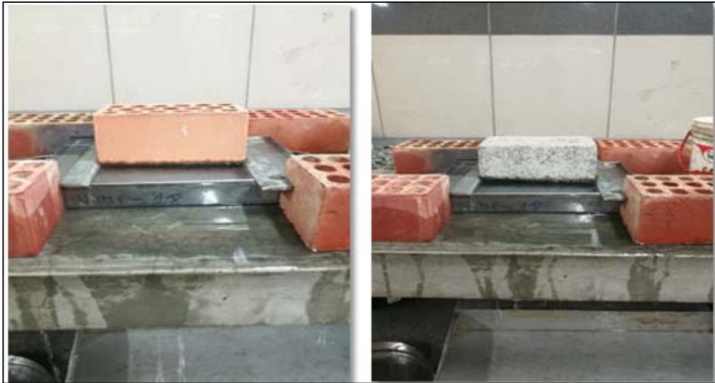
Figura 18. Ensayo de succión
