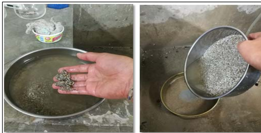
Figura 21. Lavado de la muestra de arena gruesa
