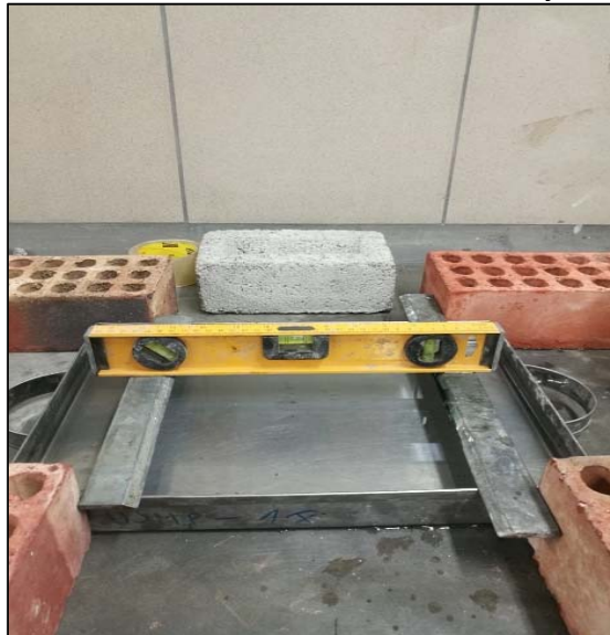
Figura 17. Verificación del nivel de la bandeja
