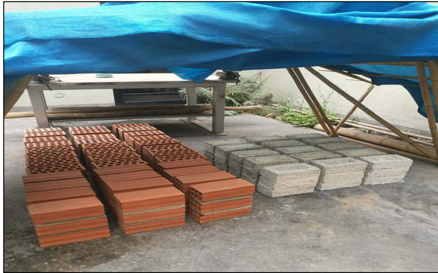
Figura 29. Proceso de curado de pilas
