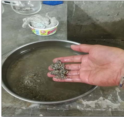
Foto N° 10 Lavado de finos, tamizado y obtención de pesos
