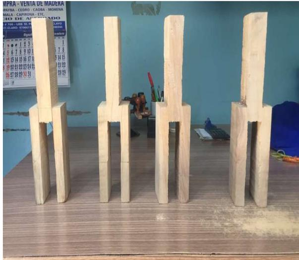
Foto 13: Probetas 2cm x 7cm x 2lados para ensayo de corte.
