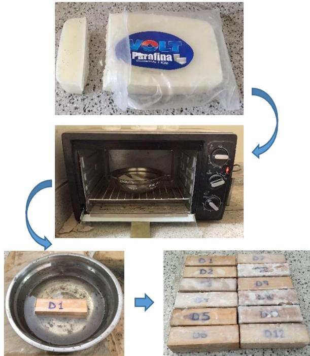
Foto 9: Proceso de parafinado en estado seco, para hallar el volumen seco del horno (VSH).
