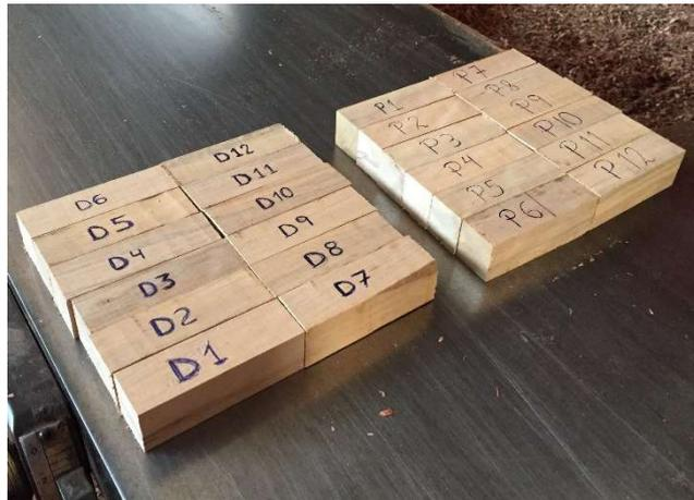
Foto 8: Probetas de 3cm x 3cm x10 cm para ensayo de contenido de humedad (PN°) y densidad de la madera (DN°).
