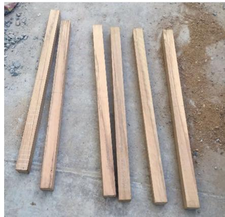
Foto 16: Probetas de madera 5cm x 5cm x 76 cm para ensayo de flexión.
