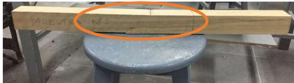
Foto 18: Muestras de madera, luego de haber sido ensayadas por corte paralela a la fibra
