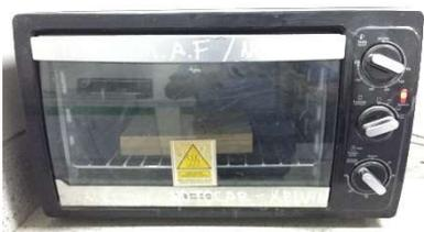
Foto 3: Hornos del laboratorio de la Universidad Señor de Sipán – Chiclayo, para ensayo de contenido de humedad y densidad de la madera.
