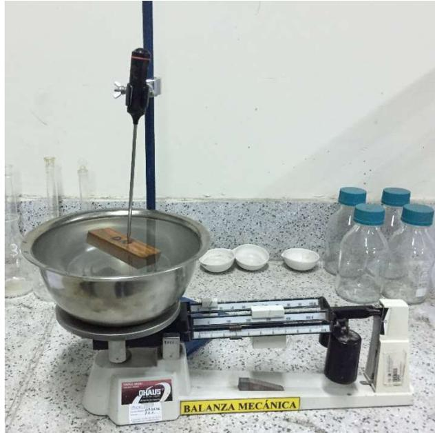
Foto 5: Adaptación de equipos para ensayo de densidad de la madera.
