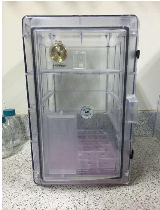
Foto 6: Desecador para enfriar las probetas que estaban en el horno.
