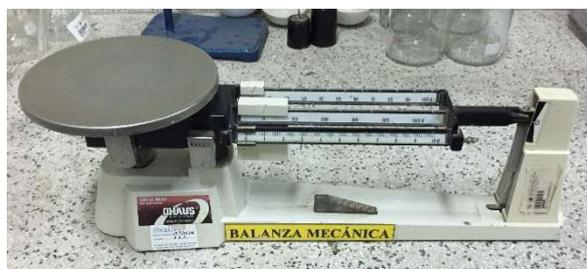
Foto 4: Balanza Eléctrica y Mecánica de la Universidad Señor de Sipán – Chiclayo, para ensayo de contenido de humedad y densidad de la madera.
