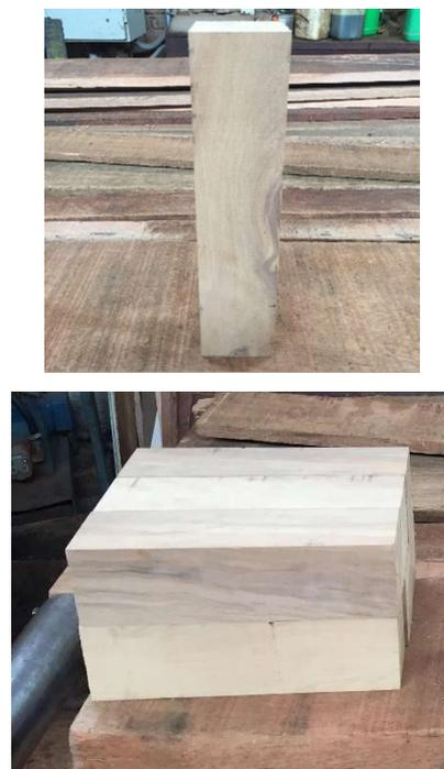
Foto 10: Probetas de 7cm x 7cm x 30cm para ensayo de compresión.
