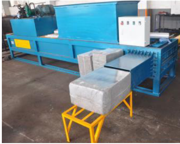
Figura 32: Prensadora y envasadora de hojas de Stevia Rebaudiana. Fuente: Sinopec International (Group) Limited
