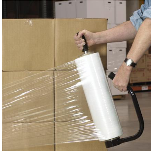
Figura 27: Procedimiento de colocación de stretch film
