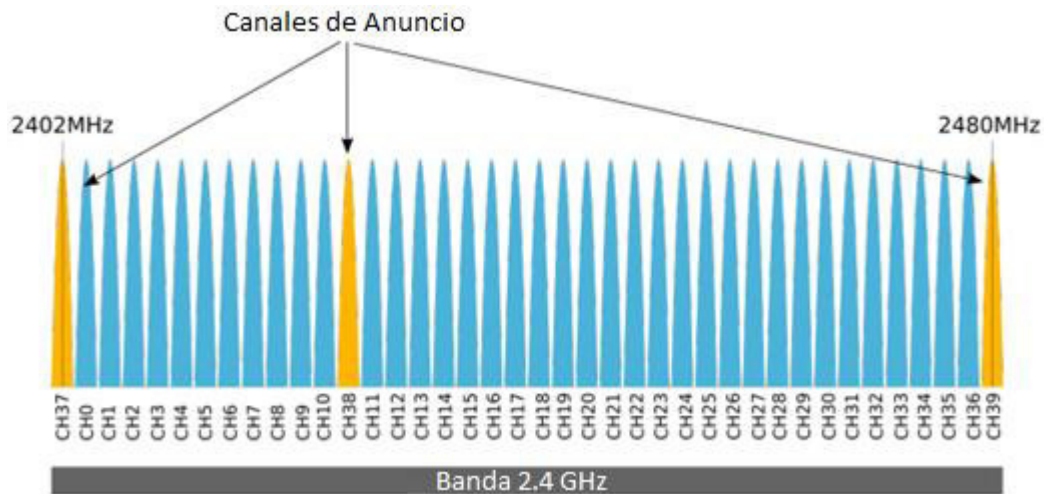
Figura 1 Distribución de canales en BLE.
