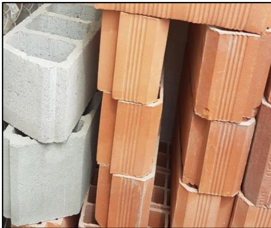
Figura 9. Bovedilla de concreto y arcilla. Elaboración: los autores
