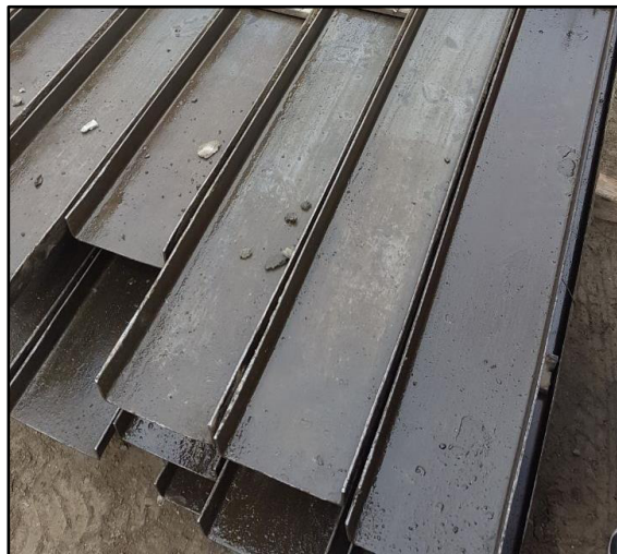
Figura 15. Moldes de Vigueta Elaboración: los autores
