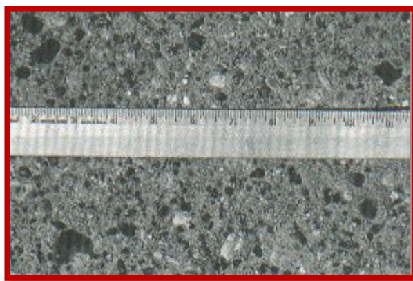
Figura 87: Pulimiento de agregados
