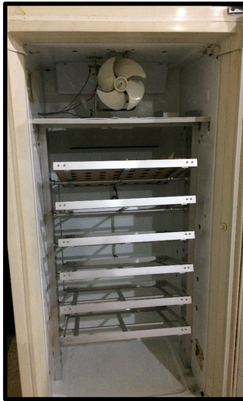
Figura 3.14. Estructura interna terminada e integrada al prototipo de incubación.
