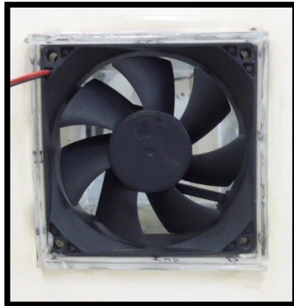
Figura2.10 Ventilador de oxigenación Fuente: los autores
