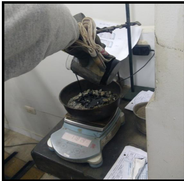
Figura 37: Mezcla del PEN 60/70 y Agregados
