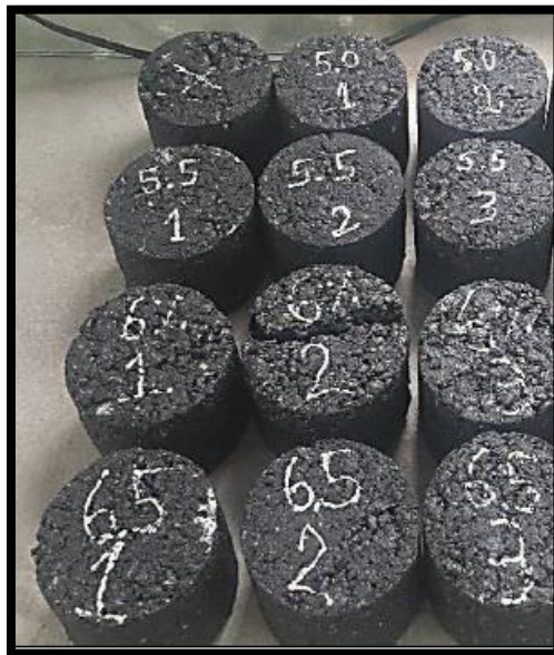
Figura 18: Probetas Marshall de Mezcla Asfáltica Convencional con diferentes Contenido de Asfalto
