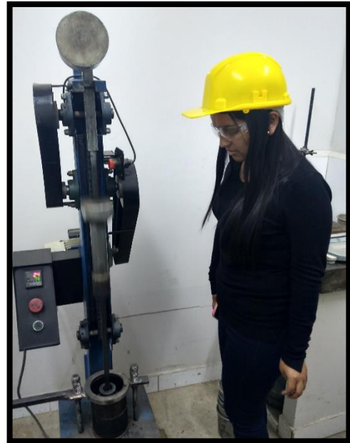
Figura 38: Compactación de briqueta
