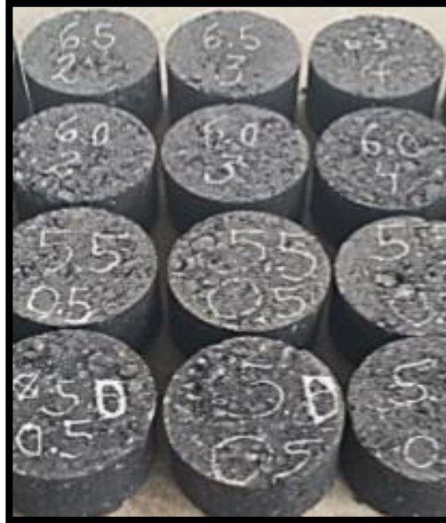
Figura 24: Probetas Marshall de Mezcla Asfáltica Modificada con Diferente Contenido de Asfalto
