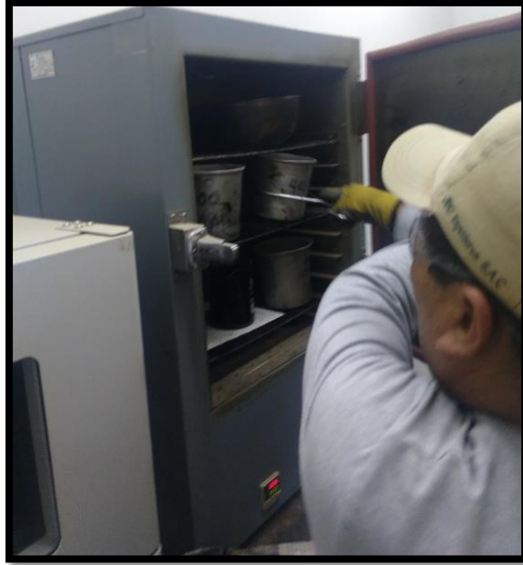
Figura 36: Agregados en el horno a una Temperatura de 150° C
