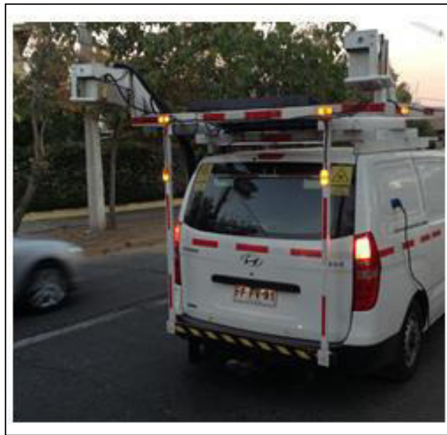
Figura 34. Laser Crack Measurement System (Fuente: Elaboración Propia)
