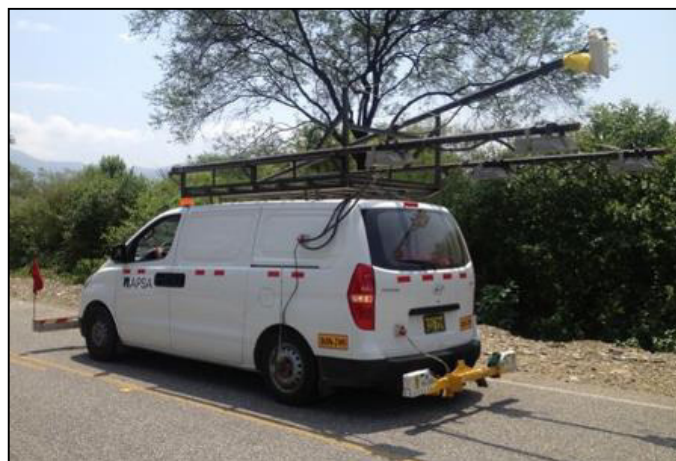
Figura 23. Vehículo y Pave Inspect utilizado para captura de datos. (Fuente: Elaboración Propia)
