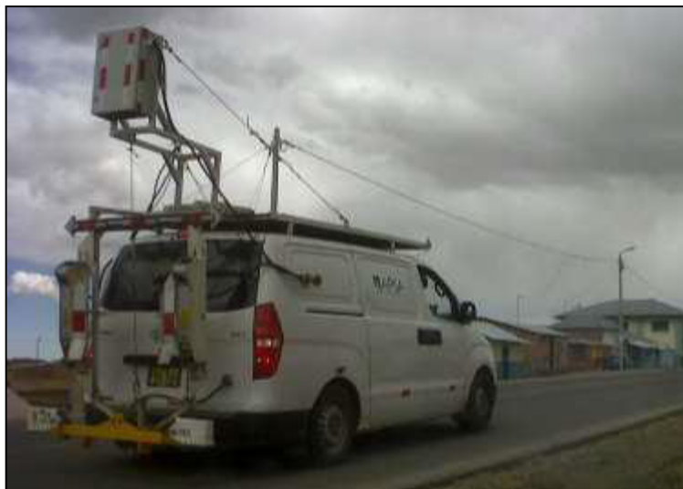
Figura 35. Pave Inspect Lineal (Fuente: Elaboración Propia)
