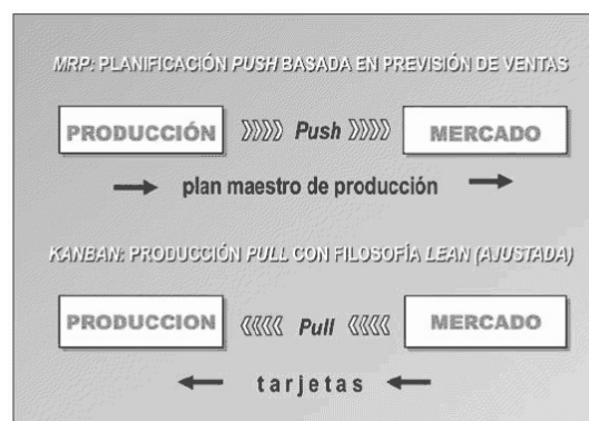
Figura 9. Planificación con filosofía push y pull Fuente: Cuatrecasas Arbós, L. (2012)
