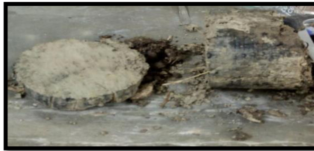
Figura 36: Muestra inalterada llevada al laboratorio
