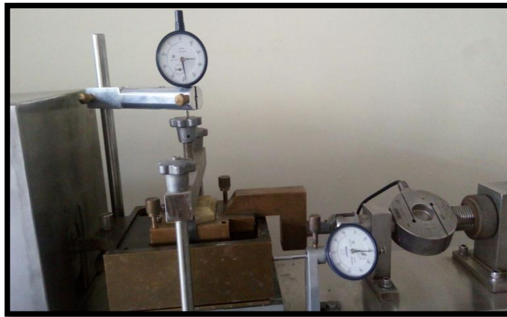
Figura 40: colocación de la muestra en la máquina de corte.
