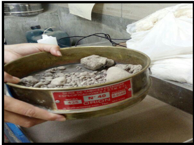
Figura 21: muestra pasada por el tamiz N°40
