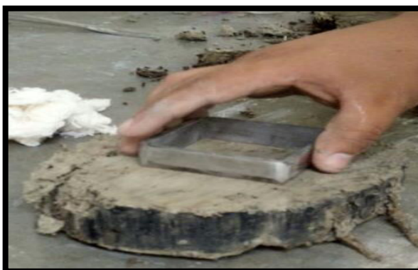
Figura 39: extracción de la muestra inalterada con la ayuda de anillos
