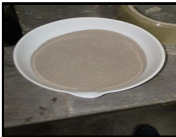
Figura 22: muestra pasada por el tamiz N°40
