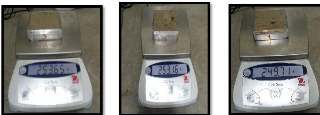
Figura 38: peso de los anillos con la muestra inalterada.
