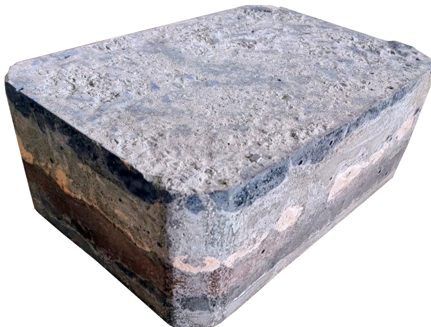
Figura N° 47: Prototipo de concreto con 4 tonos de anilinas
