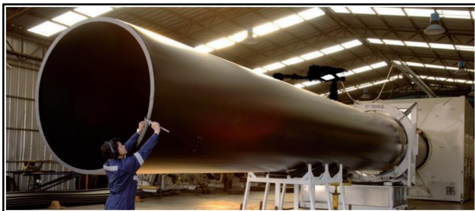
Figura 32. Tubería HDPE en Planta de Fabricación
