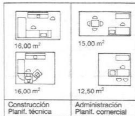
Ejemplos de puestos de trabajo con máquinas de oficina en el extremo de la mesa
