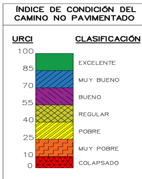
Figura 8: Escala URCI y clasificación de condición Fuente: TM 5-626 Unsurfaced Road Maintenance Management
