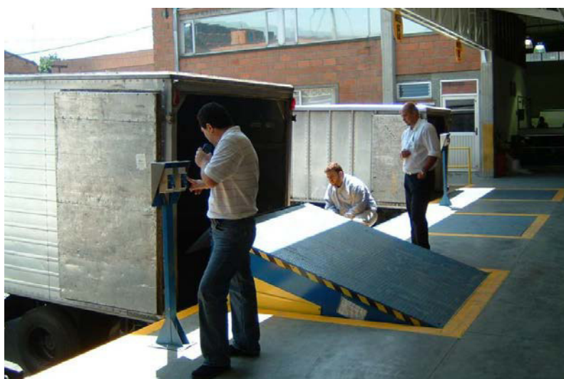
Figura 4. Sistema de carga y descarga en el muelle.
