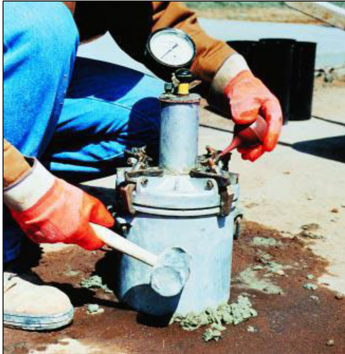
Figura 31. Medidor de presión de aire
