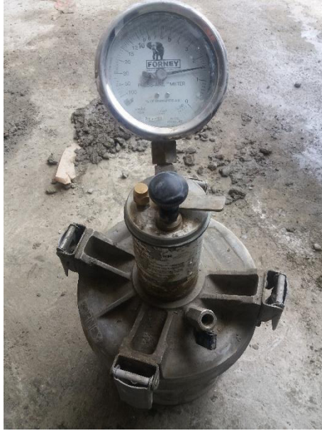
Figura 69. Medición del contenido de aire del concreto Elaboración: los autores
