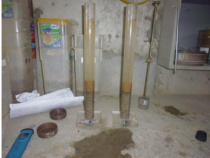
Figura 61. Ensayo para la determinación del equivalente arena Elaboración: los autores
