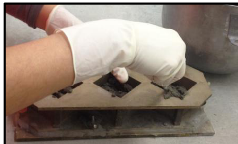
Figura 15. Moldeo de especímenes Fuente: Laboratorio Mixercon
