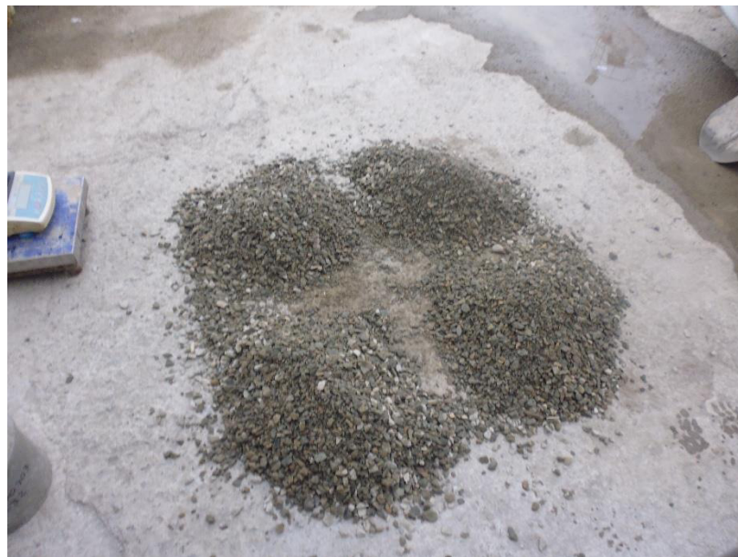
Figura 58. Cuarteo del agregado grueso para la ejecución de ensayos Elaboración: los autores
