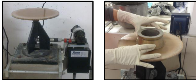
Figura 10. Equipo para Ensayo de Fluidez Fuente: Laboratorio Mixercon
