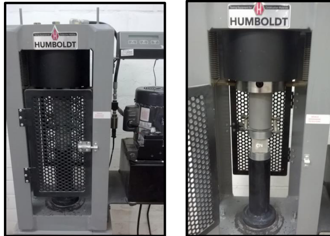
Figura 18. Prensa de Compresión Marca Humboldt Fuente: Laboratorio Mixercon
