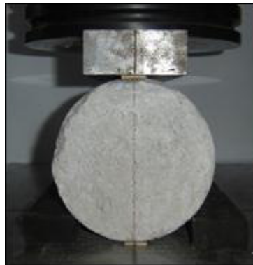
Figura 36. Ensayo de resistencia a la compresión diametral
