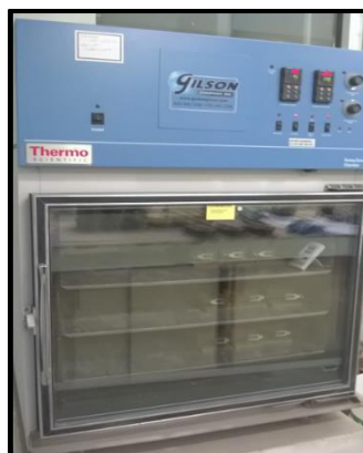
Figura 17. Cámara de Curado
