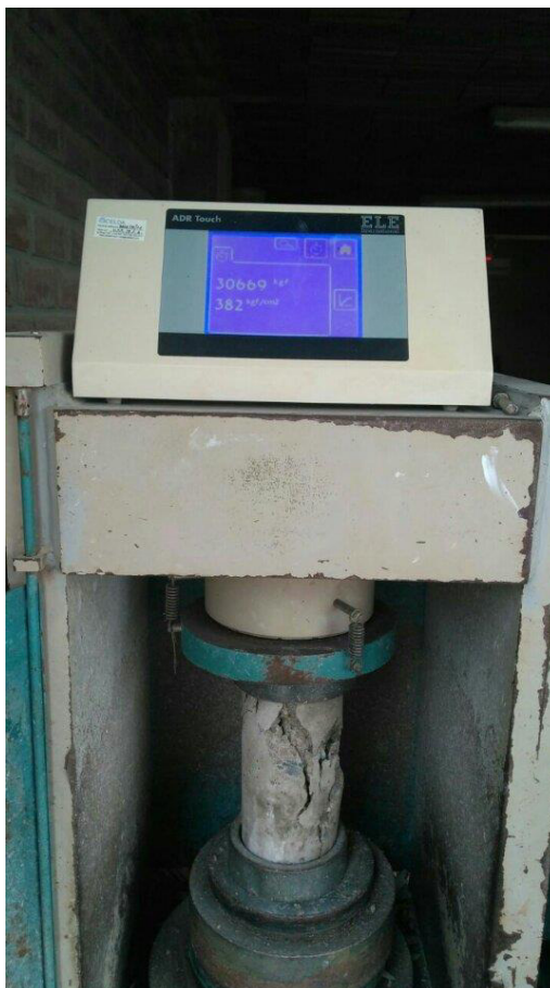
Figura 75. Fractura de la probeta por compresión axial Elaboración: los autores
