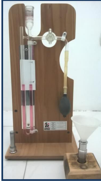
Figura 8. Aparato de Blaine Fuente: Laboratorio Mixercon
