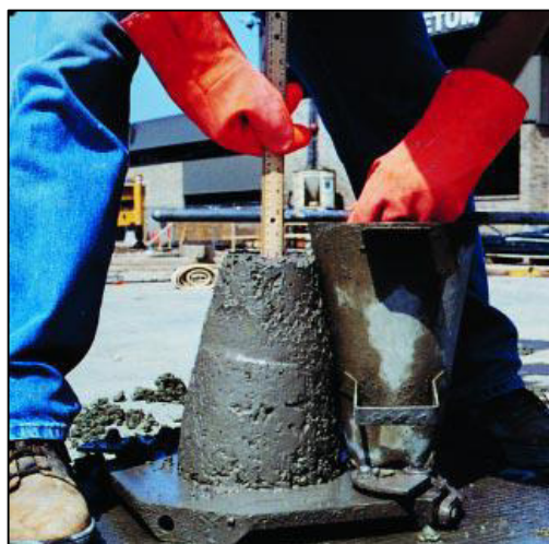
Figura 30. Ensayo del asentamiento Fuente: PCA Diseño y Control de Mezclas de Concreto (2004)
