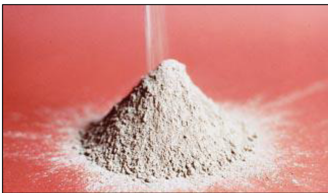
Figura 1. Muestra de Cemento Portland
