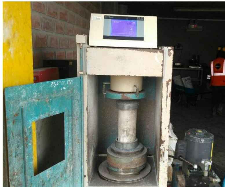
Figura 74. Ensayos de resistencia a la compresión Elaboración: los autores
