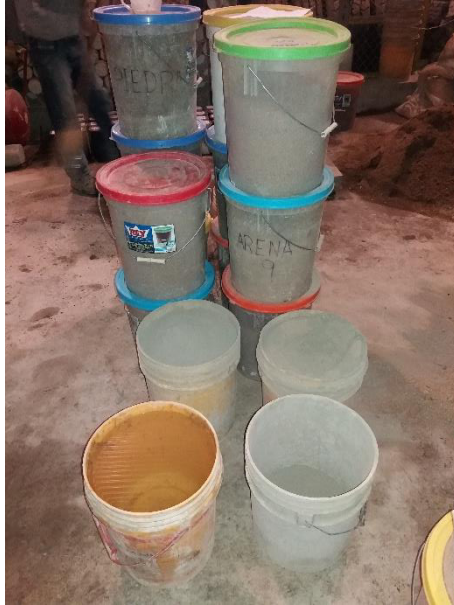
Figura 65. Materiales pesados para el diseño con cemento “Nacional” y con cemento “Sol” Elaboración: los autores
