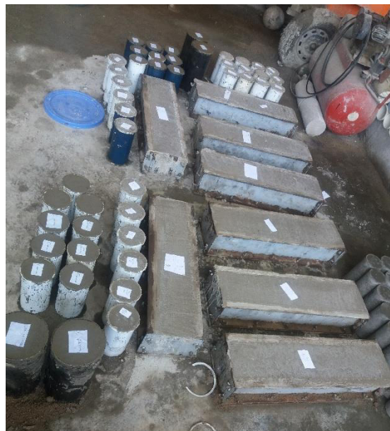
Figura 72. Identificación de las muestras para la medición de las propiedades mecánicas Elaboración: los autores
