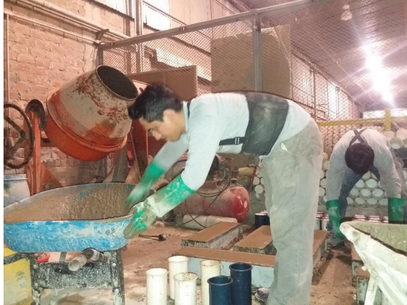
Figura 71. Elaboración de las probetas para ensayos de resistencia la compresión Elaboración: los autores
