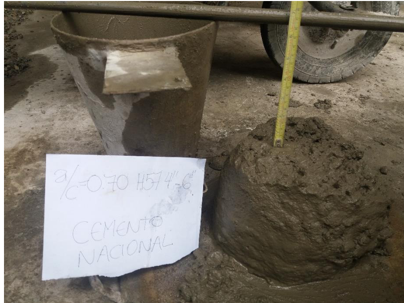
Figura 67. Medición de la consistencia del concreto fabricado con cemento "Nacional" Elaboración: los autores
