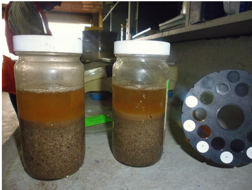
Figura 62. Ensayo para la determinación de las impurezas orgánicas del agregado fino Elaboración: los autores
