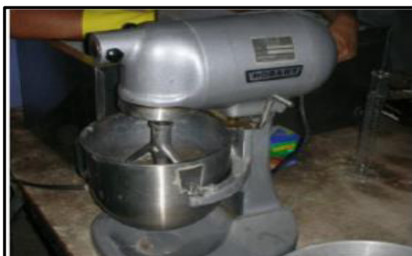
Figura 9. Preparación de Mezcla de mortero
