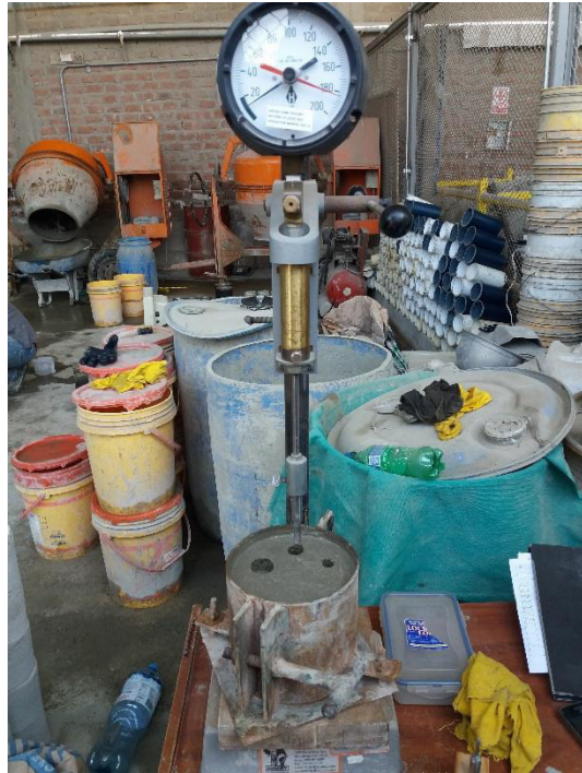
Figura 73. Ensayos de fragua del concreto Elaboración: los autores
