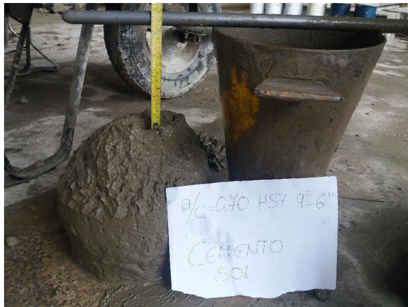
Figura 68. Medición de la consistencia del concreto fabricado con cemento "Sol" Elaboración: los autores
