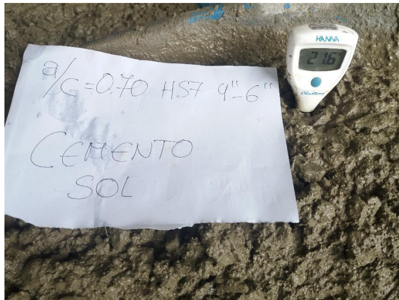
Figura 70. Medición de la temperatura del concreto Elaboración: los autores
