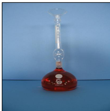
Figura 23. Frasco Le Chatelier con gasolina
