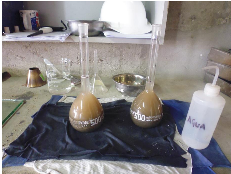
Figura 60. Ensayo para la determinación del peso específico y absorción del agregado fino Elaboración: los autores
