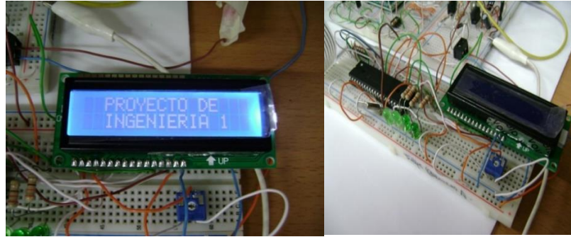
Figura 33 - Montaje en protoboard de la interfaz de control basado en el microcontrolador
