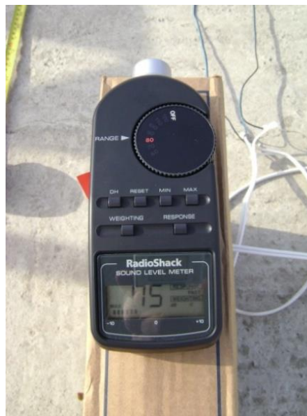
Figura 15 - Medición del nivel de sonido mediante un Decibelímetro
